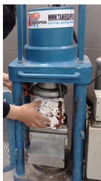
Figure 10. Prueba de compresión
