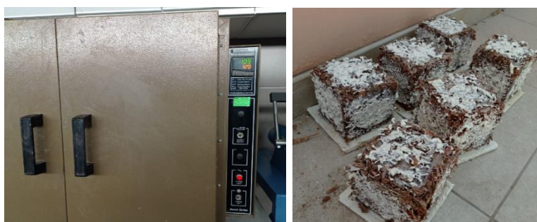
Figure 8. Bloques secados al horno a una temperatura de 109 °C
