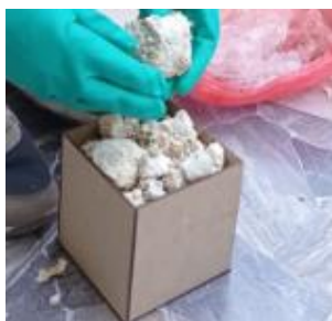
Figure 3, Trituración manual del micelio
