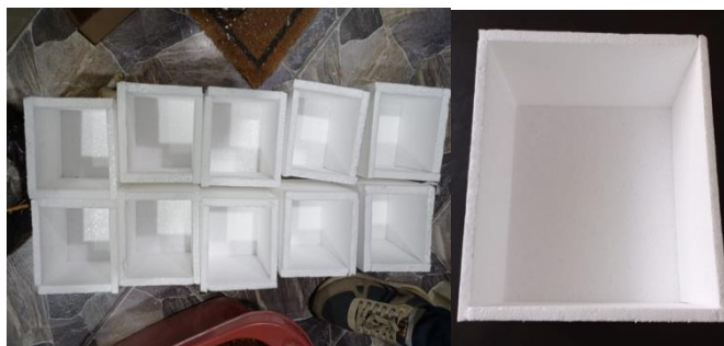
Figure 1, Moldes para la fabricación de ladrillos
