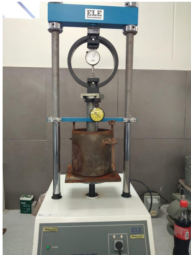
Realización del ensayo de penetración para todo el muestreo
