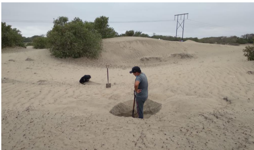
Figura 16. Proceso de excavación a 1.50m de la muestra de arena.
