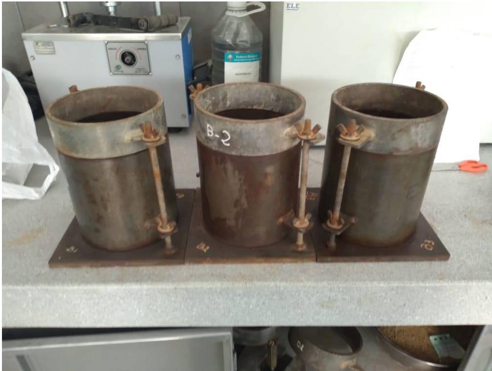
Moldes para 56, 25 y 12 golpes respectivamente del ensayo de CBR
