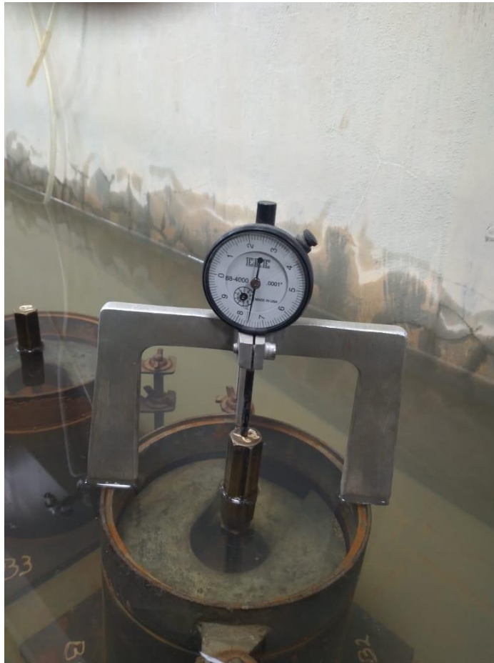
Toma de las expansiones con el dial de deformación cada 12 horas
