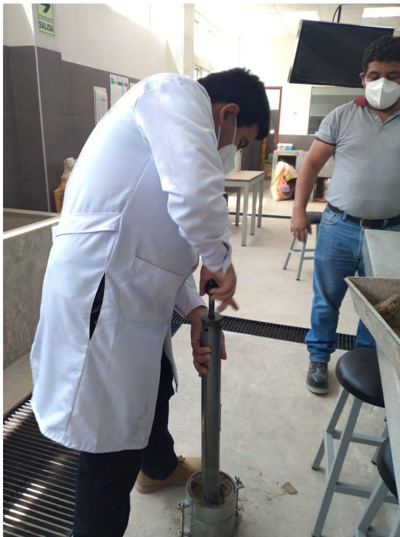
Realización de la compactación en el ensayo de Proctor Modificado
