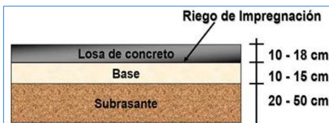
Figura 2. Estructura de un pavimento rígido. Fuente: DGIP [2]
