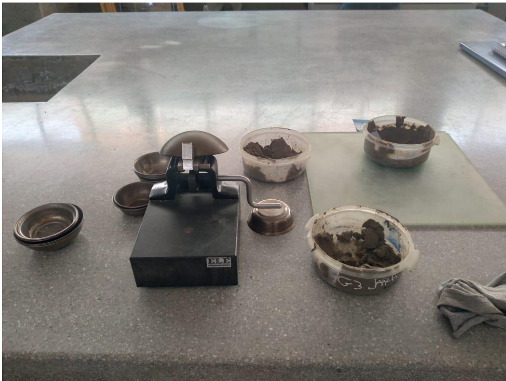
Realización de límite líquido para muestra natural y con adiciones
