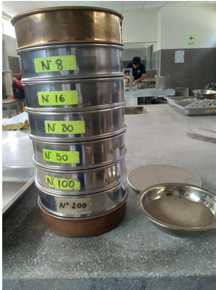
Ensayo Granulométrico para las muestras naturales de arena
