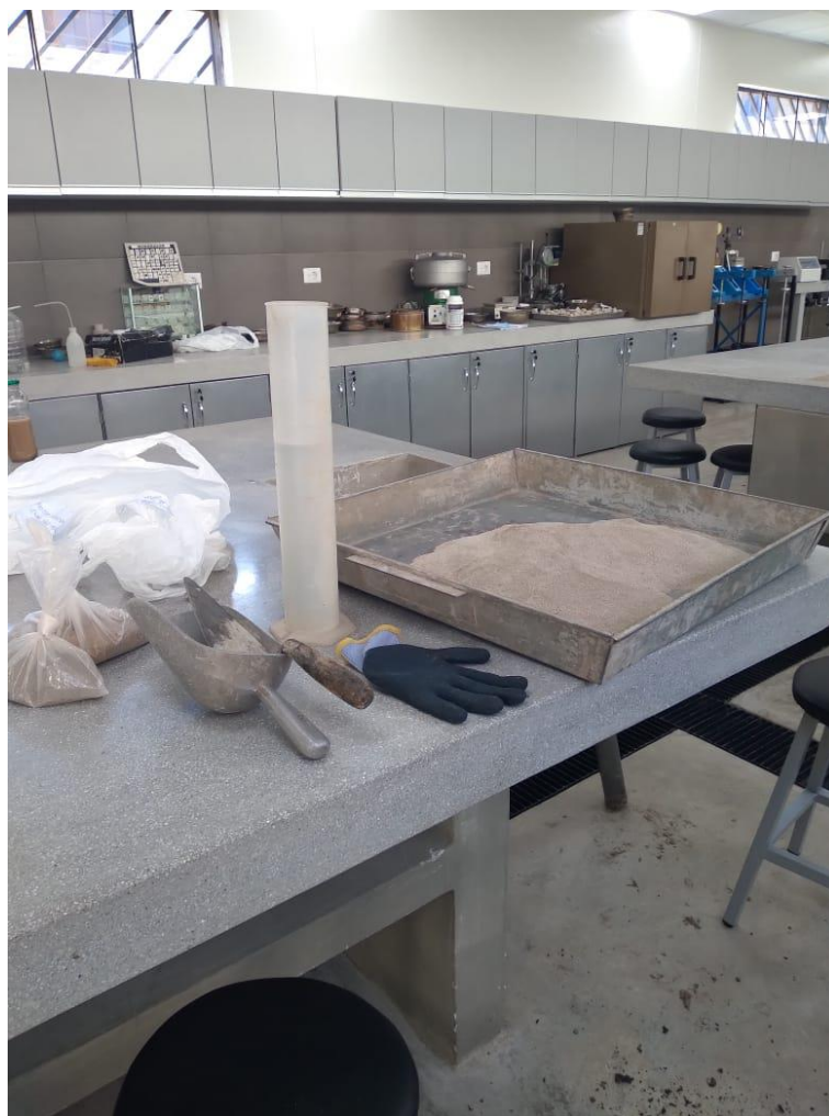
Muestra y equipos necesarios para el ensayo de Proctor modificado
