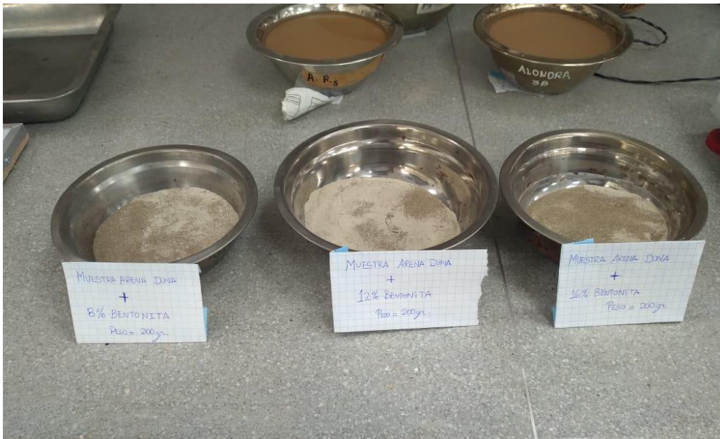
Muestras Experimentales con adición de bentonita para ser ensayados
