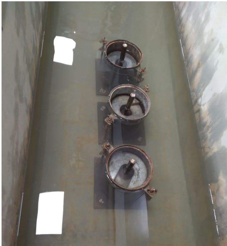
Sumergimiento de las muestras en agua por 96 horas para la expansión
