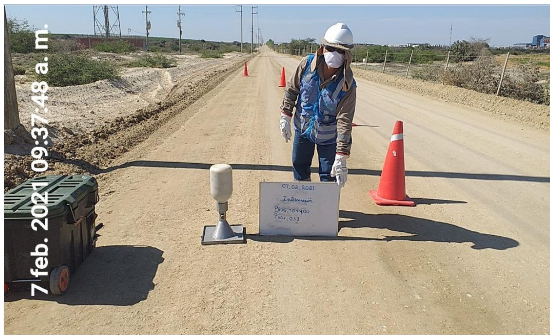
Ilustración 19. Ensayo de densidad de arena mediante el cono de arena
