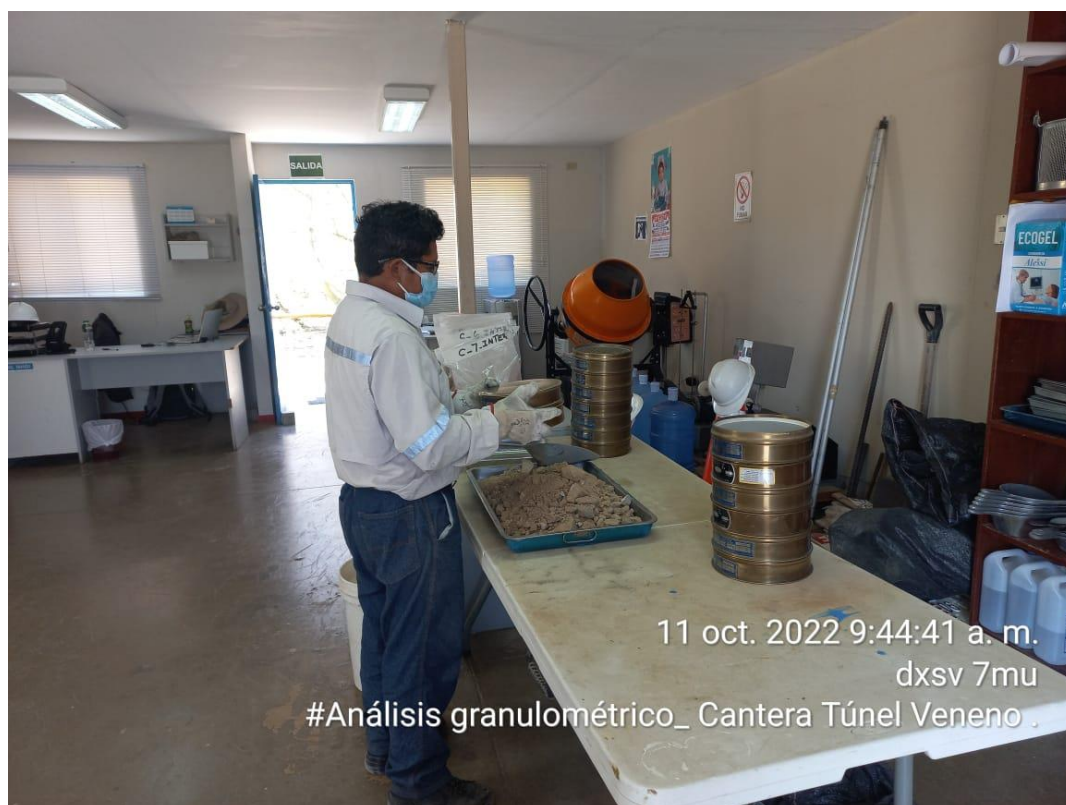
Ilustración 24. Ensayo de granulometría de afirmado
