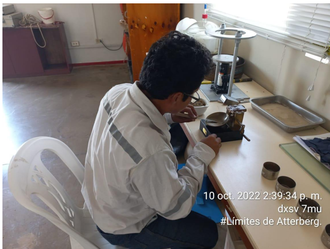
Ilustración 25. Ensayo de Límites de Atterberg
