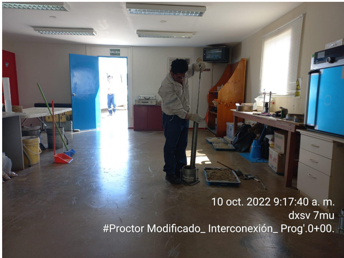
Ilustración 23. Ensayo de proctor modificado
