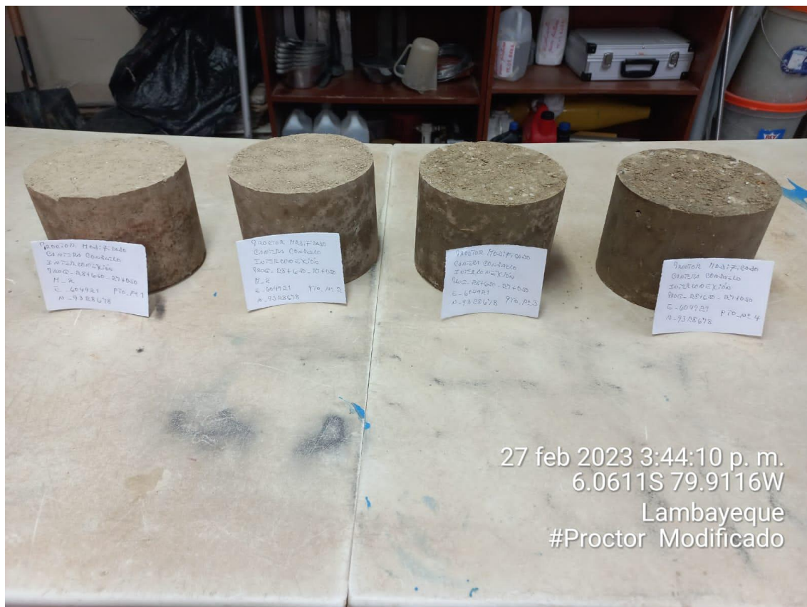
Ilustración 22. Ensayos de proctor modificado
