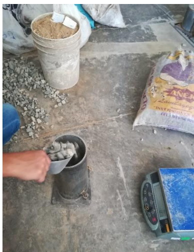
Figura 17: Colocando muestras de agregado en las probetas Fuente: Elaboración Propia
