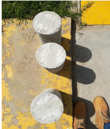
Figura 41: Se dejan secar las probetas Fuente: Elaboración Propia
