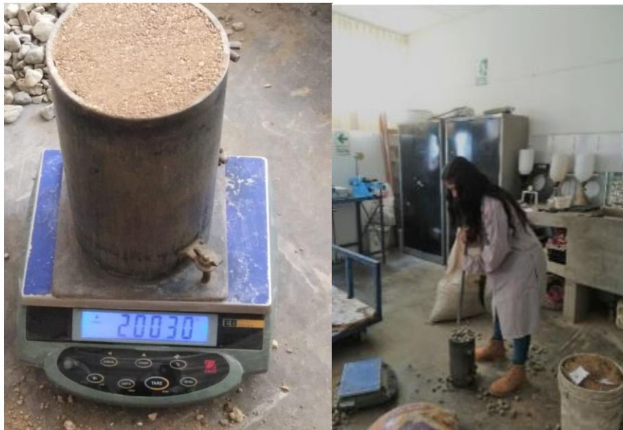
Fotografía 2. 9: Fotografías representativas en los ensayos de pesos volumétricos de los agregados
