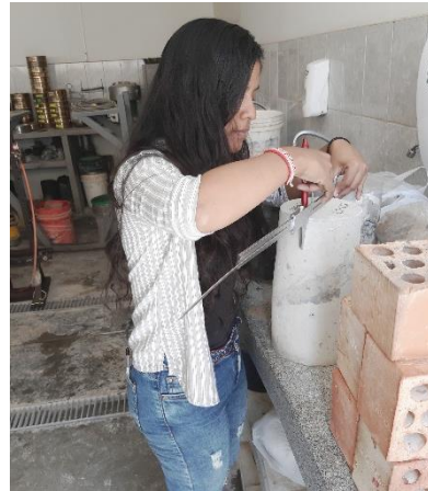
Figura 42: Se trazan los ejes a la probeta de concreto Fuente: Elaboración Propia
