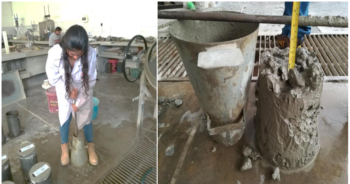
Fotografía 2. 14: Fotografías representativas del ensayo de cono de Abrams
