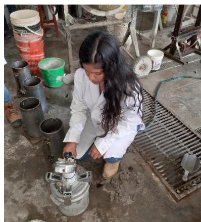
Figura 26: Tomar medida del contenido de aire.
