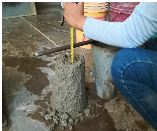
Figura 48: Slump en laboratorio (4'')
