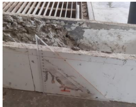
Figura 33: Medición del ángulo obtenido de manera aproximada con escuadra de 45°
