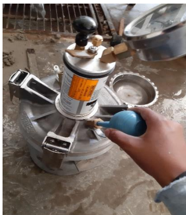
Figura 25: Introducir agua en una válvula para eliminar el aire en la mezcla.
