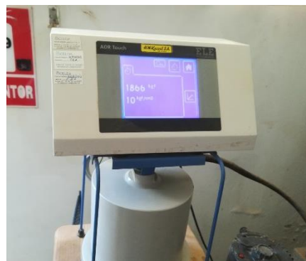
Figura 47: Tomar nota de la lectura de carga obtenida
