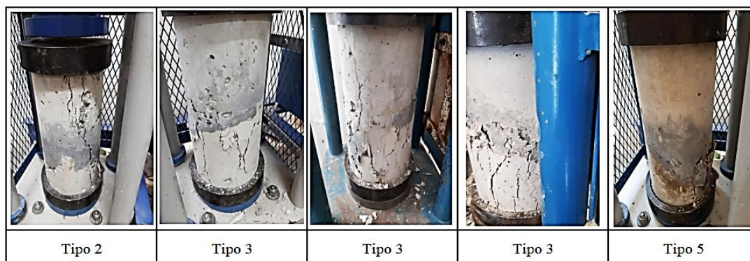
Figura 52: Tipos de fallas reales en los especímenes de concreto con epóxico a los 28 días de rotura.
