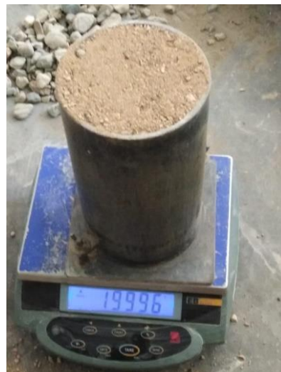
Figura 20: Pesando del material en la probeta para sus pesos unitarios Fuente: Elaboración Propia
