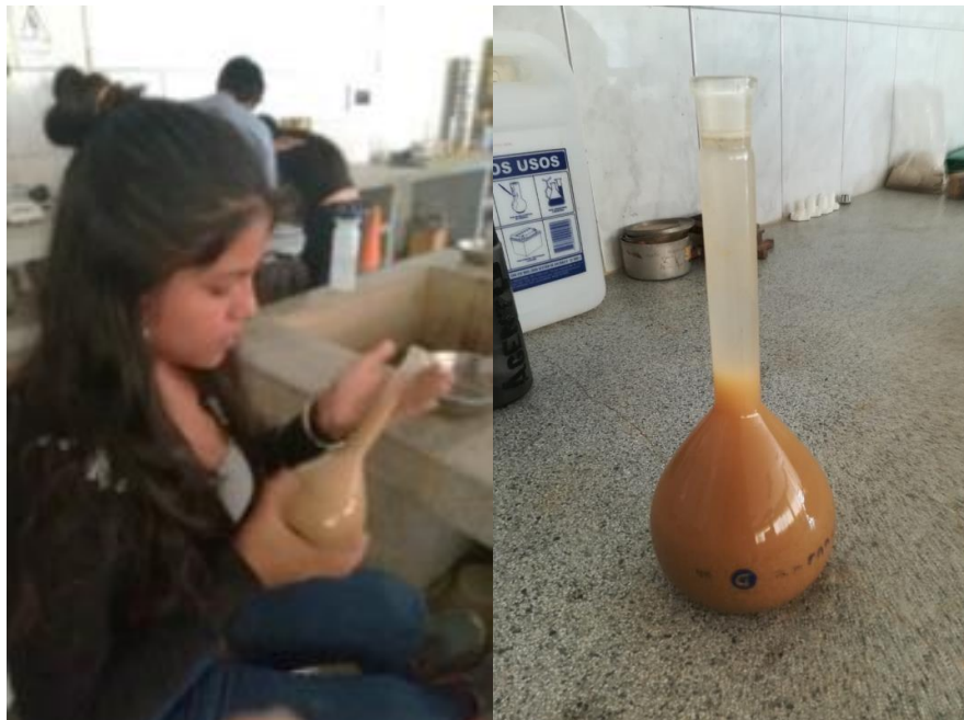
Fotografía 2. 10: Fotografías representativas del ensayo de pesos específico del agregado fino
