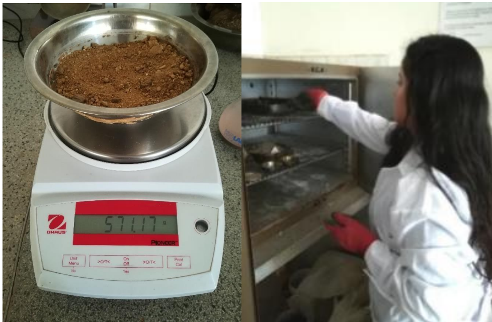
Fotografía 2. 8: Fotografías representativas del ensayo de contenido de humedad
