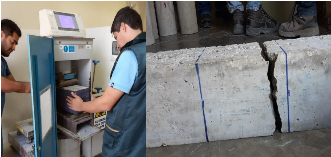
Fotografía 2. 28: Fotografías representativas del ensayo a flexión
