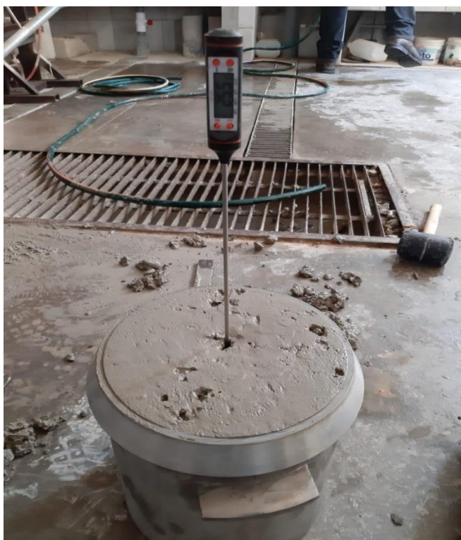
Fotografía 2. 17: Fotografías representativas del ensayo de temperatura
