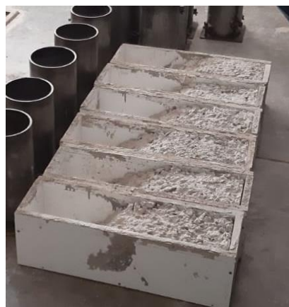
Figura 35: Vigas llenadas con ángulo de 45° aproximadamente Fuente: Elaboración Propia
