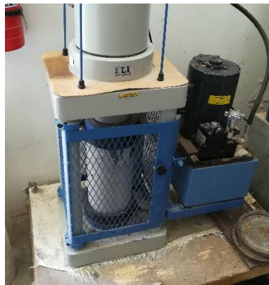
Figura 39: Centrar la probeta en la máquina de carga Fuente: Elaboración Propia
