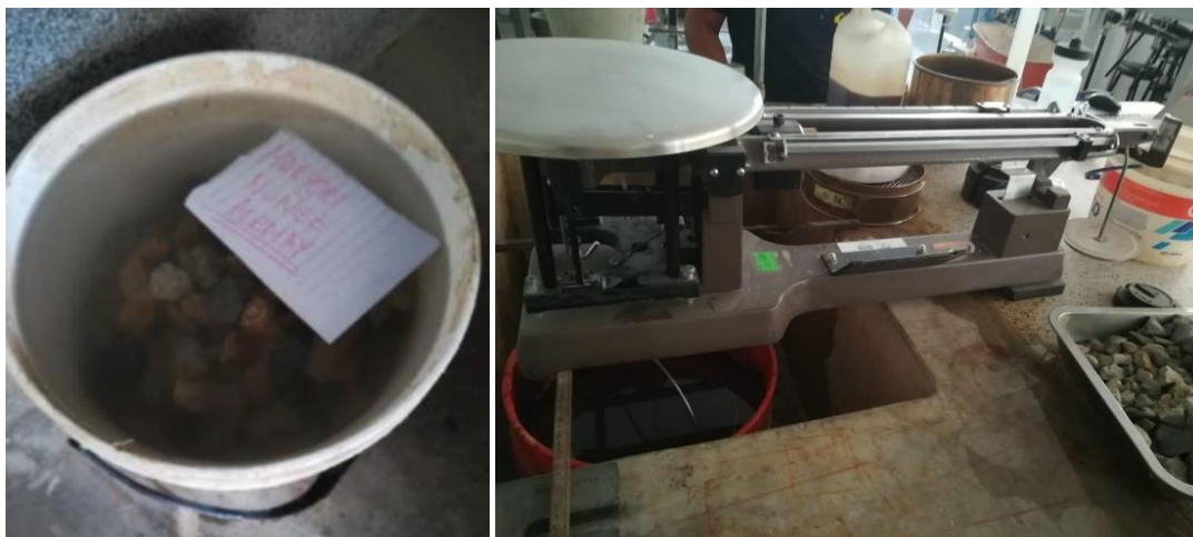
Fotografía 2. 11: Fotografías representativas del ensayo de pesos específico del agregado grueso
