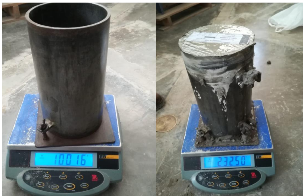
Fotografía 2. 15: Fotografía representativa de los pesos unitarios del concreto fresco
