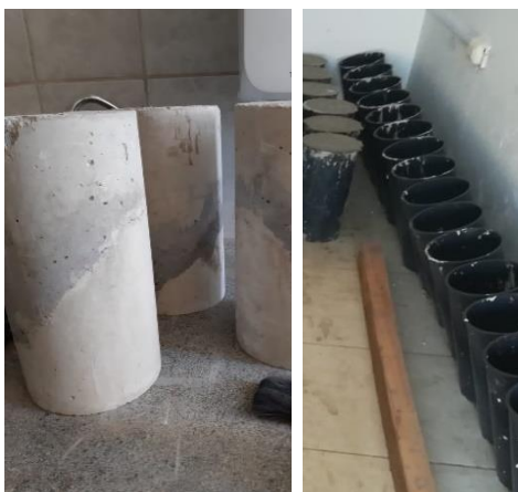
Figura 34: Ángulo de 45° aproximadamente en las probetas Fuente: Elaboración Propia
