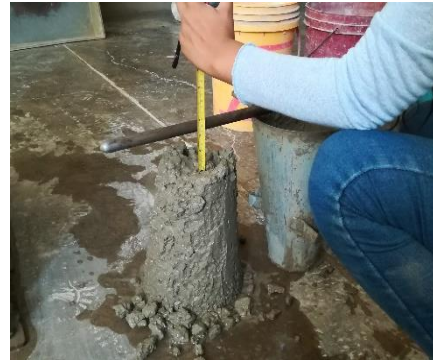
Figura 22: Se mide con wincha Fuente: Elaboración Propia
