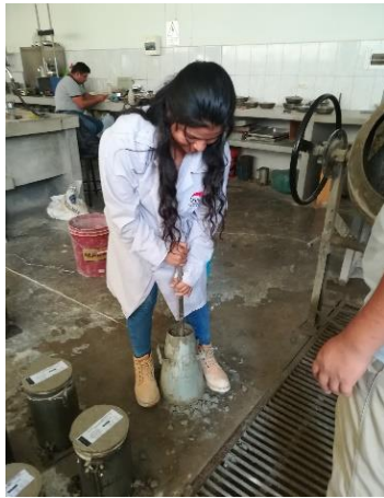
Figura 21: Se aplicó 25 golpes con barra compactadora en cada capa Fuente: Elaboración Propia
