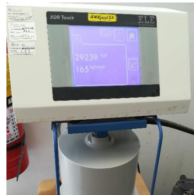
Figura 40: Tomar nota de la lectura de carga obtenida Fuente: Elaboración Propia
