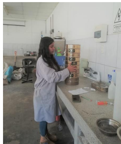
Figura 2: Tamizado del agregado
