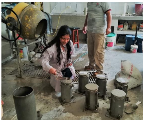
Figura 28: Elaboración de especímenes de concreto en laboratorio Fuente: Elaboración Propia
