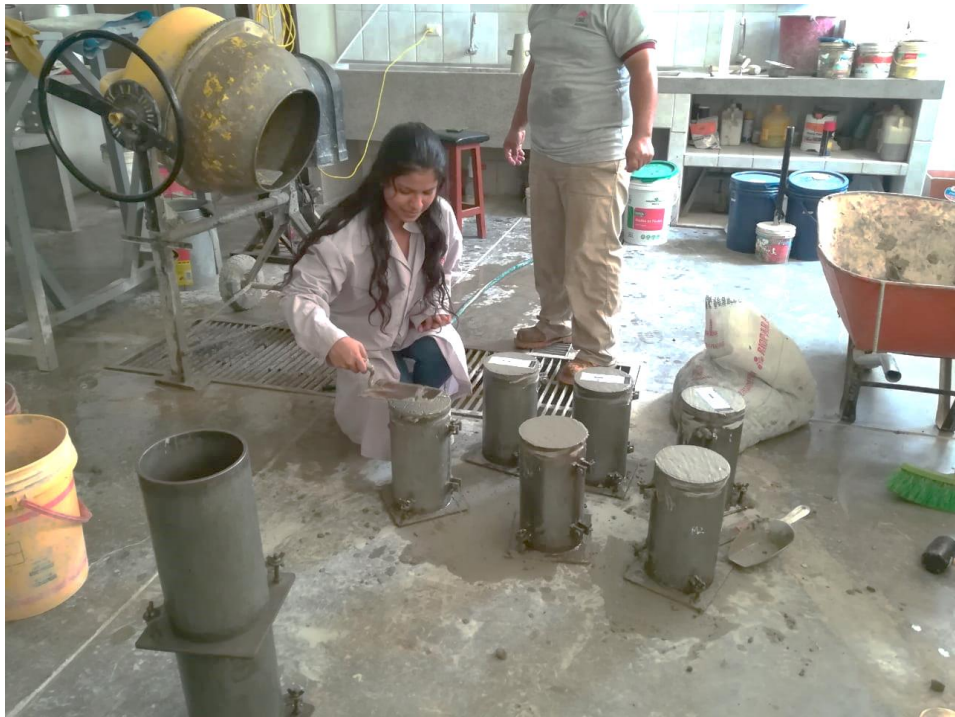
Fotografía 2. 13: Fotografía representativa de la elaboración de concreto patrón
