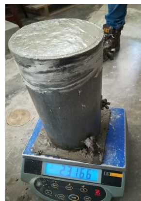
Figura 24: Se pesa la probeta con concreto fresco Fuente: Elaboración Propia
