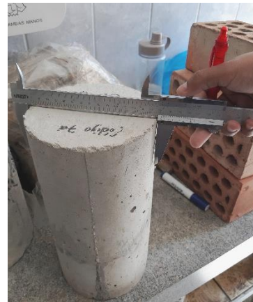
Figura 38: Tomar las medidas exactas de las probetas Fuente: Elaboración Propia
