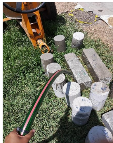
Figura 31: Curado superficial Fuente: Elaboración Propia
