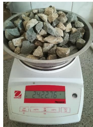
Figura 16: Pesar la muestra seca
