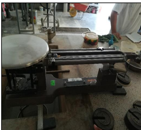
Figura 15: Se pesa el agregado grueso + canastilla
