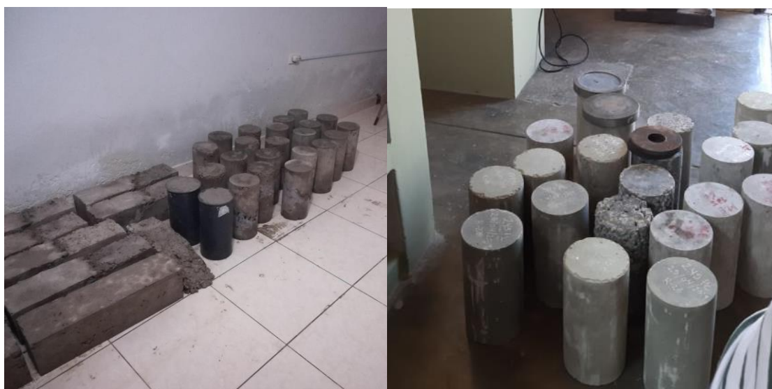
Fotografía 2. 22: Fotografías representativas del curado de especímenes de concreto bajo la sombra
