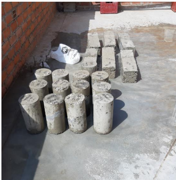
Fotografía 2. 23: Fotografías representativas del curado de especímenes de concreto bajo el sol
