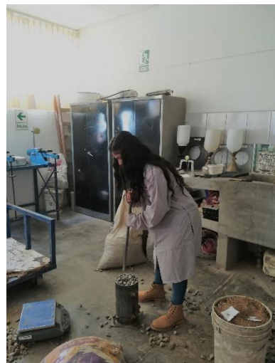
Figura 18: Se da 25 golpes con varilla lisa de 3/8"
