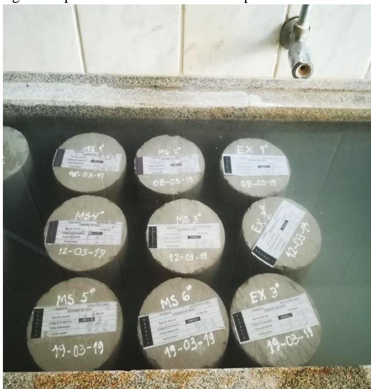
Fotografía 2. 18: Fotografía representativa del curado de especímenes de concreto patrón
