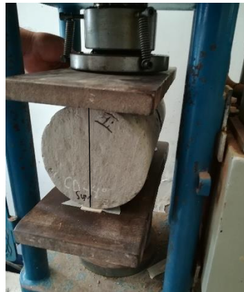
Figura 43: Centrar la probeta en la máquina de carga Fuente: Elaboración Propia
