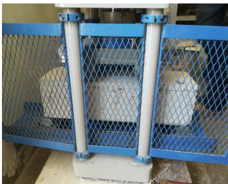
Figura 46: Centrar la viga en la máquina de carga, para que apoyos queden a cada tercio de la misma.
