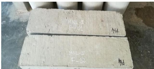
Figura 45: Se dejan secar a temperatura ambiente las vigas (especímenes prismáticos)
