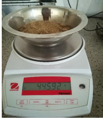
Figura 3: Se pesa el agregado retenido Fuente: Elaboración Propia
