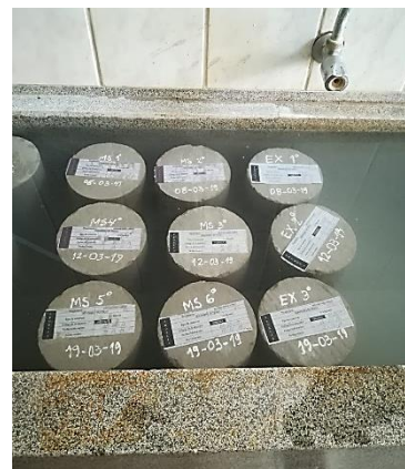
Figura 29: Curado en laboratorio de muestras patrón Fuente: Elaboración Propia
