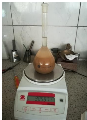
Figura 11: Peso de la fiola+ agregado fino + agua después de 24 horas.
