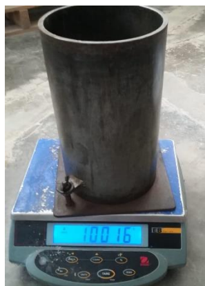
Figura 23: Se pesa la probeta de metal Fuente: Elaboración Propia
