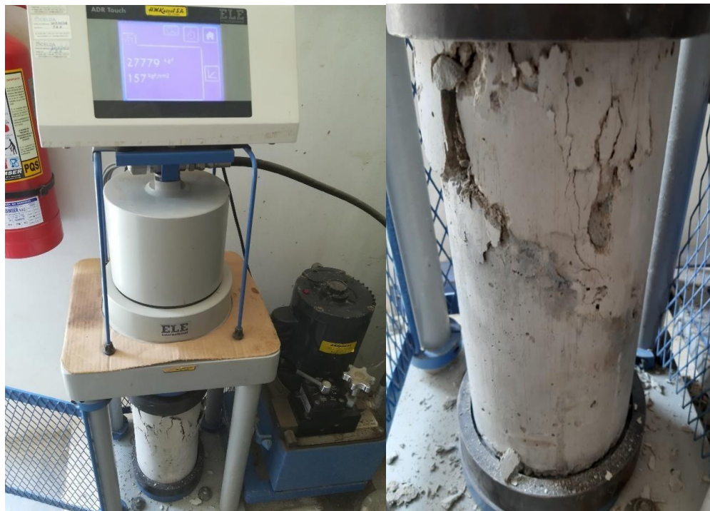
Fotografía 2. 26: Fotografías representativas del ensayo a compresión
