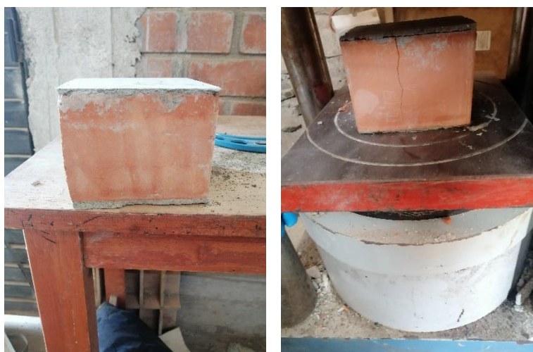
Figura N°13: Compresión de las unidades de ladrillo
