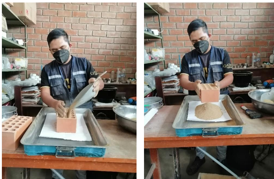
Figura N°14: Ensayo de contenido de vacíos de las unidades de albañilería
