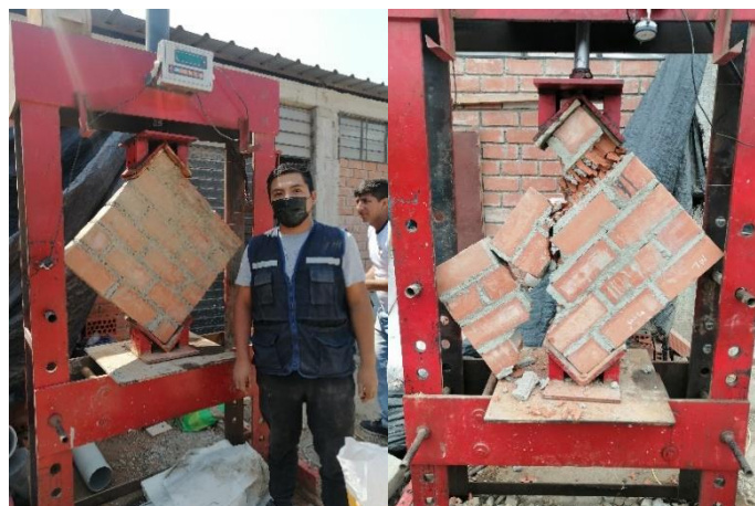
Figura N°57: Ensayo a la compresión de muretes
