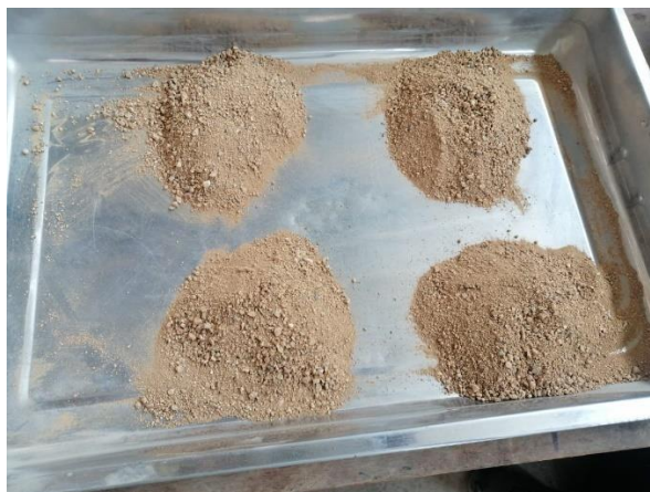
Figura N°3: Cuarteo de la muestra de agregado fino
