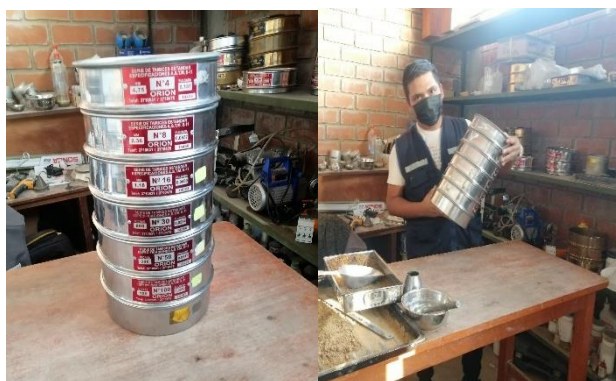
Figura N°4: Tamices y tamizado de la muestra
