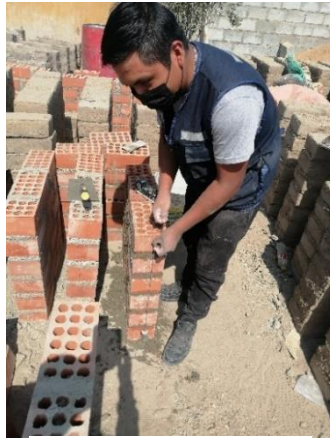
Figura N°55: Elaboración de muretes
