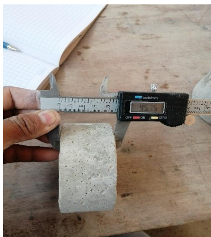
Figura N°37: toma de medidas de la muestra para ensayo de absorción
