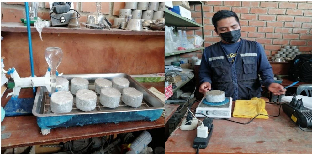
Figura N°42: Toma de los pesos para determinar la velocidad de absorción
