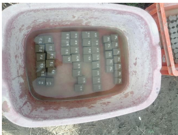
Figura N°31: curado de los cubos de mortero
