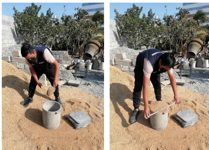
Figura N°9: peso unitario suelto
