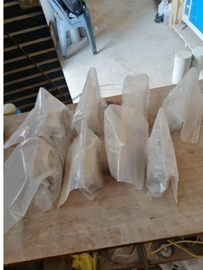
Figura N°41: Colocación de los especímenes en bolsas herméticas
