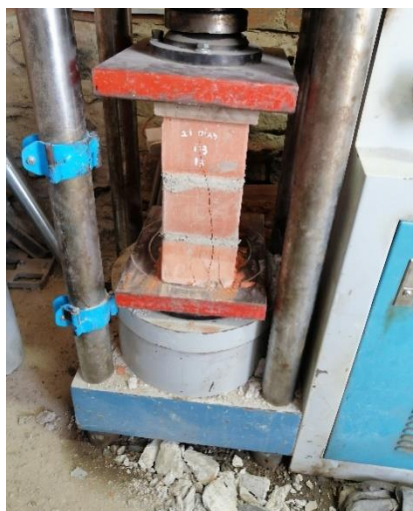
Figura N°54: Ensayo de compresión axial de las pilas
