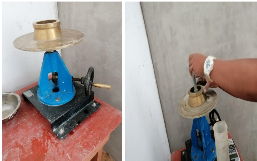
Figura N°18: Colocación de la muestra en la mesa de flujo
