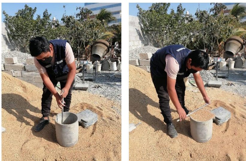
Figura N°10: peso unitario compactado
