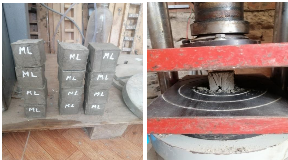
Figura N°32: Ruptura de los cubos de mortero
