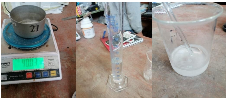
Figura N°39: Solución de bromuro de potasio con agua destilada
