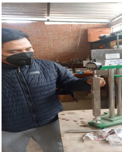
Figura N°30: Toma de medidas de variación de longitud
