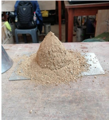
Figura N°7: Muestra húmeda con superficie seca
