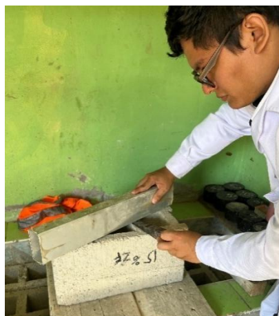
Ilustración 18: Medición del alabeo
