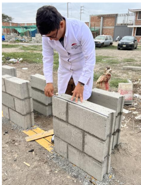
Ilustración 17: Medición del ancho de los muretes
