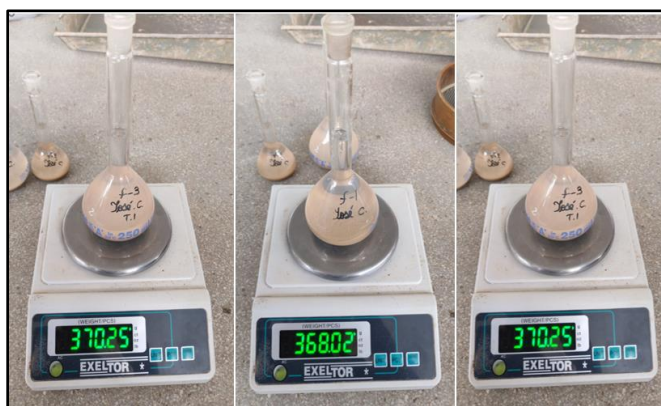
Fig. 37. Pesaje de fiola con el contenido luego de 24 horas de reposo.
