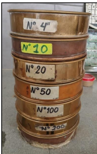
Fig. 27. Preparación de tamices para colocar cada muestra.
