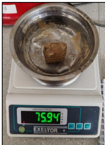
Fig. 38. Pesaje de la muestra antes de la parafina.
