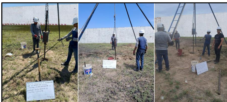
Fig. 18. Realización de ensayo SPT sobre terreno de edificación.
