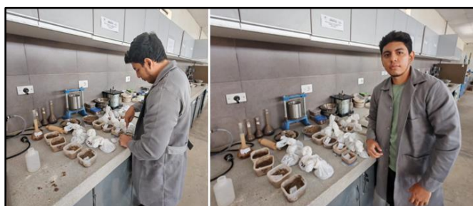
Fig. 31. Saturación de muestras para dejarlas en reposo.
