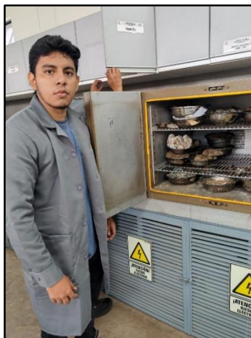
Fig. 22. Colocación de muestras en el horno durante 24 horas.
