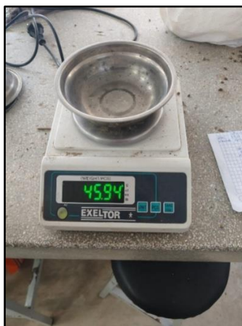
Fig. 20. Pesaje de taras para colocar la muestra.
