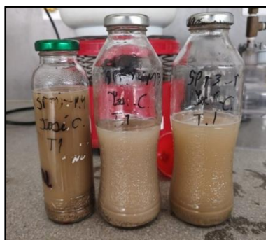
Fig. 41. Muestras colocadas en los recipientes y agitadas durante 1 hora.
