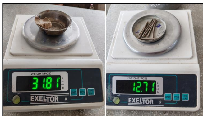
Fig. 32. Pesaje de muestras húmedas para determinar límites.
