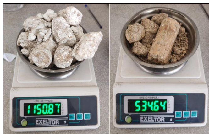
Fig. 23. Pesaje de muestras secas con la tara.
