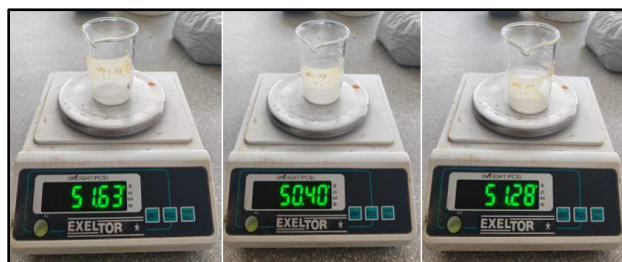
Fig. 44. Pesaje de vasos luego de secado en el horno.
