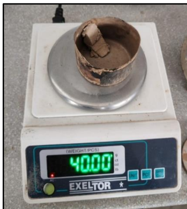
Fig. 33. Pesaje de muestras secas para determinar límites.
