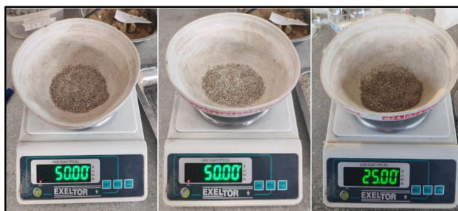
Fig. 35. Pesaje de muestras para colocar en las fiolas.
