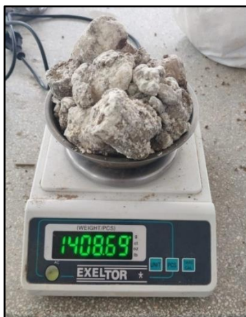
Fig. 21. Pesaje de muestra húmeda con la tara.
