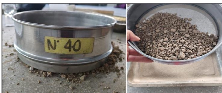
Fig. 29. Trituración y tamizaje de las muestras a través de la malla N° 40.
