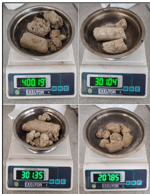
Fig. 24. Toma de muestras representativas del ensayo de contenido de humedad.
