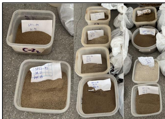
Fig. 30. Muestras tamizadas y almacenadas en recipientes para saturar.
