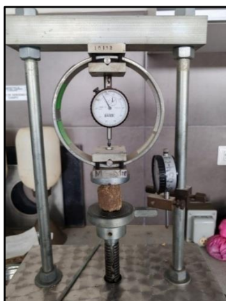
Fig. 45. Colocación de muestra en maquina uniaxial.
