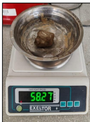
Fig. 39. Pesaje de la muestra con la parafina.
