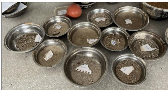
Fig. 26. Muestras lavadas y secadas en el horno preparadas para tamizaje
