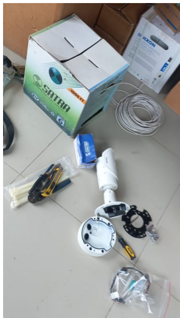
Fig. 21. Cámara IP tubular usada para funcionamiento de solución.
