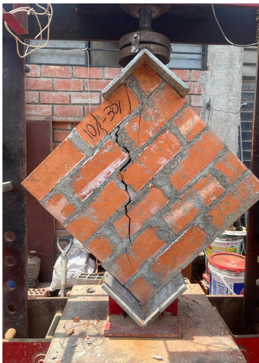
Imagen 103. Murete del 10 % Aserrín calcinado y 30% Concreto Reciclado – Falla por tensión
