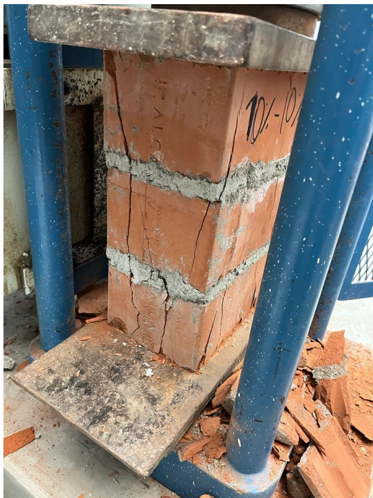
Imagen 85. Pila del 10 % Aserrín calcinado y 30% Concreto Reciclado – Falla explosiva
