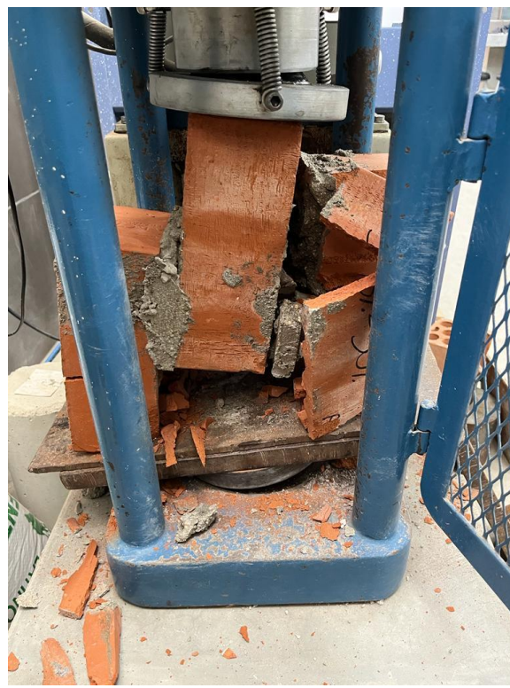
Imagen 66. Adherencia al 5 % Aserrín calcinado y 30% Concreto Reciclado – Falla mixta
