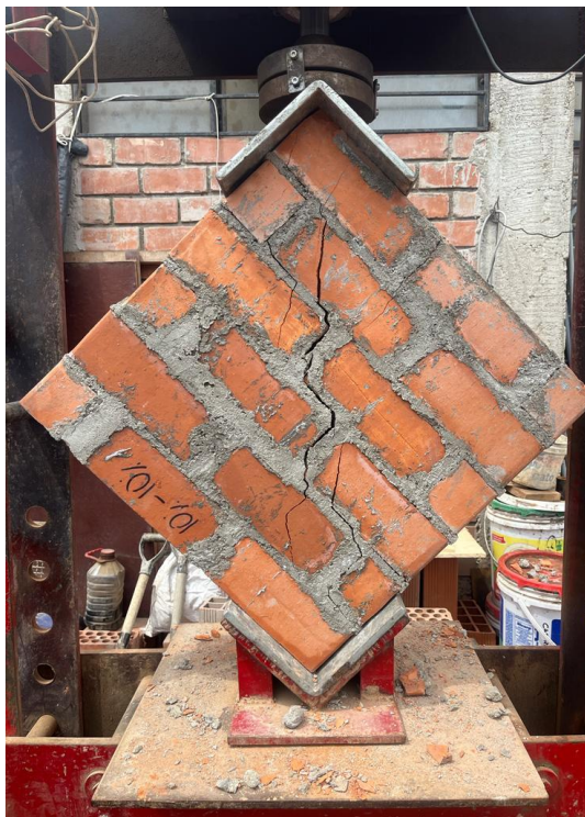
Imagen 103. Murete del 10 % Aserrín calcinado y 30% Concreto Reciclado – Falla por tensión
