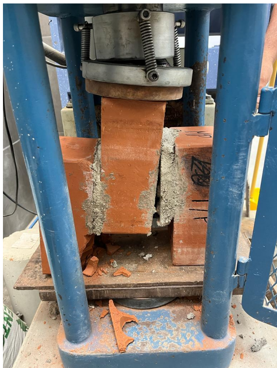
Imagen 65. Adherencia al 5 % Aserrín calcinado y 20% Concreto Reciclado – Falla pieza
