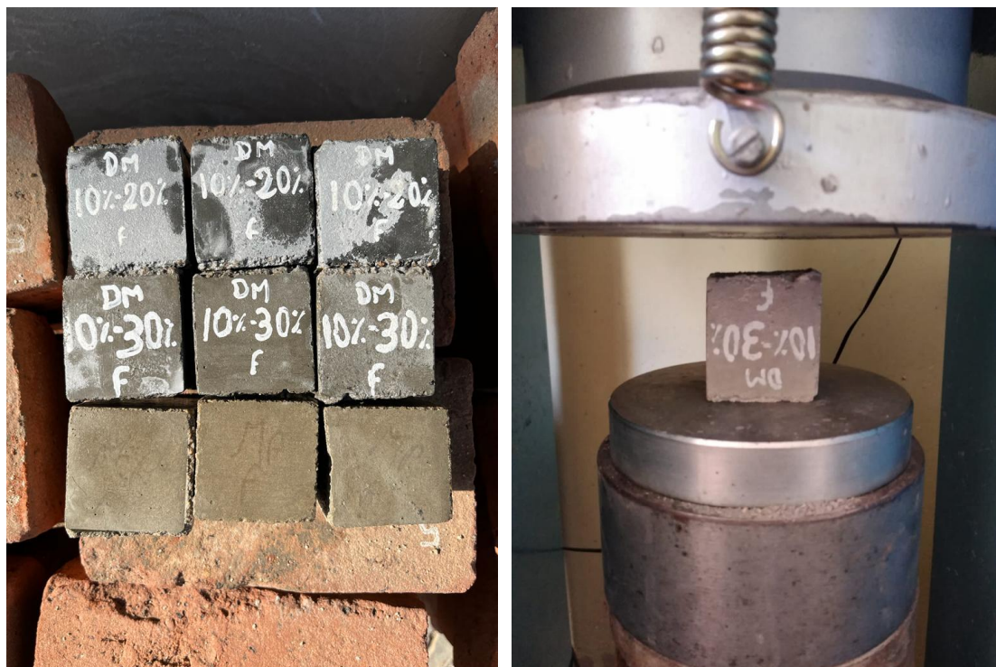
Imagen 111. Muestras de cubos de mortero
