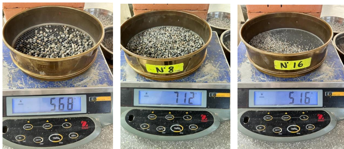
Imagen 41. Peso De Muestras Para Los Terrones De Arcillas
