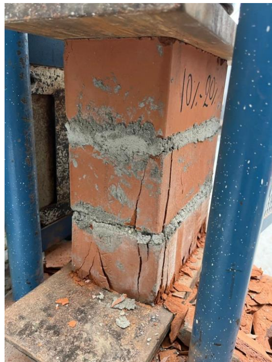
Imagen 86. Pila del 15 % Aserrín calcinado y 10% Concreto Reciclado – Falla explosiva
