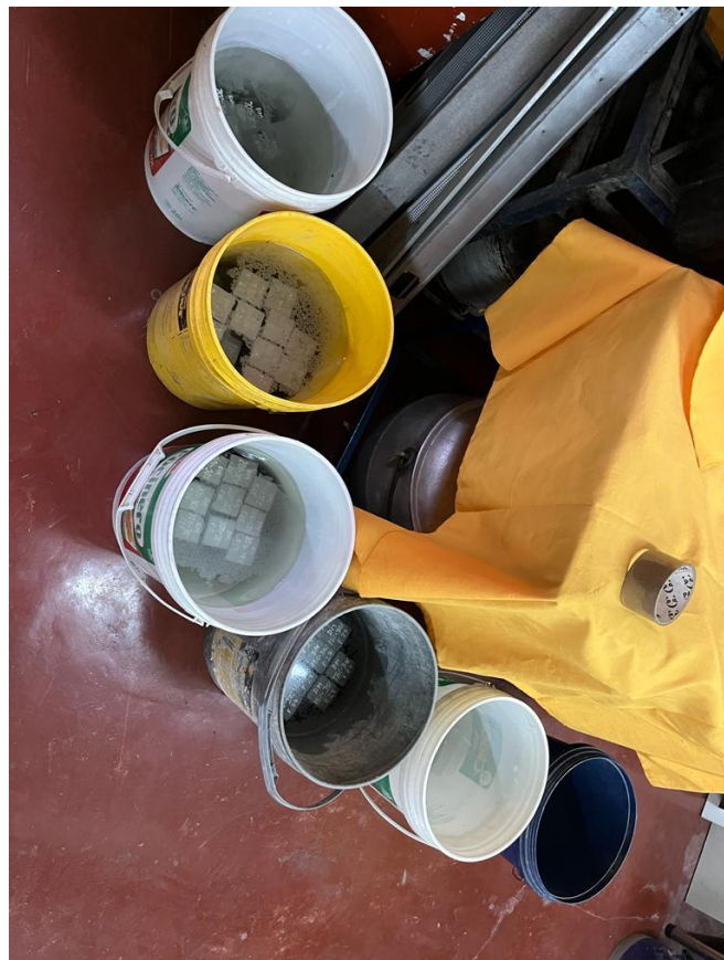
Imagen 57. Cubos de mortero sumergidos en agua
