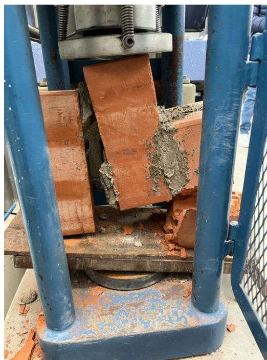
Imagen 64. Adherencia al 5 % Aserrín calcinado y 10% Concreto Reciclado – Falla junta
