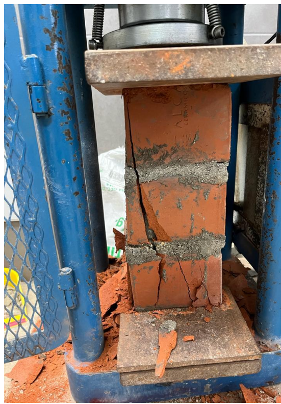
Imagen 82. Pila del 5 % Aserrín calcinado y 30% Concreto Reciclado – Falla por agrietamiento vertical
