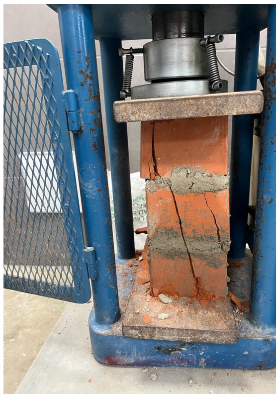
Imagen 81. Pila del 5 % Aserrín calcinado y 20% Concreto Reciclado – Falla por cortante
