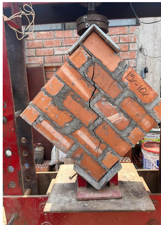
Imagen 104. Murete del 15 % Aserrín calcinado y 10% Concreto Reciclado – Falla por tensión
