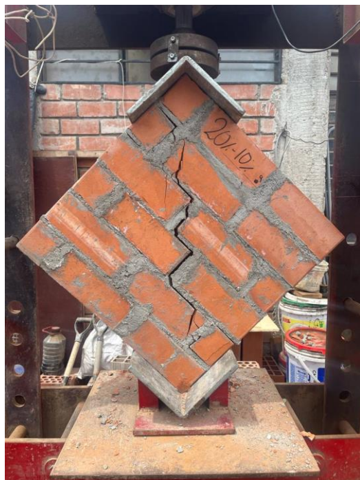
Imagen 107. Murete del 20 % Aserrín calcinado y 10% Concreto Reciclado – Falla combinada
