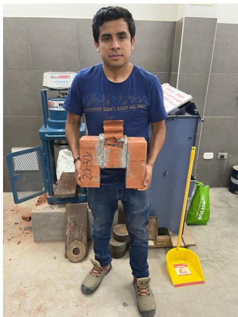
Imagen 62. Mortero con buenas adherencias al ladrillo
