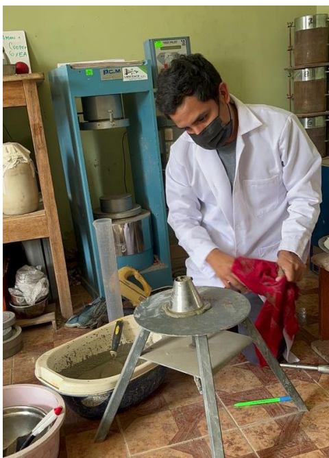
Imagen 52. Limpieza y secado de la meza de flujo
