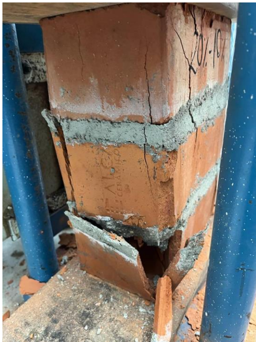
Imagen 89. Pila del 20 % Aserrín calcinado y 10% Concreto Reciclado – Falla por Flexión
