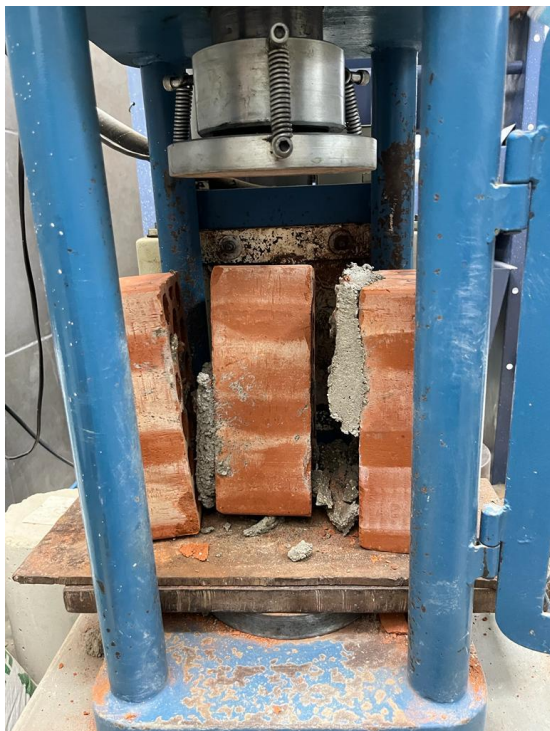
Imagen 69. Adherencia al 10 % Aserrín calcinado y 30% Concreto Reciclado – Falla pieza
