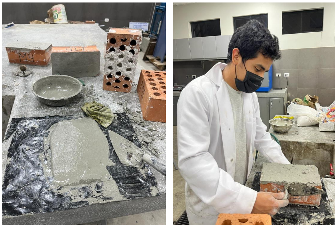
Imagen 131. Muestras para el ensayo de compresión a la unidad de albañilería
