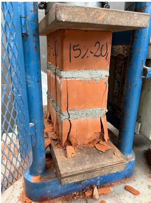
Imagen 89. Pila del 20 % Aserrín calcinado y 10% Concreto Reciclado – Falla por Flexión
