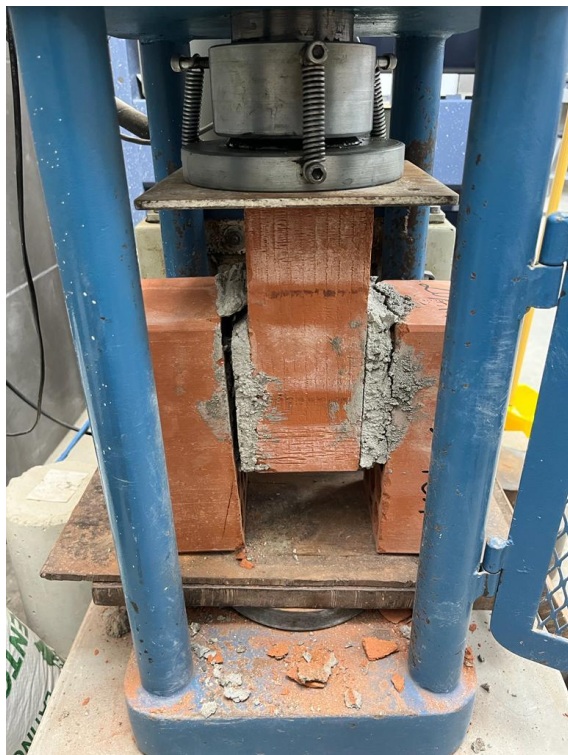
Imagen 73. Adherencia al 20 % Aserrín calcinado y 10% Concreto Reciclado – Falla junta
