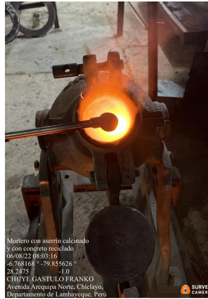
Imagen 27. Quemado secundario del aserrín
