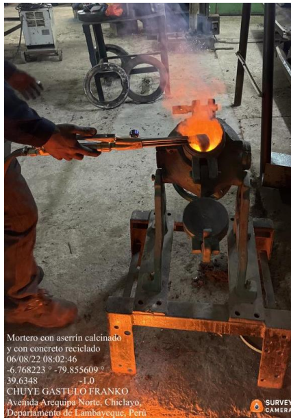
Imagen 27. Quemado secundario del aserrín
