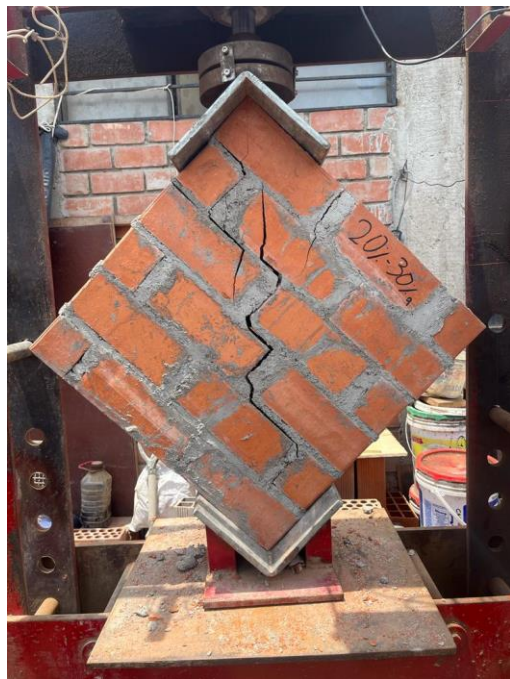
Imagen 109. Murete del 20 % Aserrín calcinado y 30% Concreto Reciclado – Falla por tensión
