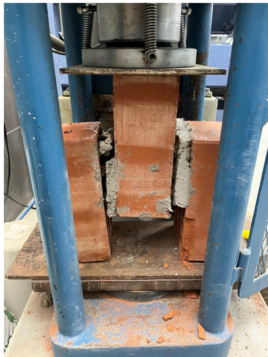
Imagen 70. Adherencia al 15 % Aserrín calcinado y 10% Concreto Reciclado – Falla junta
