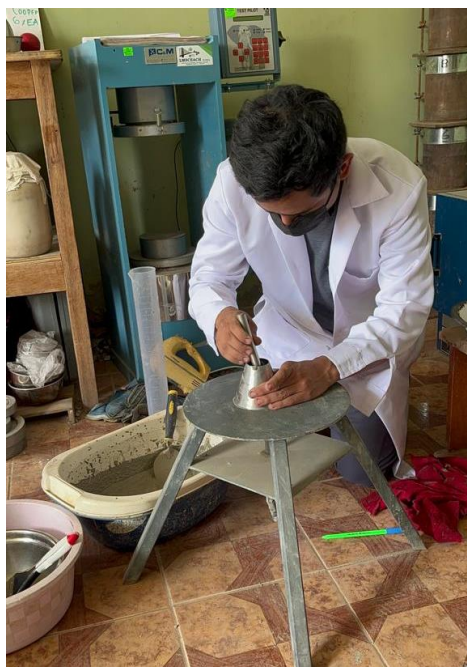
Imagen 51. Apisonamiento de la mezcla
