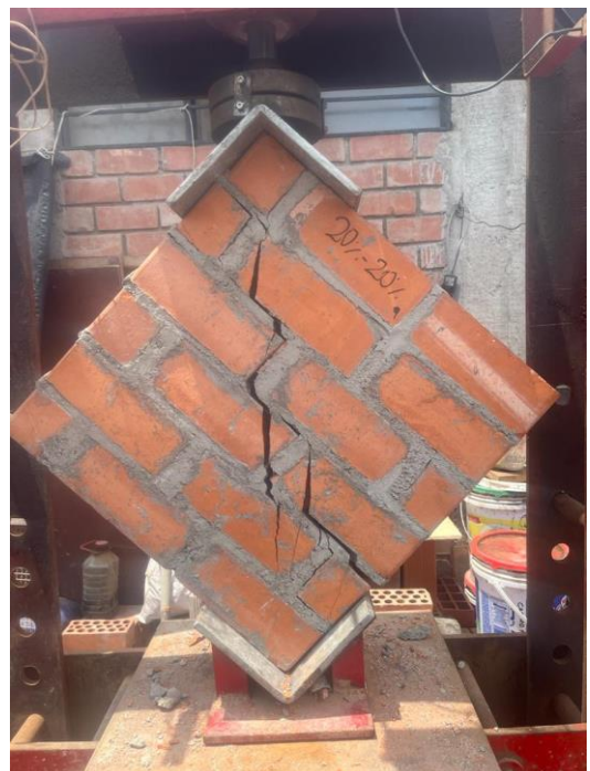
Imagen 108. Murete del 20 % Aserrín calcinado y 20% Concreto Reciclado – Falla combinada
