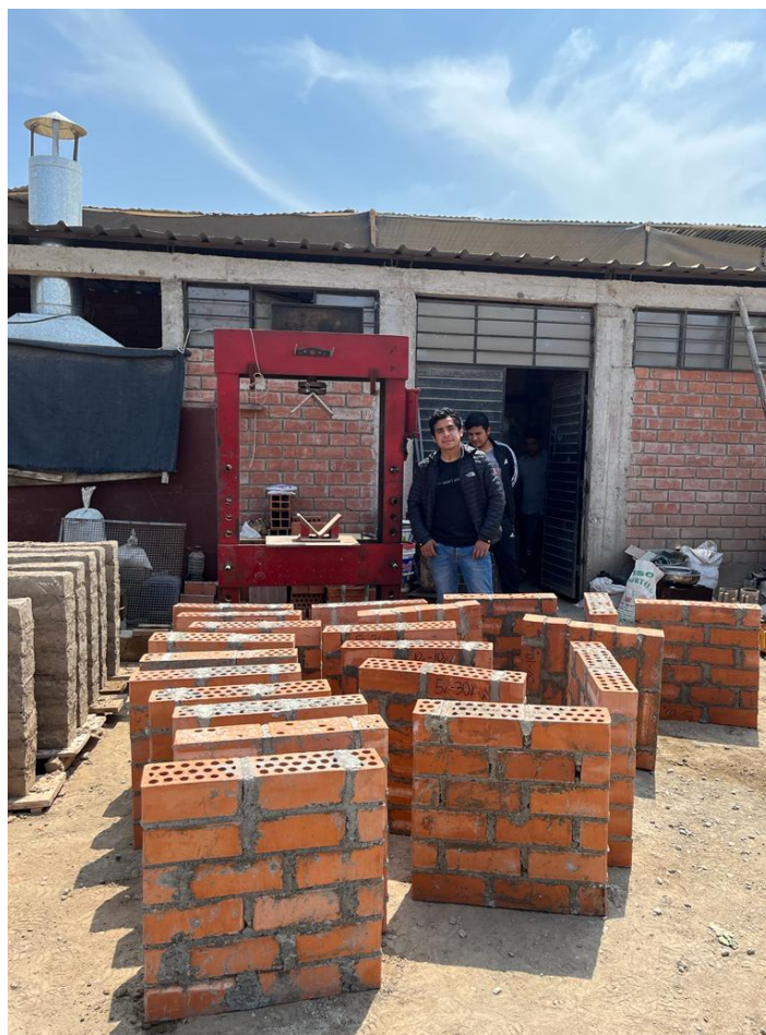
Imagen 95. Muros de albañilería con diferente dosificación
