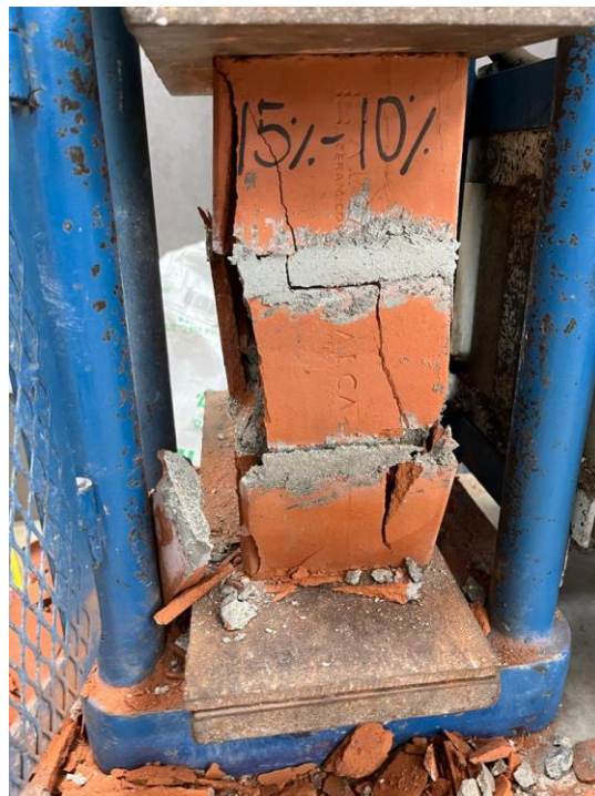
Imagen 86. Pila del 15 % Aserrín calcinado y 10% Concreto Reciclado – Falla explosiva
