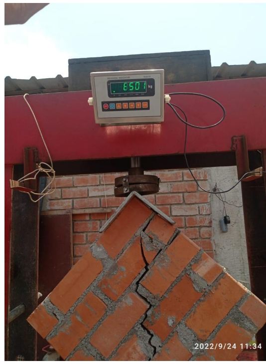
Imagen 108. Murete del 20 % Aserrín calcinado y 20% Concreto Reciclado – Falla combinada
