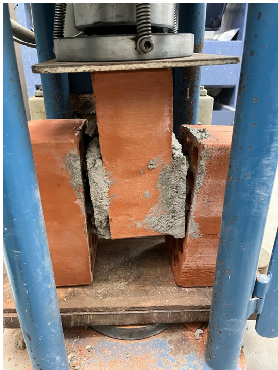
Imagen 73. Adherencia al 20 % Aserrín calcinado y 10% Concreto Reciclado – Falla junta
