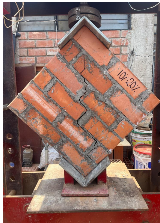
Imagen 104. Murete del 15 % Aserrín calcinado y 10% Concreto Reciclado – Falla por tensión
