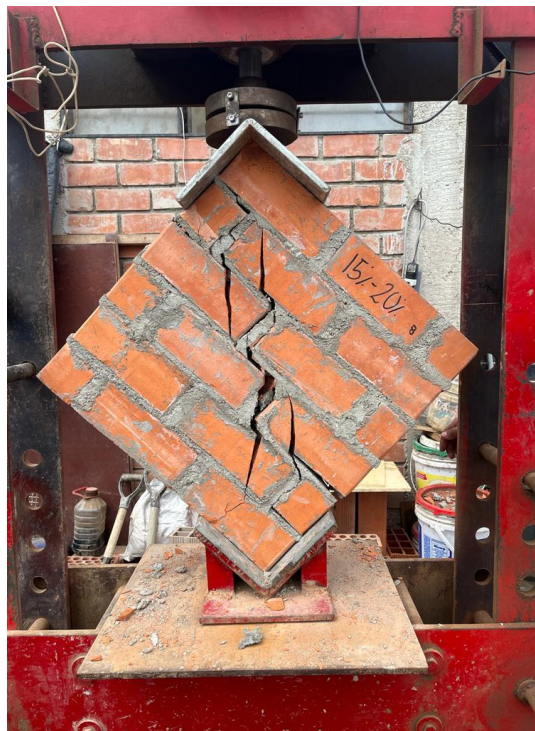
Imagen 107. Murete del 20 % Aserrín calcinado y 10% Concreto Reciclado – Falla combinada
