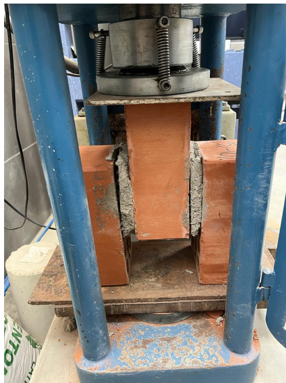
Imagen 70. Adherencia al 15 % Aserrín calcinado y 10% Concreto Reciclado – Falla junta
