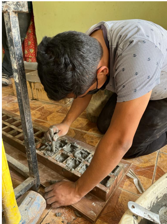
Imagen 47. Apisonamiento de los morteros moldeados
