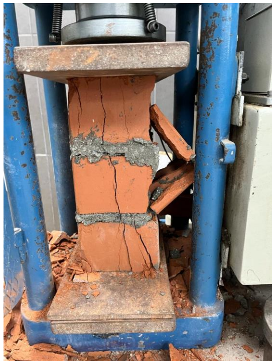
Imagen 85. Pila del 10 % Aserrín calcinado y 30% Concreto Reciclado – Falla explosiva
