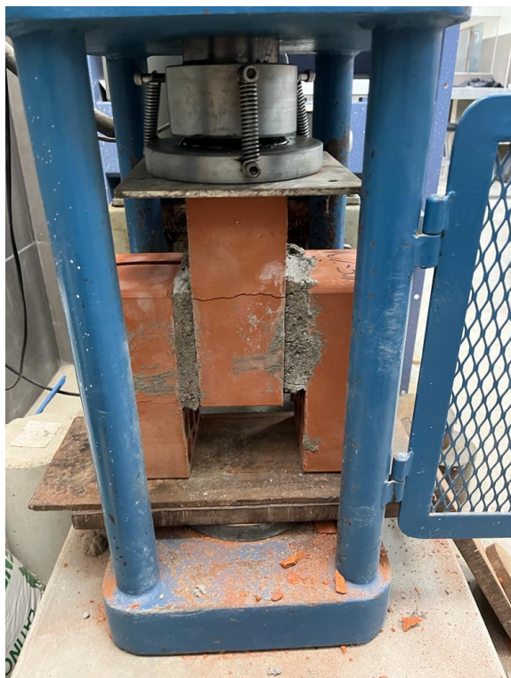
Imagen 69. Adherencia al 10 % Aserrín calcinado y 30% Concreto Reciclado – Falla pieza
