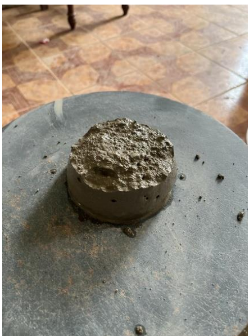
Imagen 53. Muestra asentada luego de quitar el molde
