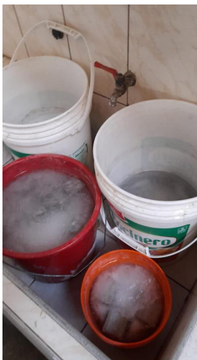
Imagen 114. Cubos de mortero en el descongelamiento
