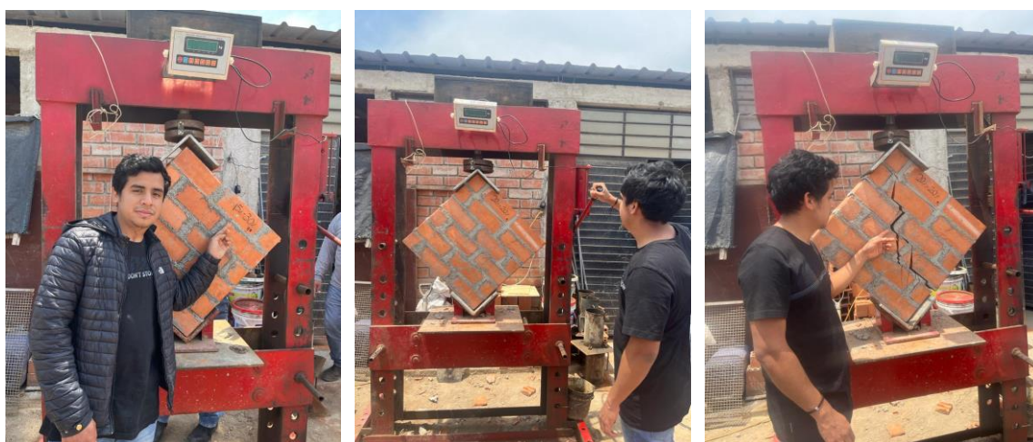
Imagen 96. Rotura de muros de albañilería
