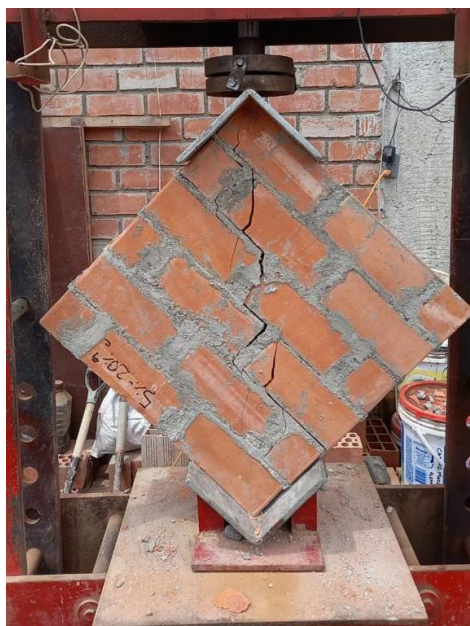
Imagen 99. Murete del 5 % Aserrín calcinado y 20% Concreto Reciclado – Falla por tensión
