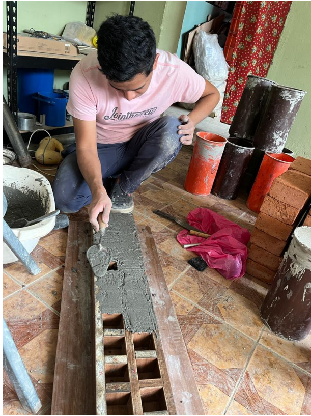
Imagen 48. Enrasamiento de los moldes cúbicos
