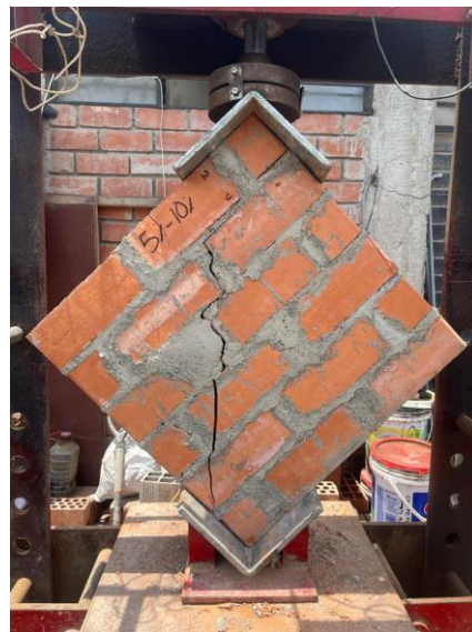
Imagen 100. Murete del 5 % Aserrín calcinado y 30% Concreto Reciclado – Falla por tensión
