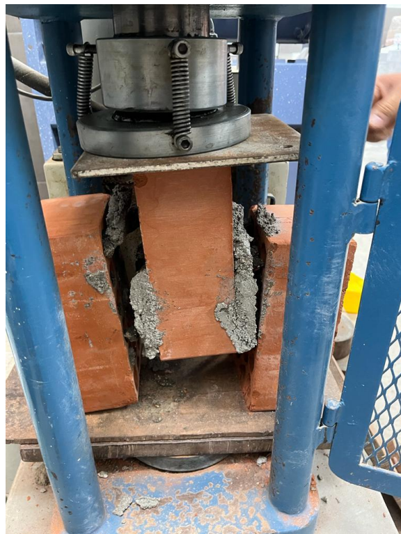
Imagen 74. Adherencia al 20 % Aserrín calcinado y 20% Concreto Reciclado – Falla junta
