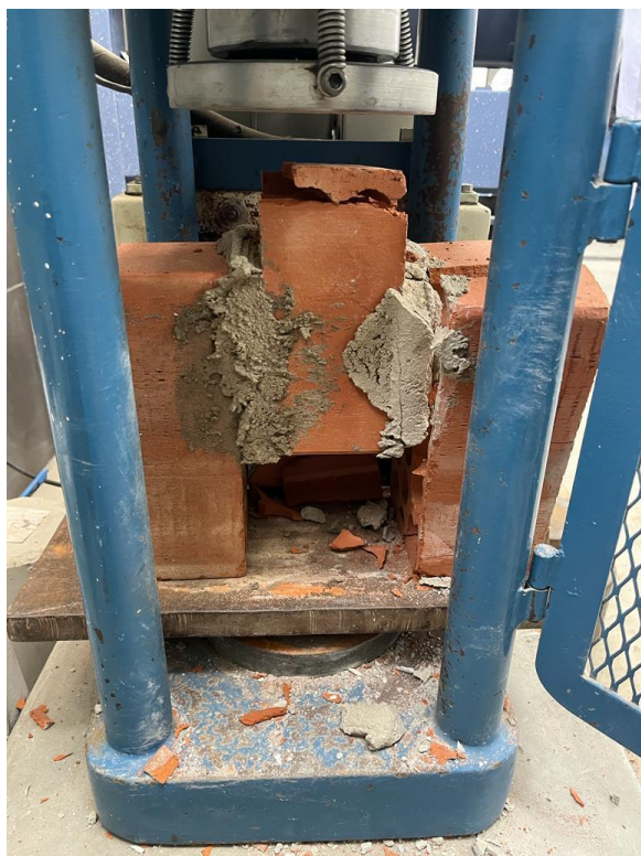
Imagen 65. Adherencia al 5 % Aserrín calcinado y 20% Concreto Reciclado – Falla pieza
