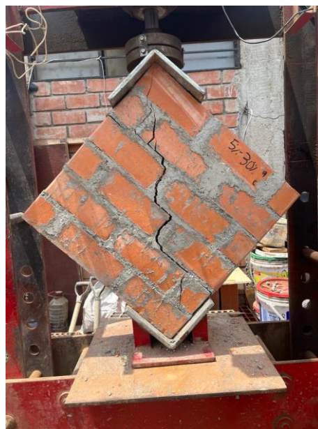
Imagen 100. Murete del 5 % Aserrín calcinado y 30% Concreto Reciclado – Falla por tensión
