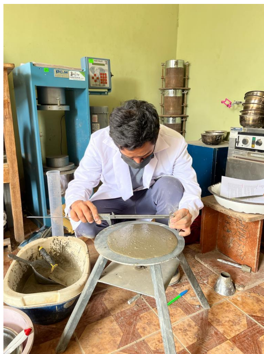
Imagen 55. Medida de los 4 diámetros de la muestra fluida
