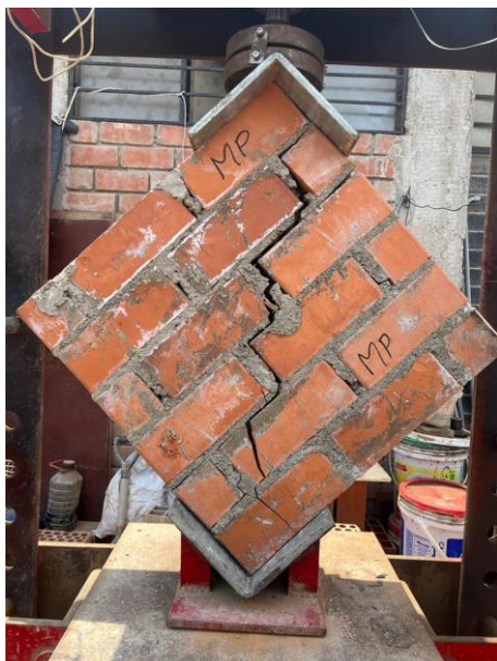
Imagen 99. Murete del 5 % Aserrín calcinado y 20% Concreto Reciclado – Falla por tensión
