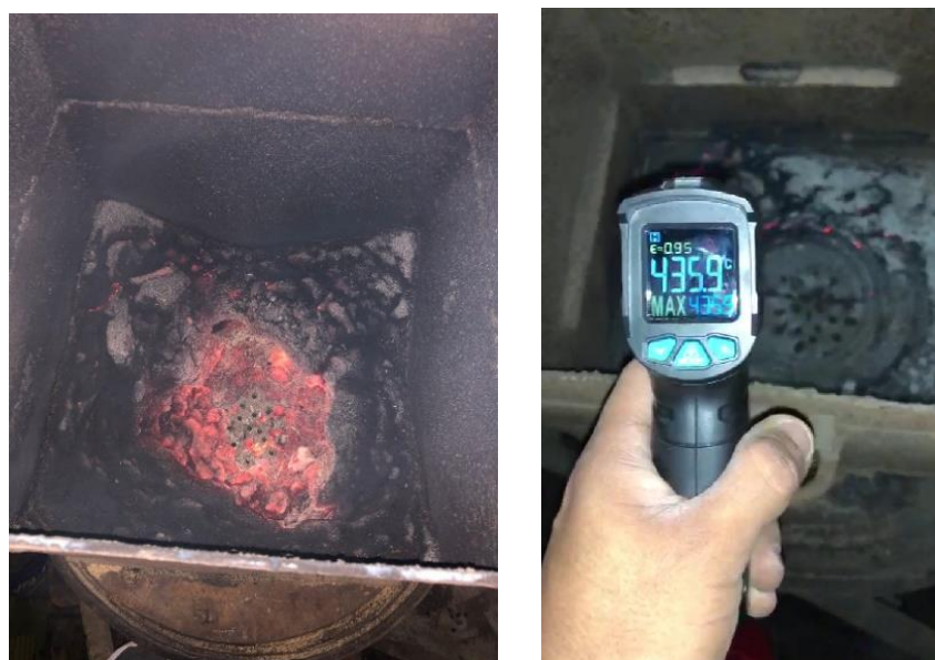
Imagen 26. Quemado principal del aserrín
