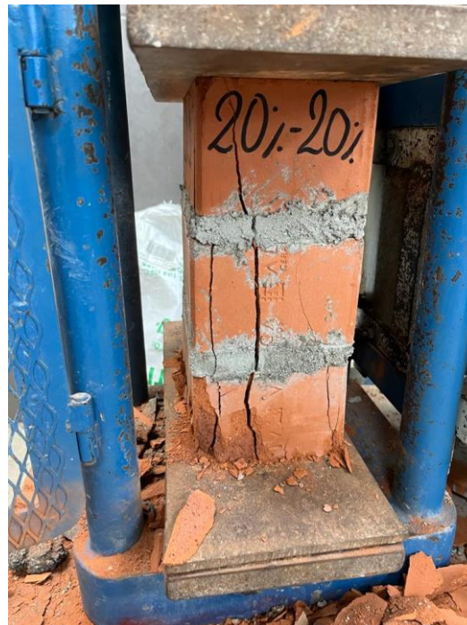
Imagen 90. Pila del 20 % Aserrín calcinado y 20% Concreto Reciclado – Falla por agrietamiento vertical
