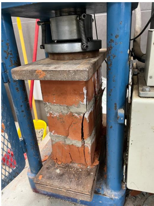
Imagen 81. Pila del 5 % Aserrín calcinado y 20% Concreto Reciclado – Falla por cortante
