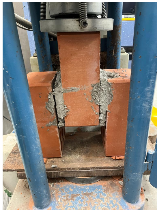
Imagen 74. Adherencia al 20 % Aserrín calcinado y 20% Concreto Reciclado – Falla junta
