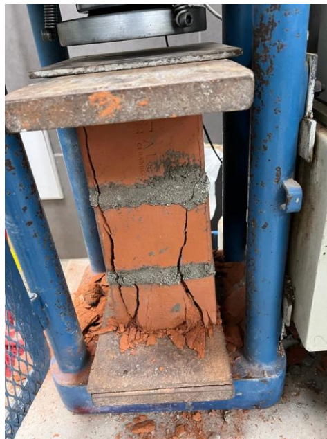
Imagen 82. Pila del 5 % Aserrín calcinado y 30% Concreto Reciclado – Falla por agrietamiento vertical
