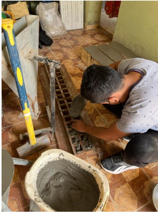
Imagen 46. Llenado de los moldes cúbicos
