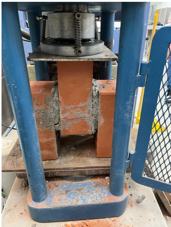
Imagen 75. Adherencia al 20 % Aserrín calcinado y 30% Concreto Reciclado – Falla pieza
