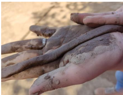
Ilustración 22 Prueba de cinta de barro
