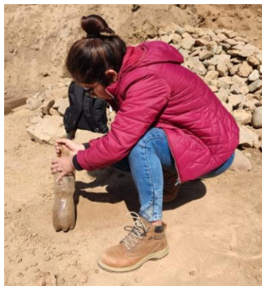
Ilustración 17 Tesista realizando prueba de la botella
