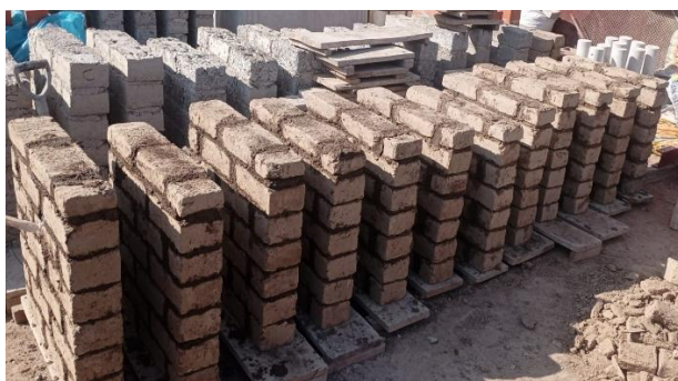
Ilustración 56 Muretes para ensayo de tracción indirecta
