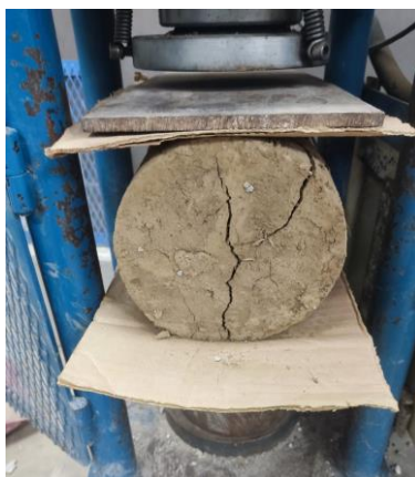
Ilustración 47 Muestra que ha fallado por tracción
