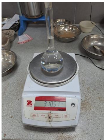
Ilustración 35 Peso de la fiola con agua destilada
