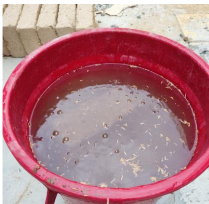
Ilustración 50 Unidad de tierra reforzada sumergida
