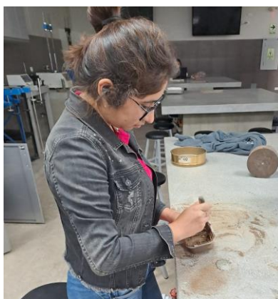
Ilustración 32 Tesista realizando ensayo de LL y LP
