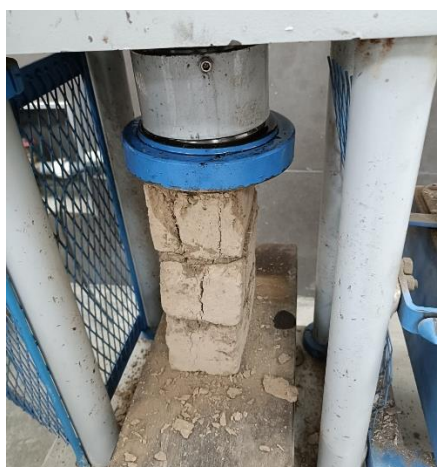
Ilustración 53 Ensayo de compresión en muretes (pilas)
