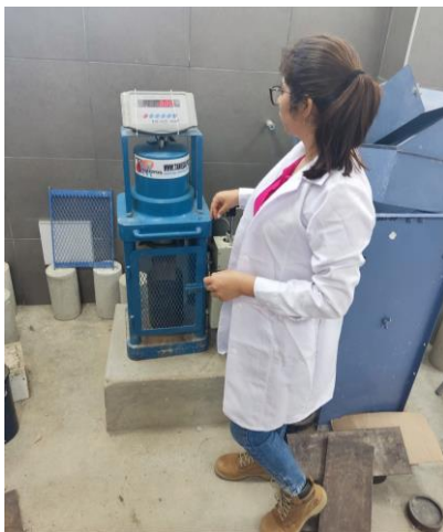
Ilustración 44 Tesista operando la máquina compresora
