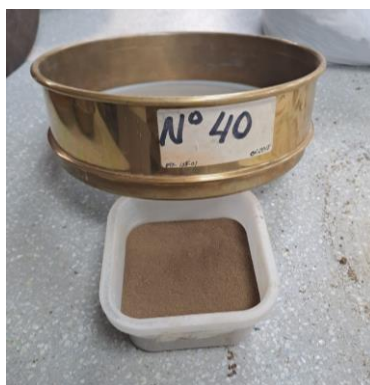
Ilustración 31 Muestra tamizada por la malla N°40
