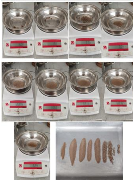
Ilustración 30 Pesos del ensayo granulométrico
