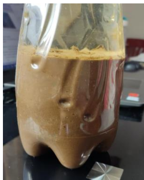
Ilustración 19 Prueba de la botella reposado
