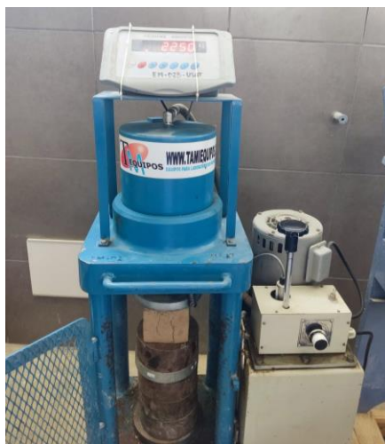
Ilustración 45 Muestra ensayada a compresión
