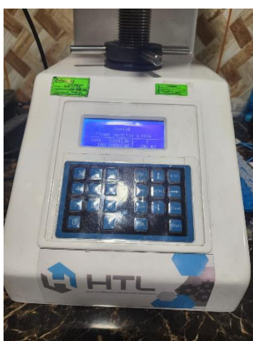
Figura. 11 Medición de la microdureza superficial 24 horas luego del pulido con microdurómetro Vickers (LG, Mitutoyo)
