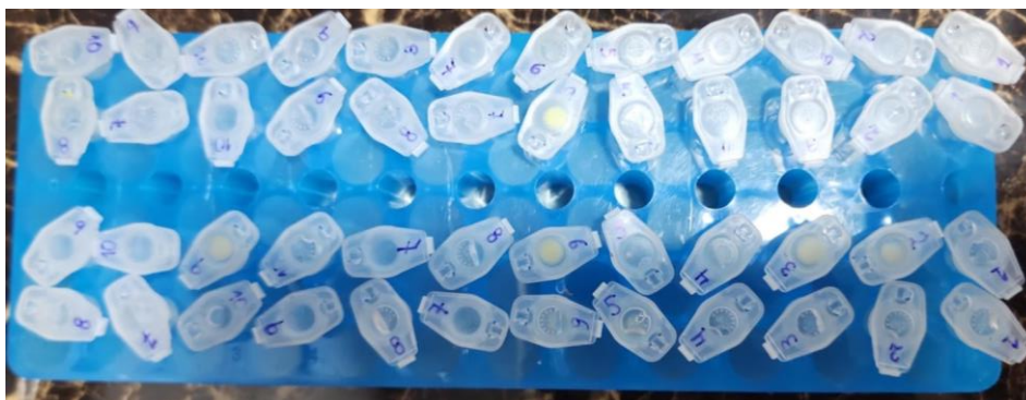
Figura. 7 Almacenamiento de discos de resina durante 24 horas
