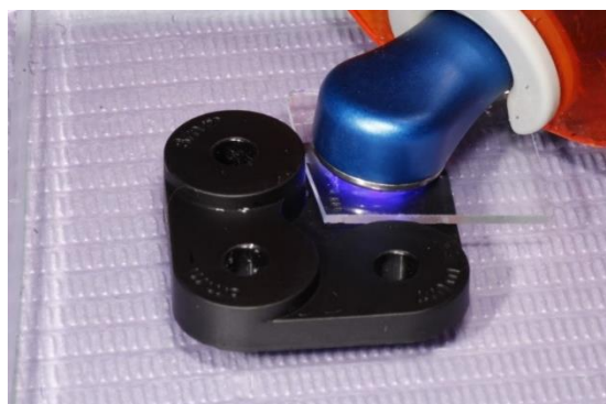
Figura. 3 Resina empaquetada en matriz de plástico y posterior fotopolimerización de resina dentro de matriz.
