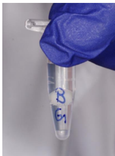
Figura. 5 Colocación de discos de resina en viales con agua destilada y rotulados
