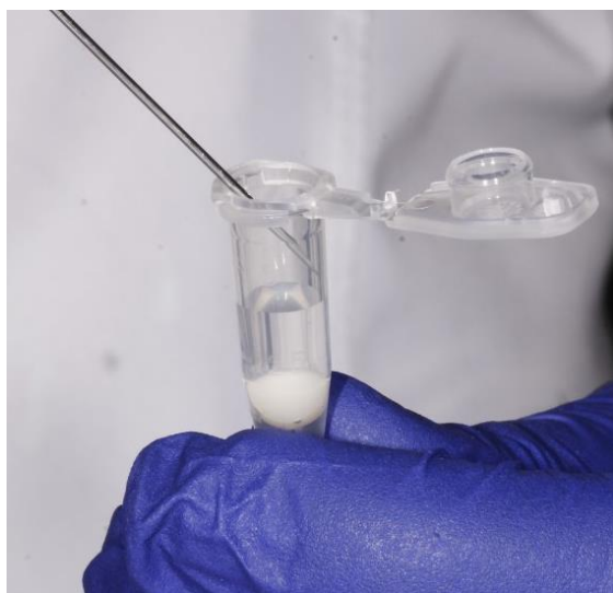
Figura. 5 Colocación de discos de resina en viales con agua destilada y rotulados
