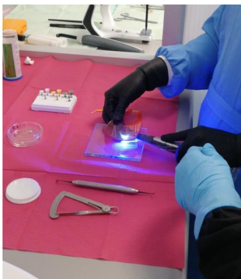
Figura. 1 Preparación de discos de resina
