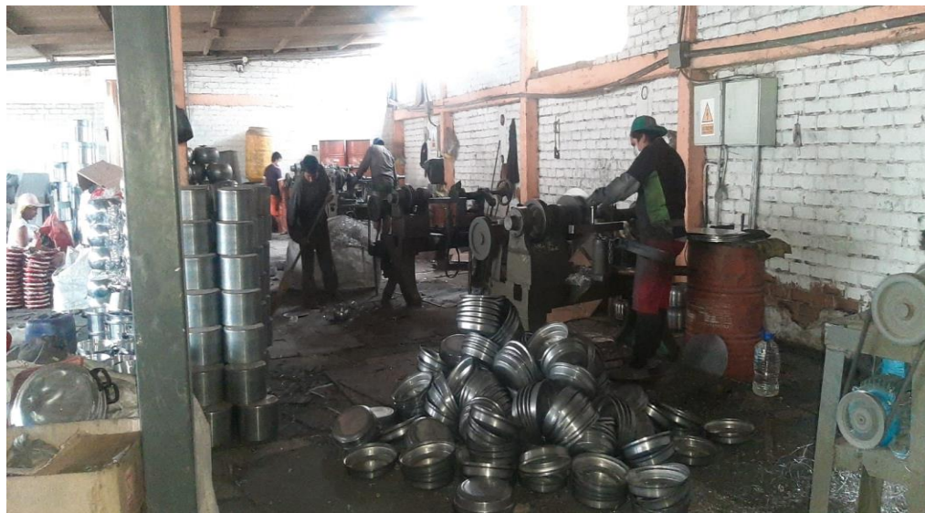
Figura 4. Pasadizos de transitabilidad ocupados
