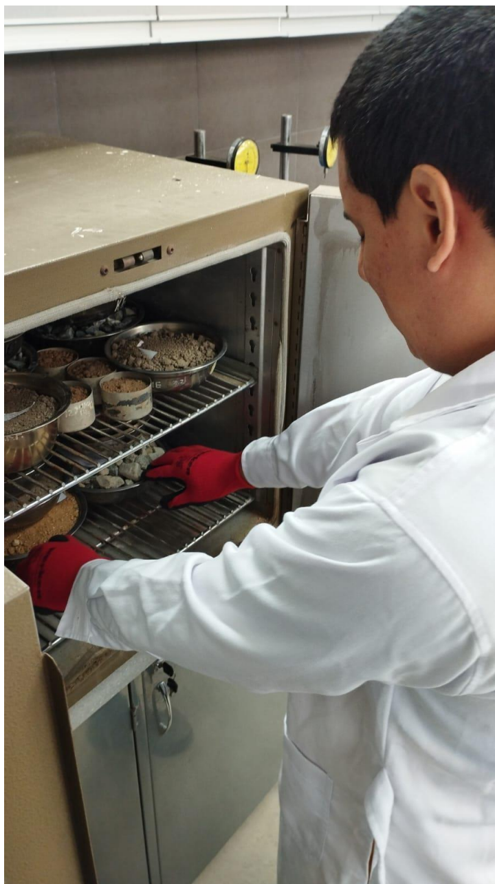
Colocando las muestras al horno para el ensayo de peso específico en el laboratorio de suelos de la USAT
