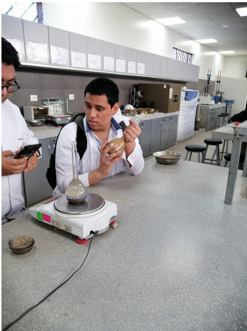
Moviendo la fiola con la muestra de agregado fino adentro para el ensayo de peso específico en el laboratorio de suelos de la USAT
