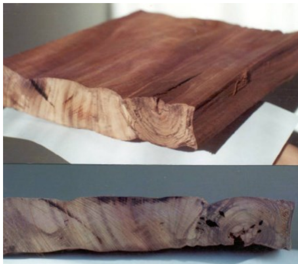
Figura 11. Colapso y rajadura de la madera
