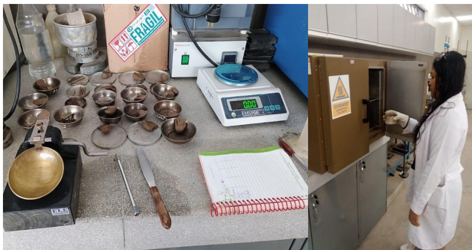
Imagen 17: Muestras pesada y colocadas al horno del ensayo de Atterberg.
