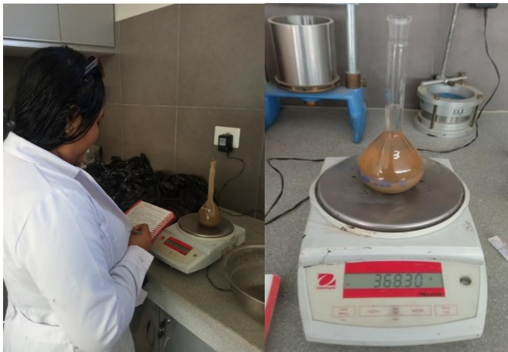
Imagen 19: Peso y colocación de agua destilada para el ensayo.
