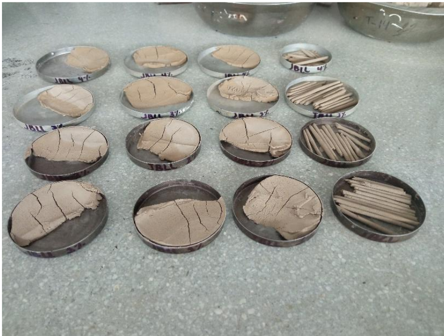
Ilustración 8: Muestras de los ensayos de límites con nanosílice.
