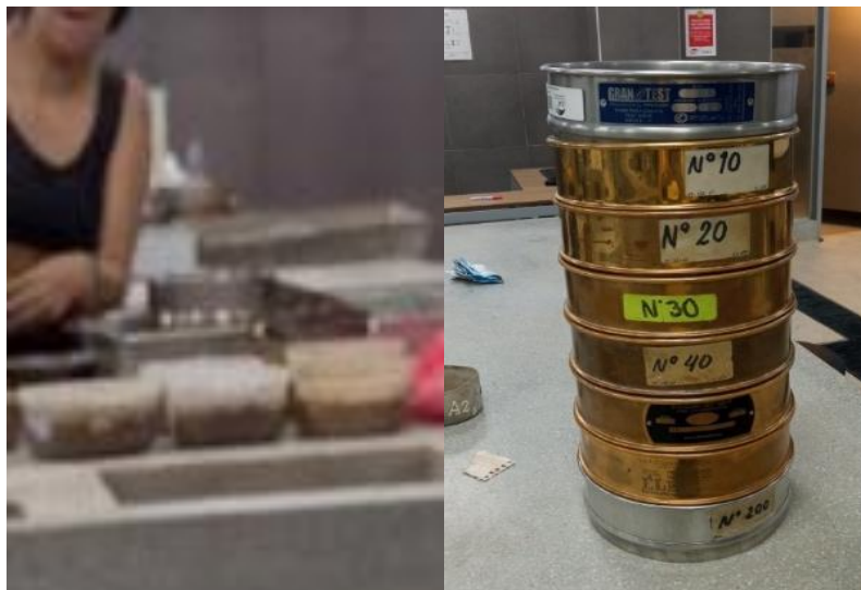
Imagen 13: Materiales que se utilizó para el ensayo de granulometría
