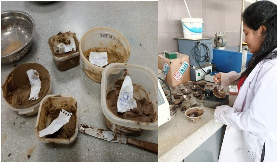
Imagen 15: Colocación en la cuchara de casa grande y extensión de las muestras.
