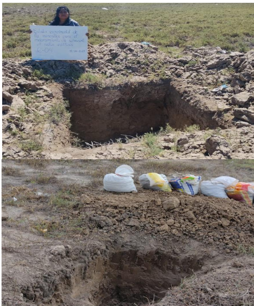
Ilustración 6: Extracción de la muestra de C-04
