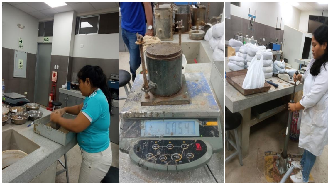
Imagen 20: Saturación y compactación de material para Proctor Modificado.
