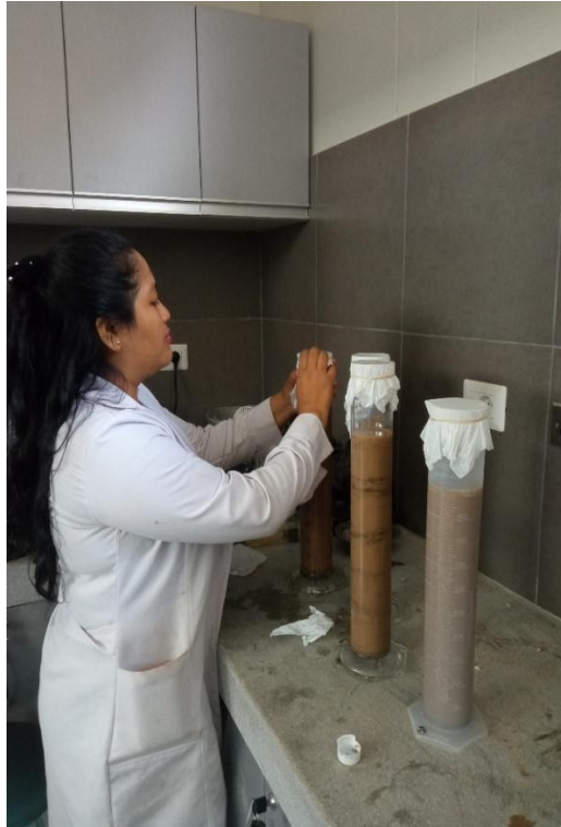
Ilustración 9: Ensayo de Hidrometría.
