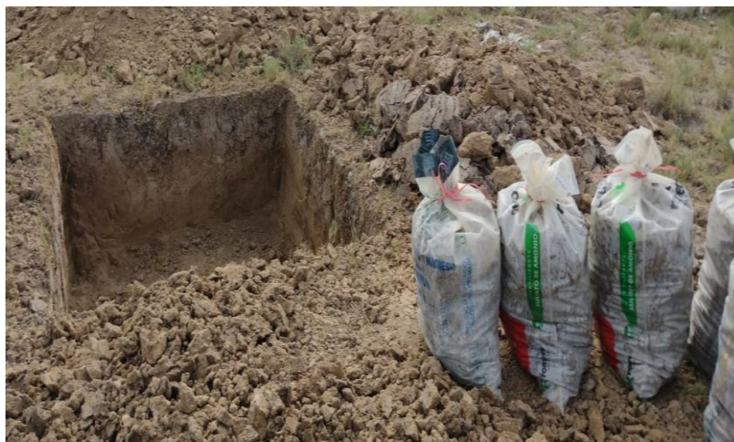
Ilustración 3: Extracción de la muestra de C-01
