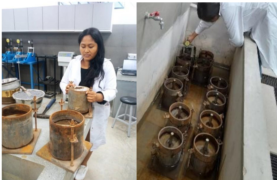
Imagen 22: Aplicación de sobre cargas e hidratación de molde.
