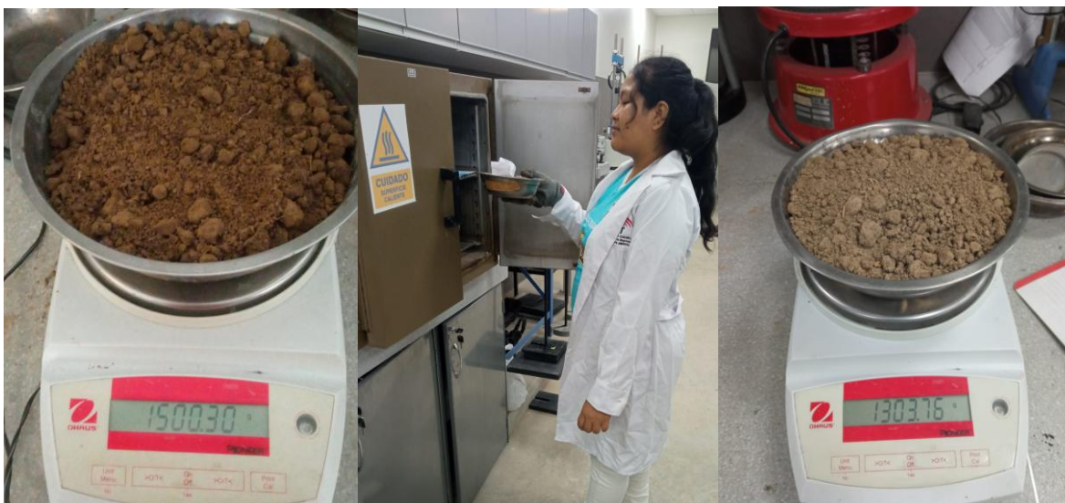
Imagen 12: Muestra el peso de la calicata 04 antes y después de ser sacada del horno.
