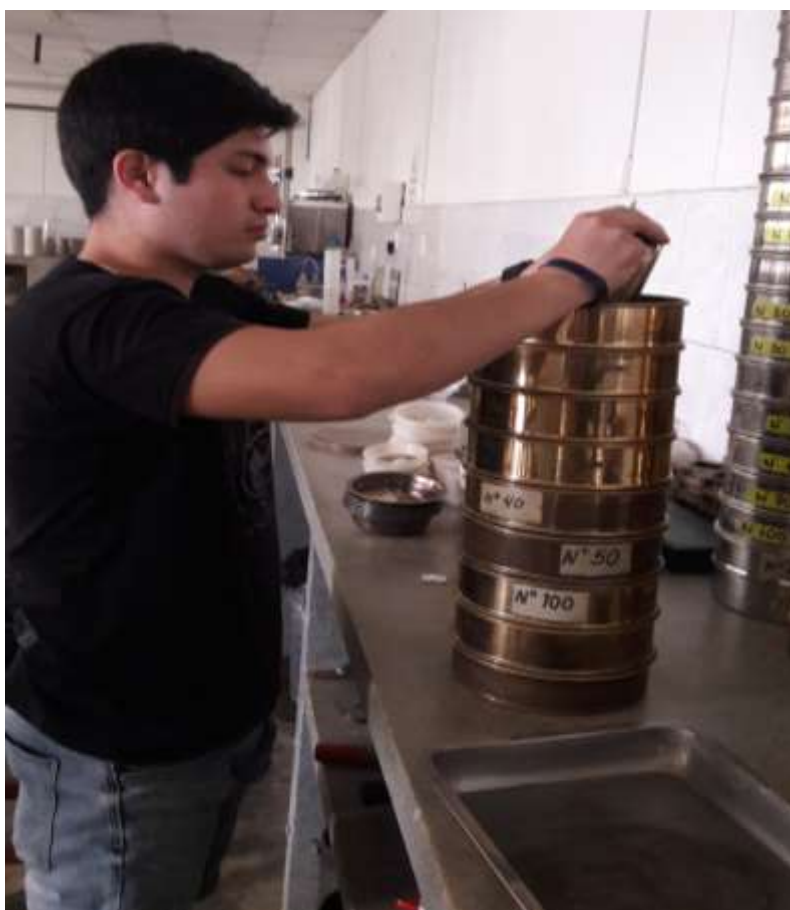
Figura N° 37: Tamizado de muestras de suelo en laboratorio USAT
