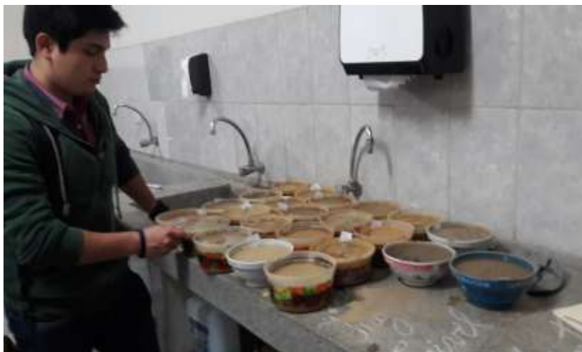
Figura N° 36: Saturación de muestras de suelo en laboratorio USAT
