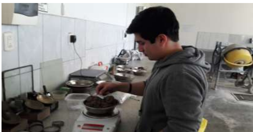
Figura N° 35: Determinación de peso de muestras de suelo en laboratorio USAT
