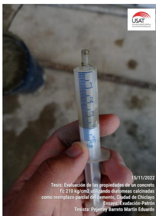
Ilustración No. 29. Extracción del agua exudada
