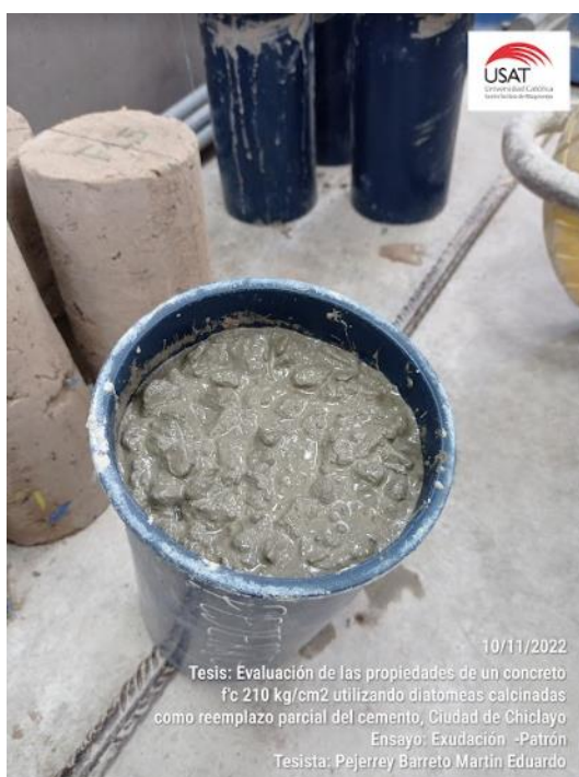
Ilustración No. 28. Exudación del concreto
