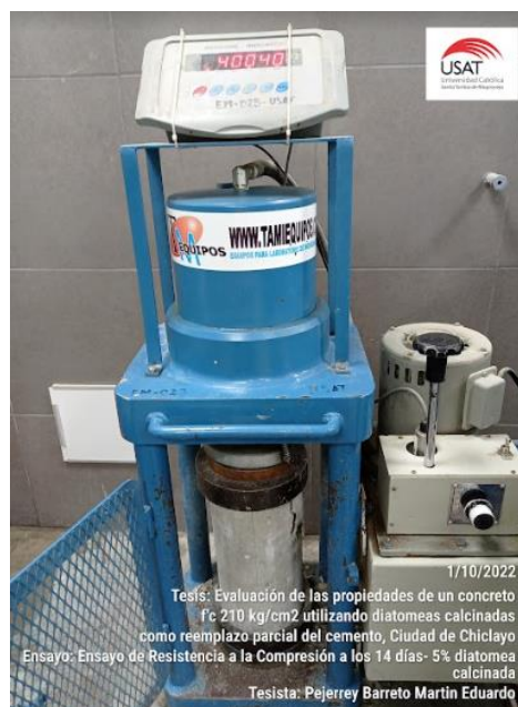
Ilustración No. 42. Resistencia a la compresión- 5% de diatomea
