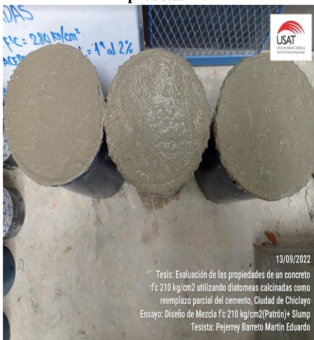
Ilustración No. 23. Enrasado de probetas
