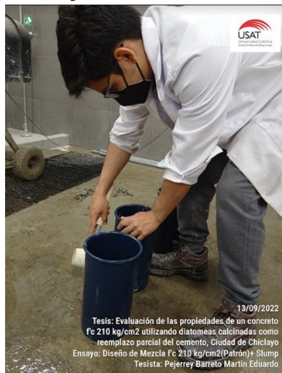
Ilustración No. 22. Compactación de probetas de concreto
