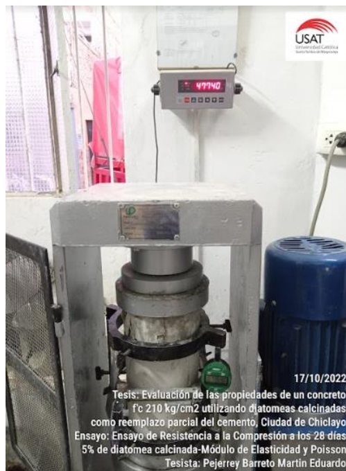
Resistencia a la compresión y Módulo de Elasticidad a los 28d-5% Diatomea Calcinada
