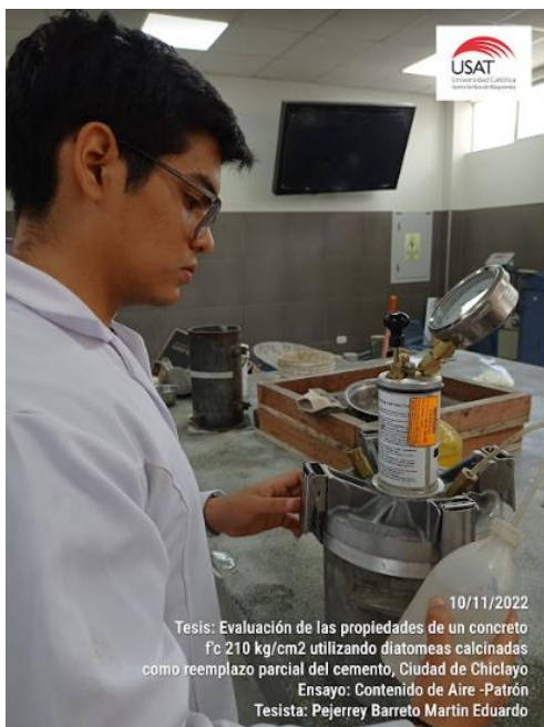
Ilustración No. 39. Contenido de aire del concreto patrón
