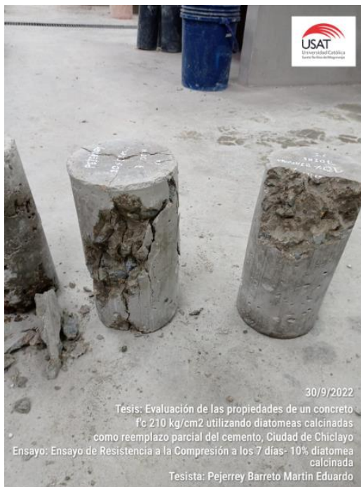
Tipo de Falla-10% diatomea calcinada
