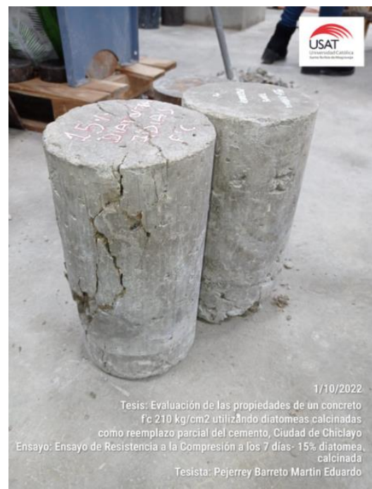
Tipo de Falla-15% diatomea calcinada
