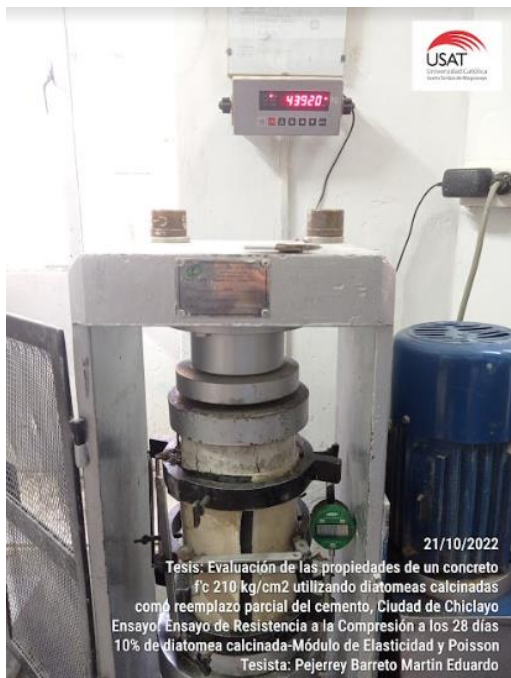
Resistencia a la compresión y Módulo de Elasticidad a los 28d-10% Diatomea Calcinada
