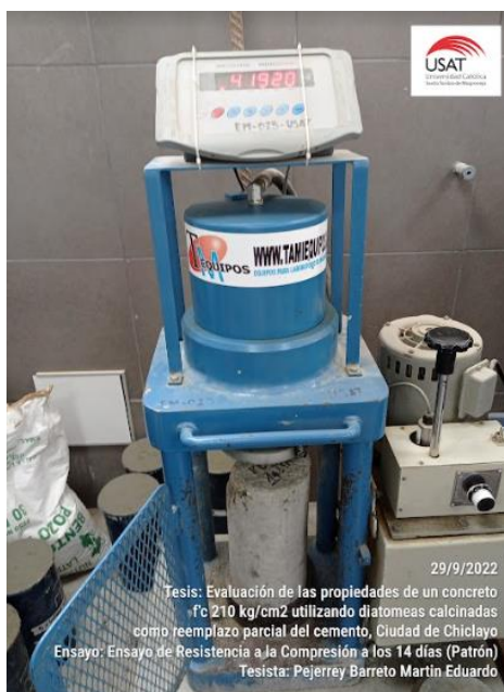
Ilustración No. 41. Resistencia a la compresión-Patrón
