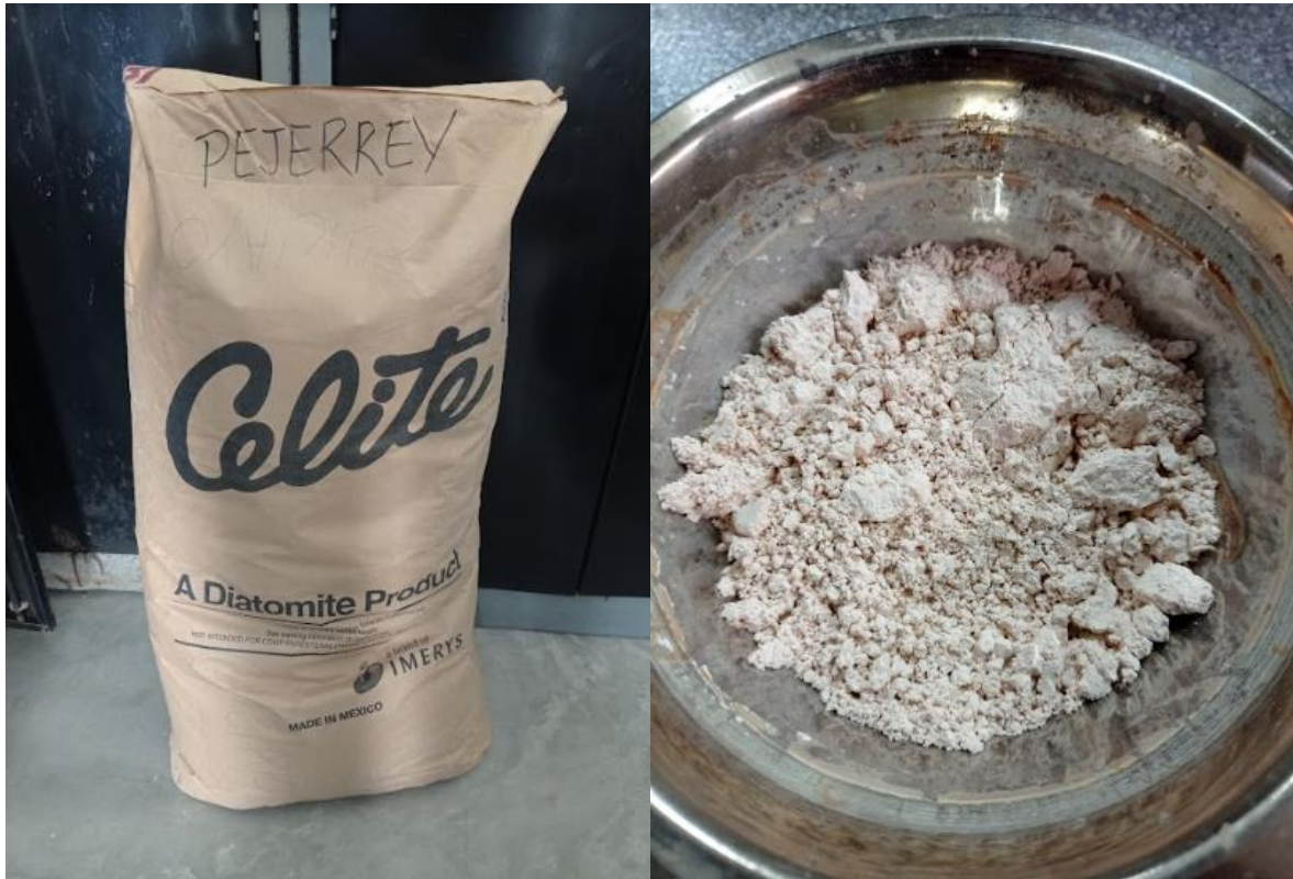
Ilustración No. 9. Diatomea Calcinada
