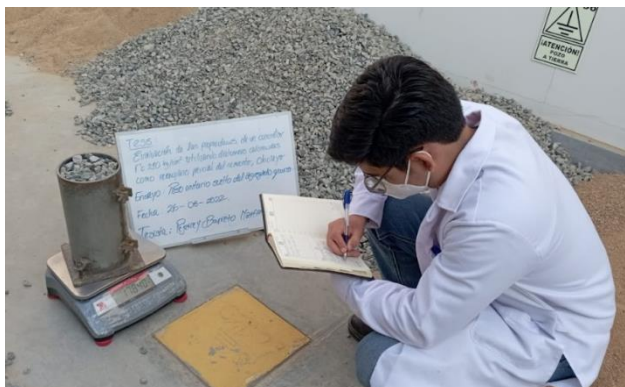
Ilustración No. 18. Peso unitario suelto del agregado grueso
