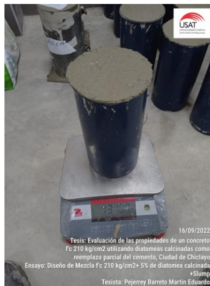
Ilustración No. 31. Peso unitario del concreto-5% de diatomea
