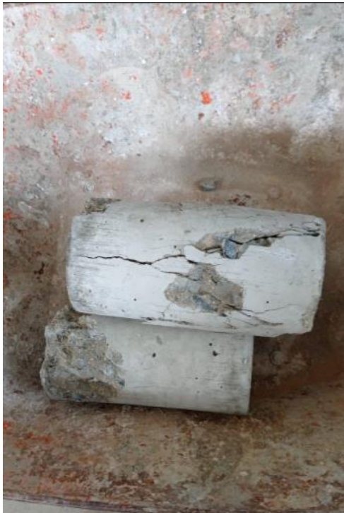
Tipo de Falla-Patrón
