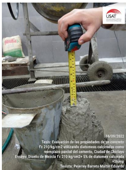
Ilustración No. 26. Medición del asentamiento-5% de diatomea
