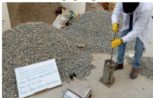
Ilustración No. 19. Peso unitario compactado del agregado grueso
