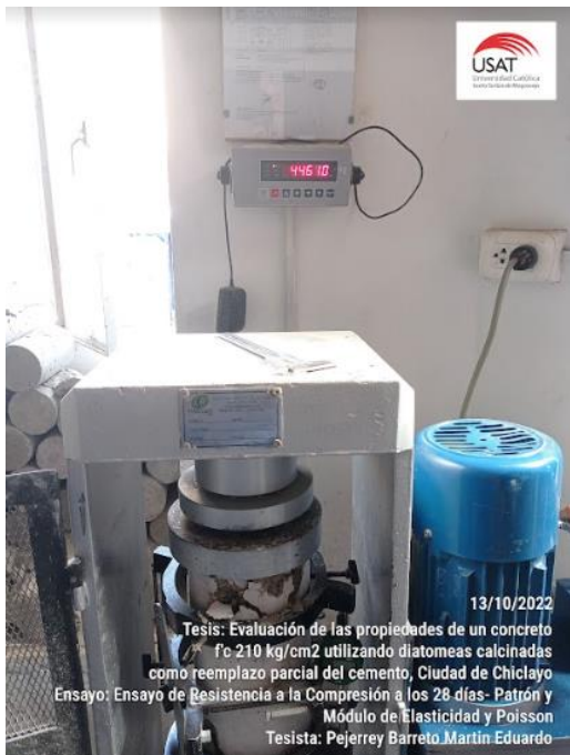
Resistencia a la compresión y Módulo de Elasticidad a los 28d-Patrón
