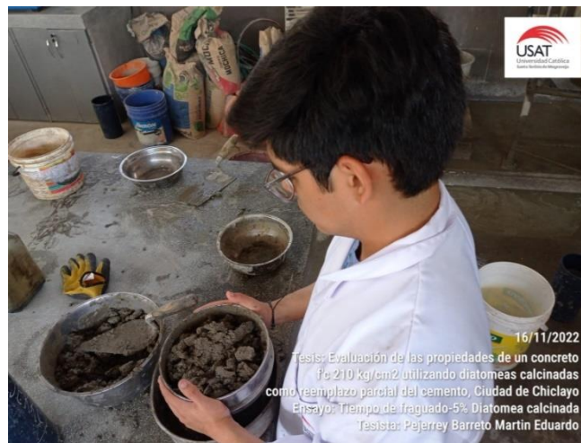
Ilustración No. 37. Tamizado del concreto-5% de diatomea calcinada
