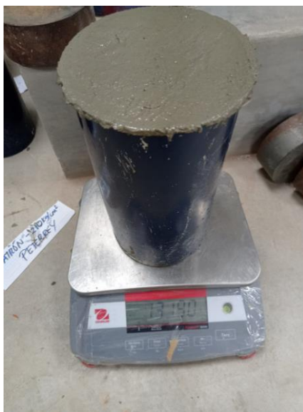
Ilustración No. 30. Peso unitario del concreto patrón
