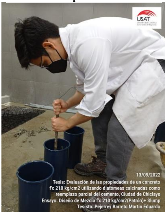
Ilustración No. 21. Varillado en la elaboración de probetas de concreto
