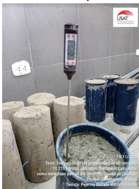
Ilustración No. 32. Temperatura del concreto patrón
