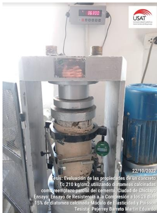
Resistencia a la compresión y Módulo de Elasticidad a los 28d-15% Diatomea Calcinada
