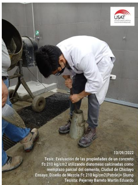
Ilustración No. 25. Varillado por capas en el cono de Abrams
