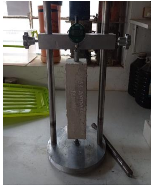
Sulfatos-5% de diatomea calcinada
