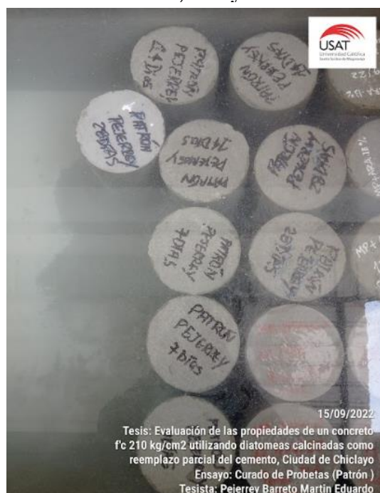
Ilustración No. 24. Curado de probetas a los 7d, 14d y 28d
