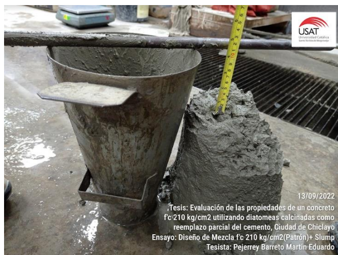
Ilustración No. 27. Medición del asentamiento-Concreto patrón
