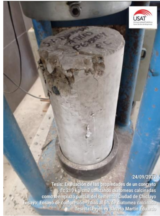
Tipo de Falla-5% de diatomea calcinada
