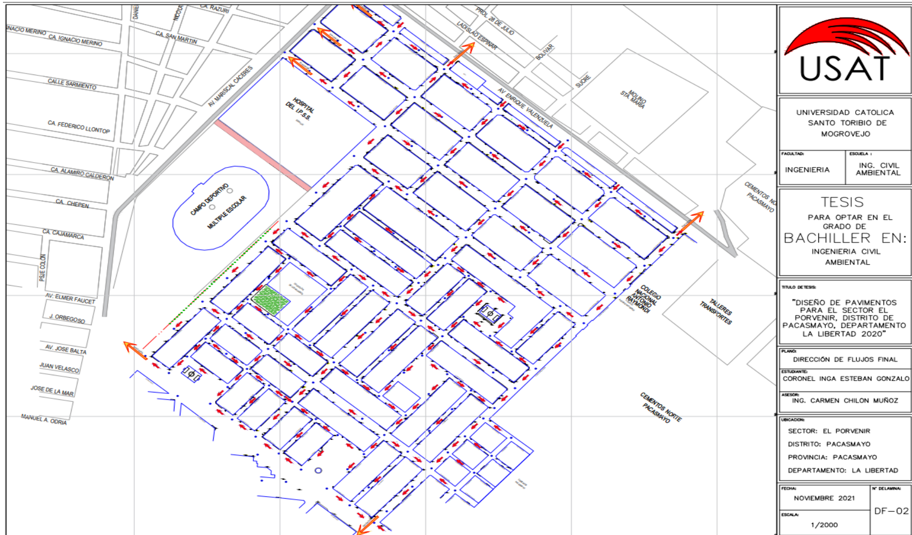
IMAGEN N° 03.09: PLANO DE DIRECCIÓN DE FLUJO DE DRENAJE FLUVIAL FINAL- FUENTE: ELABORACIÓN PROPIA
