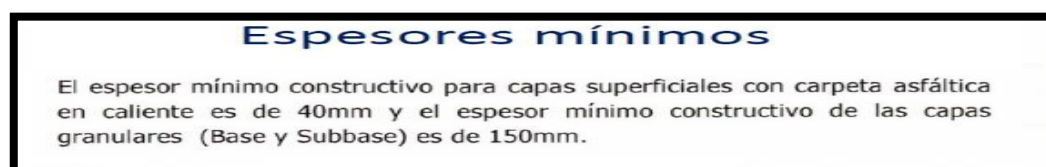
Imagen 50: Espesor mínimo para base y sub base
