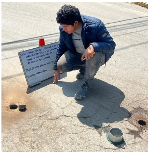
Ilustración 20 Extracción de muestras en la calle Callao.
