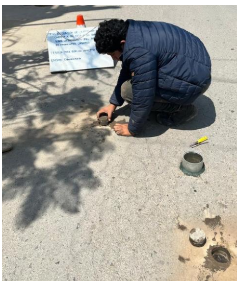
Ilustración 22 Extracción de muestras en la calle La Florida.
