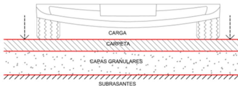
Ilustración 4 Sección de la estructura del pavimento [37].
