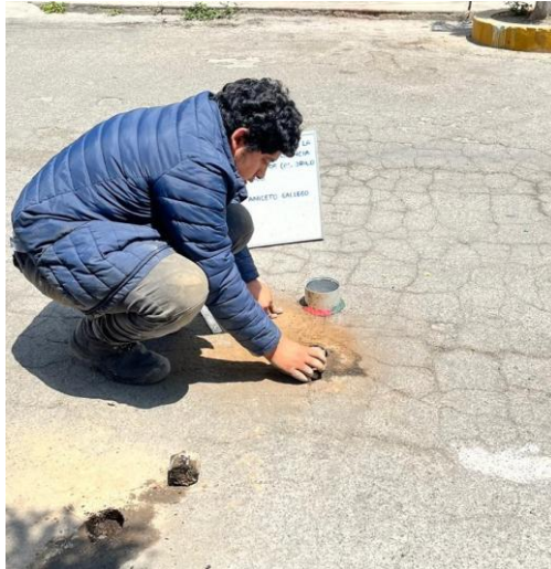
Ilustración 23 Extracción de muestras en la calle Margaritas.
