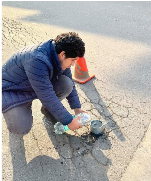
Ilustración 15 Llenado de agua en el aro.
