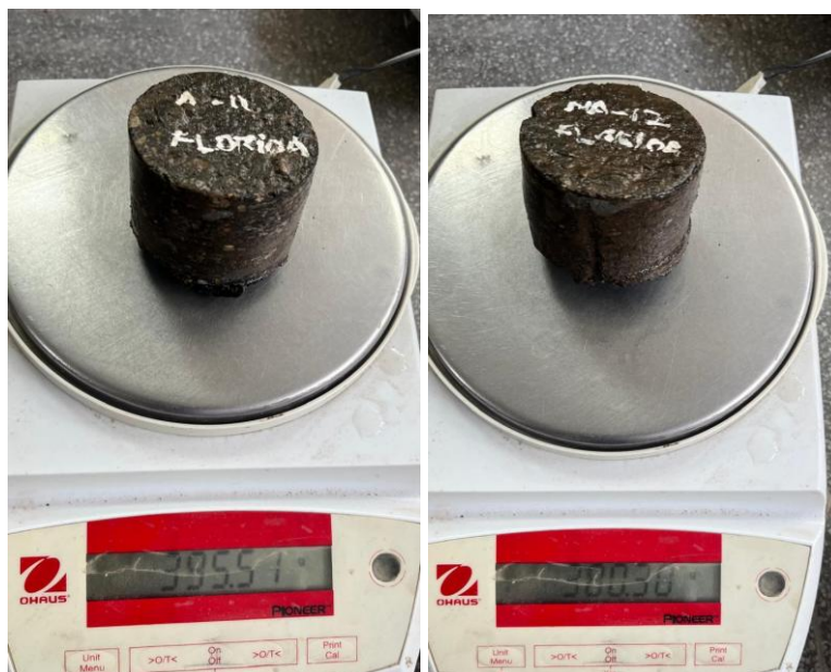
Ilustración 30 Pesos de las muestras saturadas.
