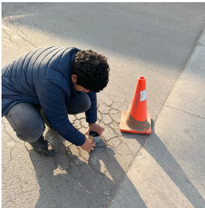
Ilustración 13 Colocación del aro en área de estudio.
