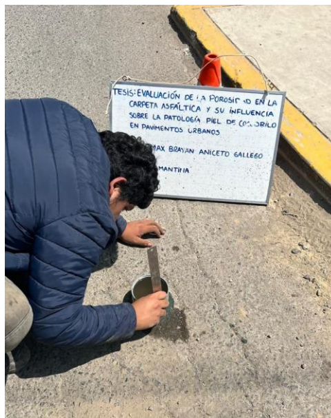
Ilustración 16 Toma de medidas de la altura.
