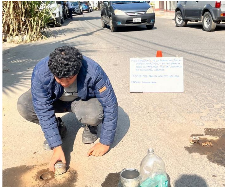
Ilustración 18 Extracción de muestras en la calle Abtao.
