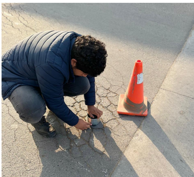
Ilustración 14 Bordeado de aro con plastilina.
