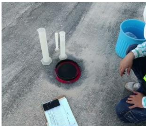
Ilustración 7 Permeabilidad in situ en pavimentos flexibles [41], [42].
