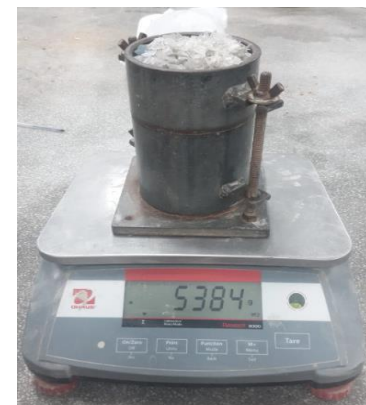
Peso del molde con el material contenido
