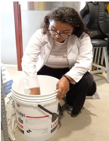
Preparación de la solución saturada de sulfato de magnesio
