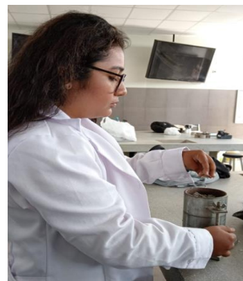
Material contenido en el molde Proctor
