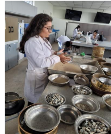
Tamizado manual de los agregados
