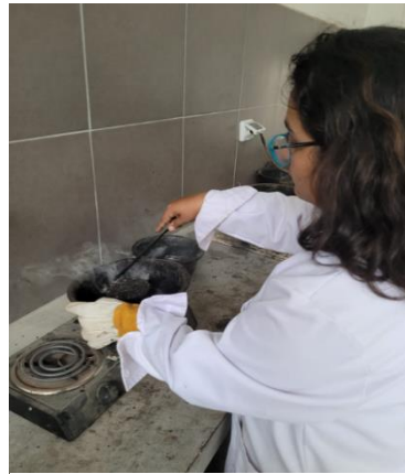
Mezcla de agregados y cemento asfáltico
