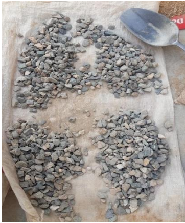
Selección del material mediante el cuarteo
