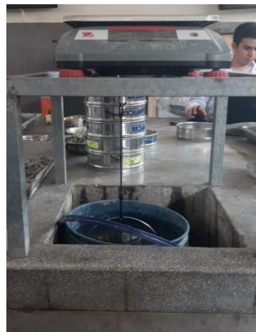
Muestra sumergida en la canastilla de alambre
