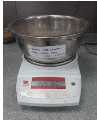
Muestra seca de agregado fino
