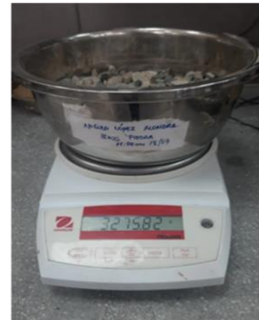
Muestra seca de agregado grueso
