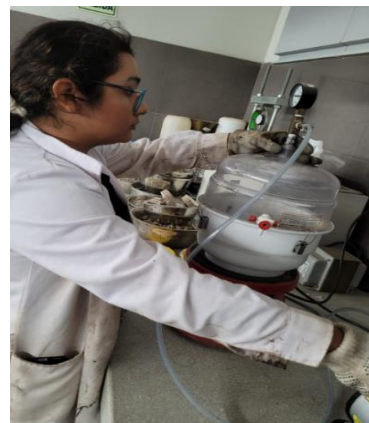
Vacío parcial del aire
