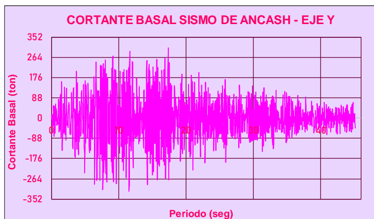
Figura 185: Cortante vs tiempo del sismo de Ancash en la dirección Y – bloque B reforzado
