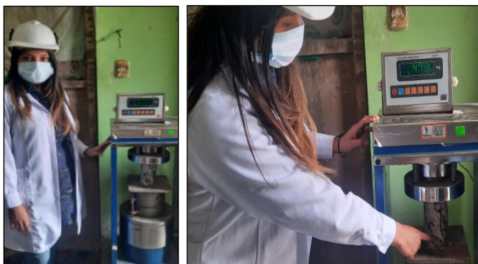
Figura 18: Ensayo de compresión de la muestra D-5 - Bloque A
