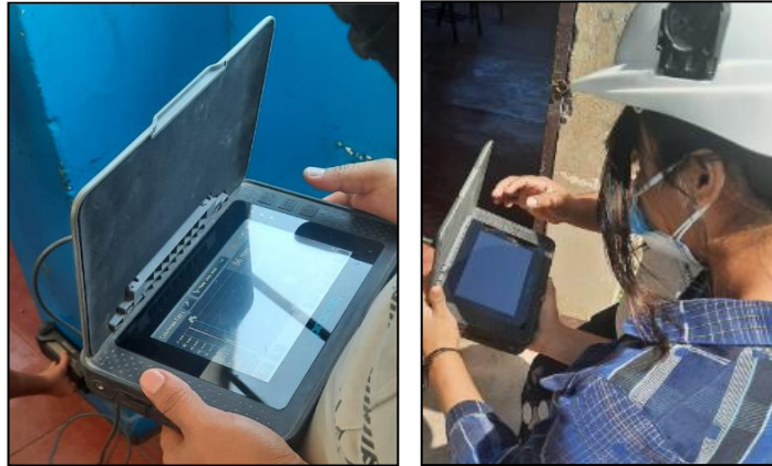
Figura 5: Escáner de acero de refuerzo (Profómetro PM-650 de marca PROCEQ)
