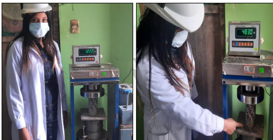
Figura 23: Ensayo de compresión de la muestra D-4 - Bloque B
