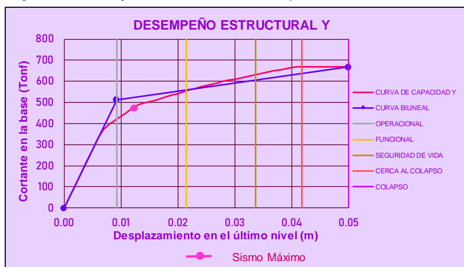
Figura 158: Desempeño sísmico del módulo A reforzado en la dirección Y
