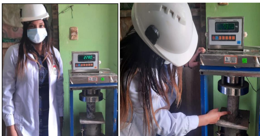
Figura 24: Ensayo de compresión de la muestra D-8 - Bloque B
