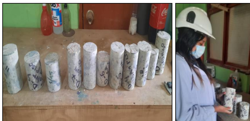
Figura 21: Muestras de diamantinas extraídas del Bloque B
