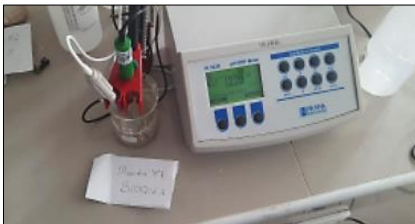
Figura 17: Medición del pH de la muestra N°1 – Bloque A
