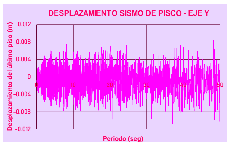
Figura 122: Desplazamiento vs tiempo del sismo de Pisco en la dirección Y – bloque B
