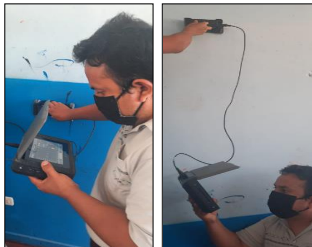
Figura 9: Escaneo del acero de la columna confinada (C5)
