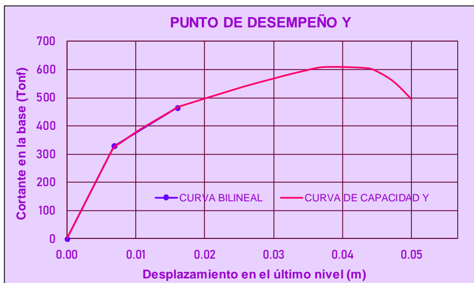
Figura 75: Punto de desempeño del módulo A para la dirección Y
