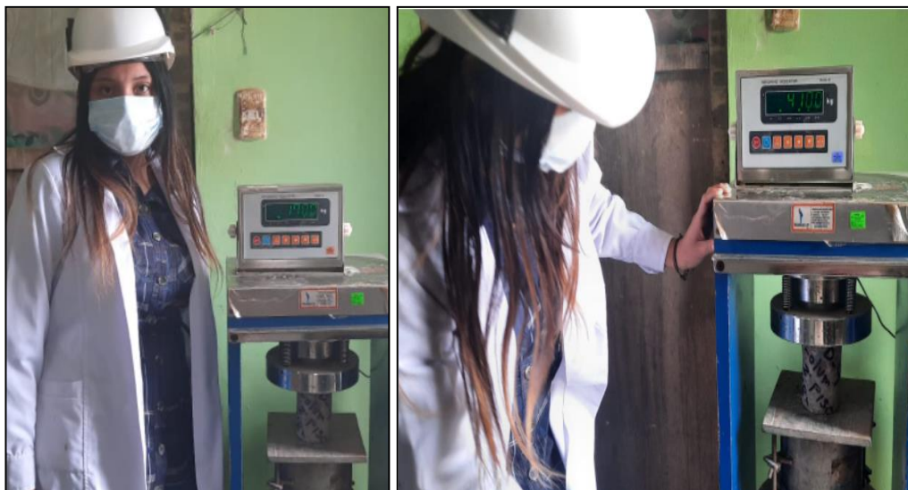
Figura 25: Ensayo de compresión de la muestra D-9 - Bloque B
