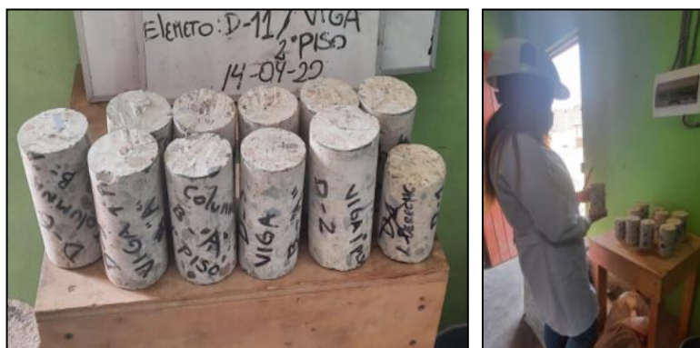
Figura 16: Muestras de diamantinas extraídas del Bloque A
