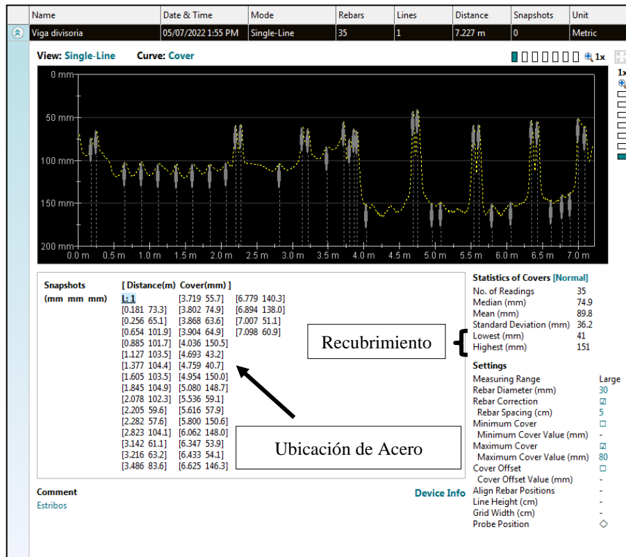
Figura 24: Resultados del escaneo del acero transversal de la viga (Y1)
