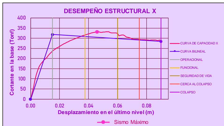
Figura 157: Desempeño sísmico del módulo A reforzado en la dirección X
