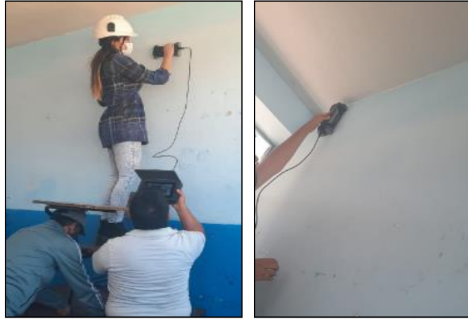
Figura 11: Escaneo del acero de la viga confinada (Y1)
