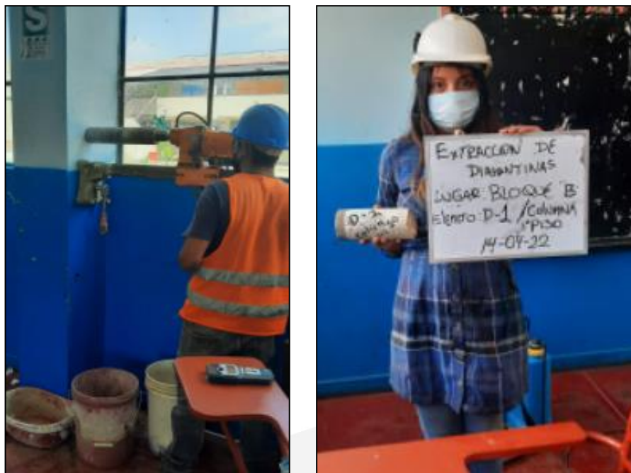
Figura 12: Extracción de la muestra D-1– Bloque B
