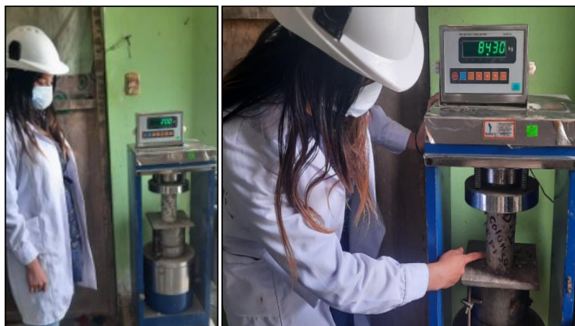
Figura 22: Ensayo de compresión de la muestra D-1 - Bloque B
