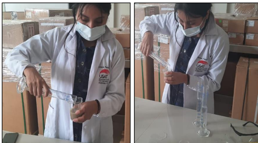
Figura 13: Colocación del agua destilada en las muestras de concreto pulverizadas
