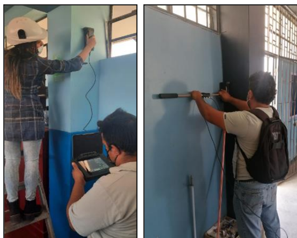
Figura 7: Escaneo del acero de la columna (C2)
