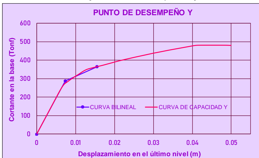
Figura 155: Punto de desempeño del módulo B reforzado para la dirección Y
