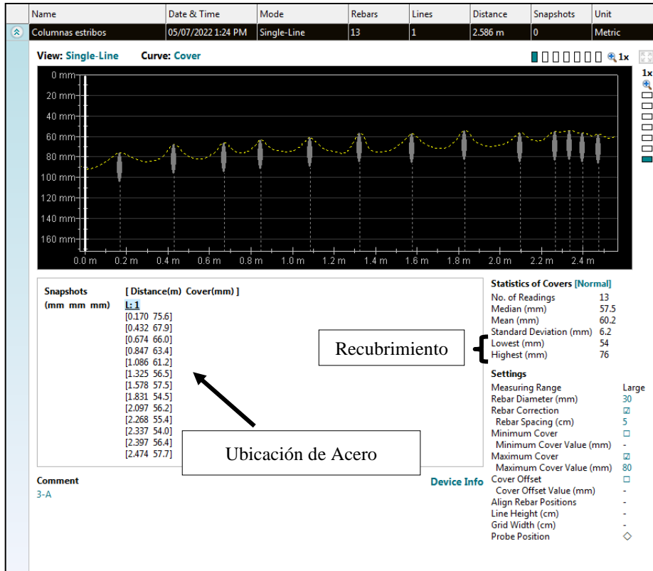
Figura 14: Resultados del escaneo del acero transversal de la columna (C1)
