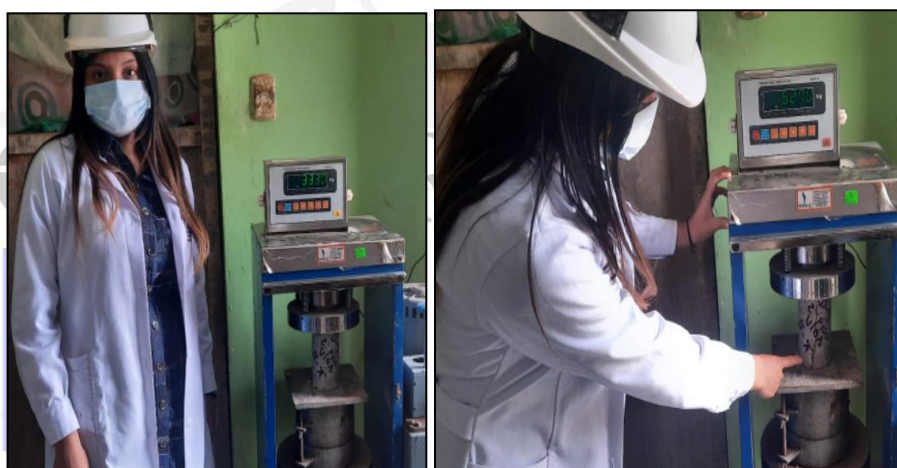
Figura 20: Ensayo de compresión de la muestra D-9 - Bloque A
