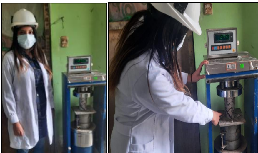
Figura 19: Ensayo de compresión de la muestra D-8 - Bloque A
