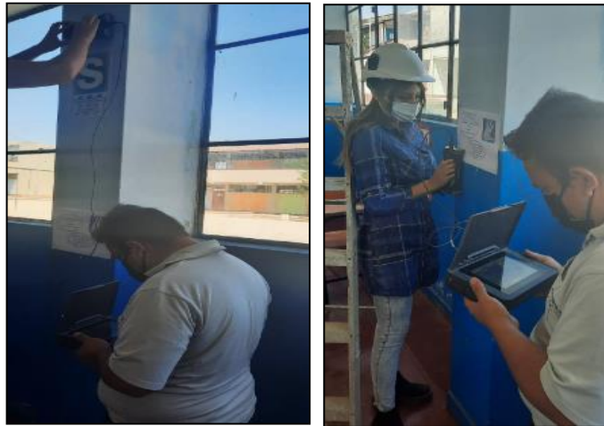
Figura 8: Escaneo del acero de la columna (C4)
