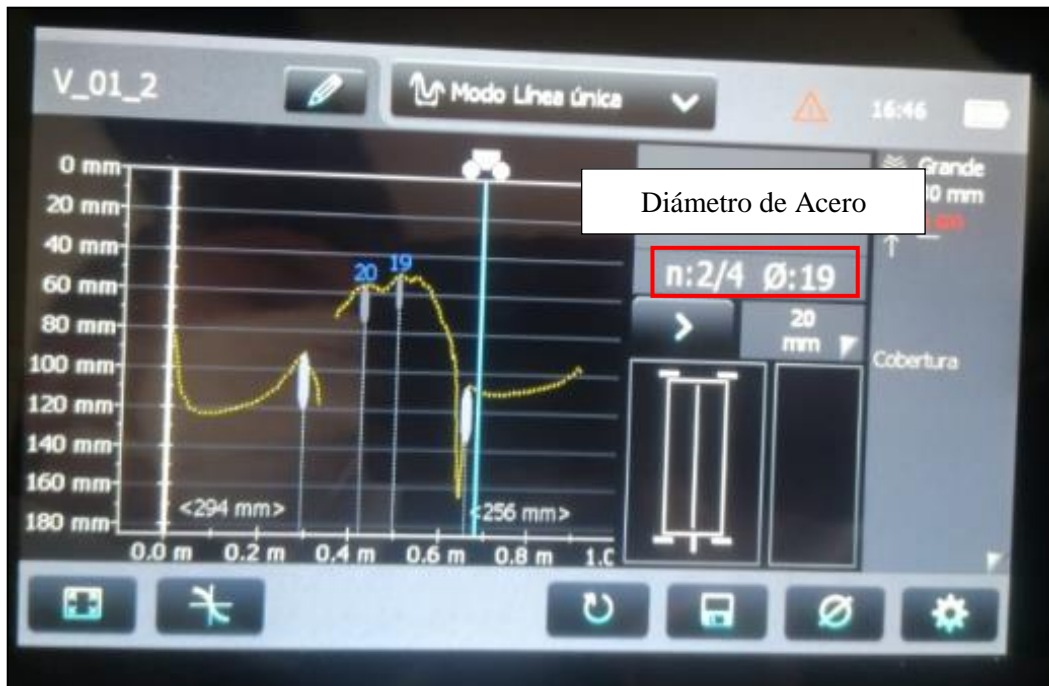
Figura 35: Diámetro del acero longitudinal de la viga (Y2)
