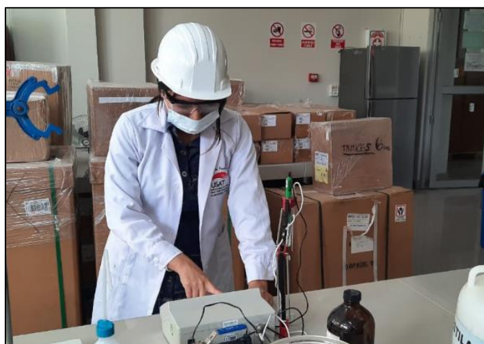
Figura 16: Utilización del Peachímetro para la medición del pH de las muestras
