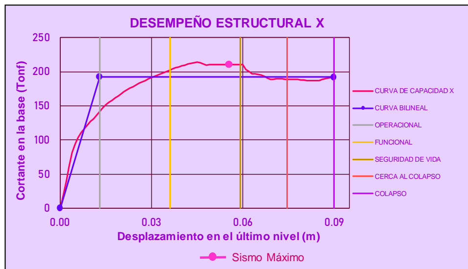
Figura 159: Desempeño sísmico del módulo B reforzado en la dirección X
