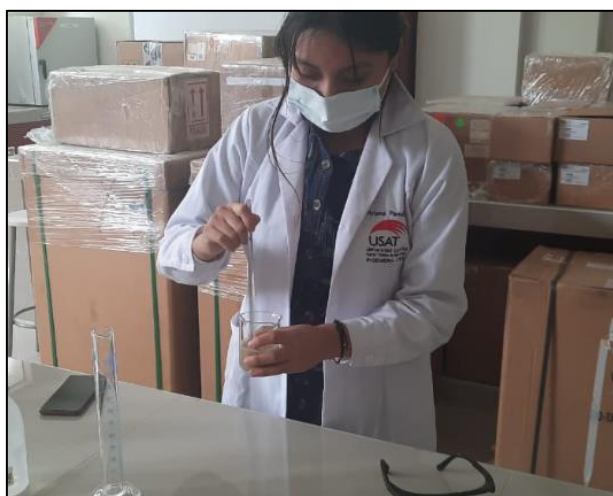
Figura 14: Mezclado del agua destilada con las muestras de concreto pulverizado
