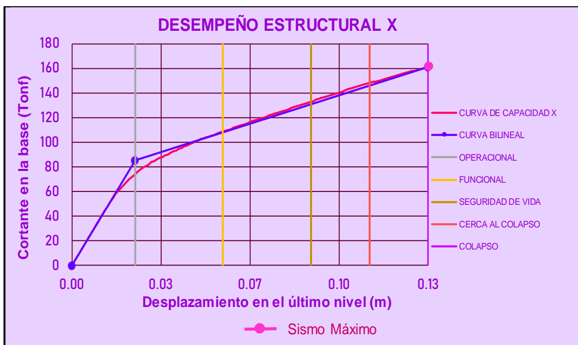
Figura 81: Desempeño sísmico del módulo A en la dirección X
