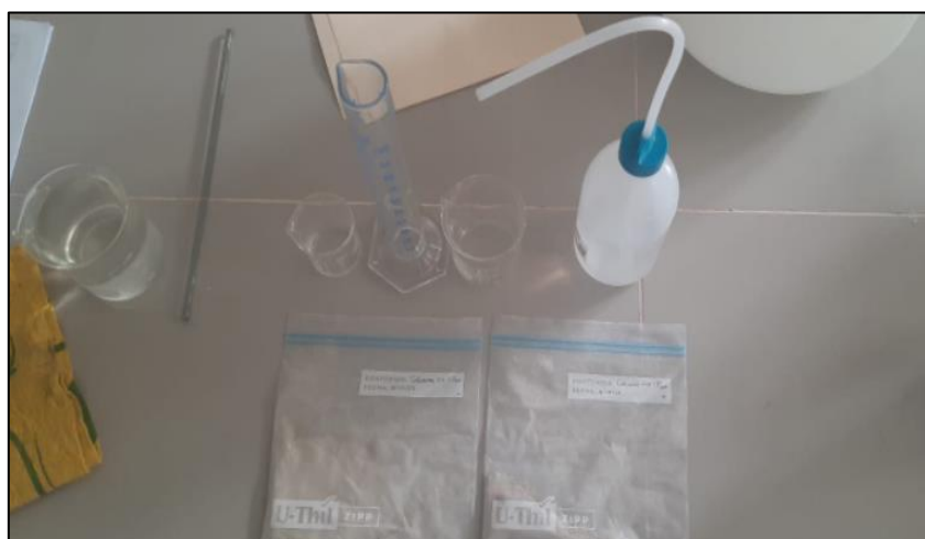
Figura 7: Materiales utilizados para el ensayo de carbonatación del concreto
