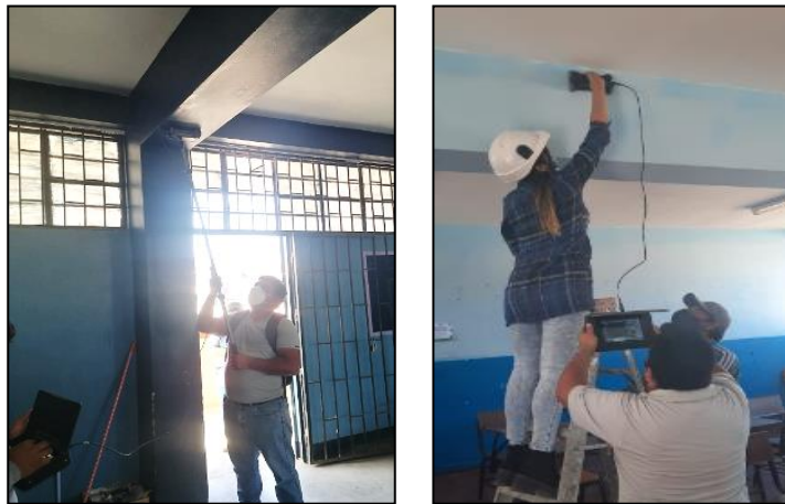
Figura 12: Escaneo del acero de la viga (Y2)
