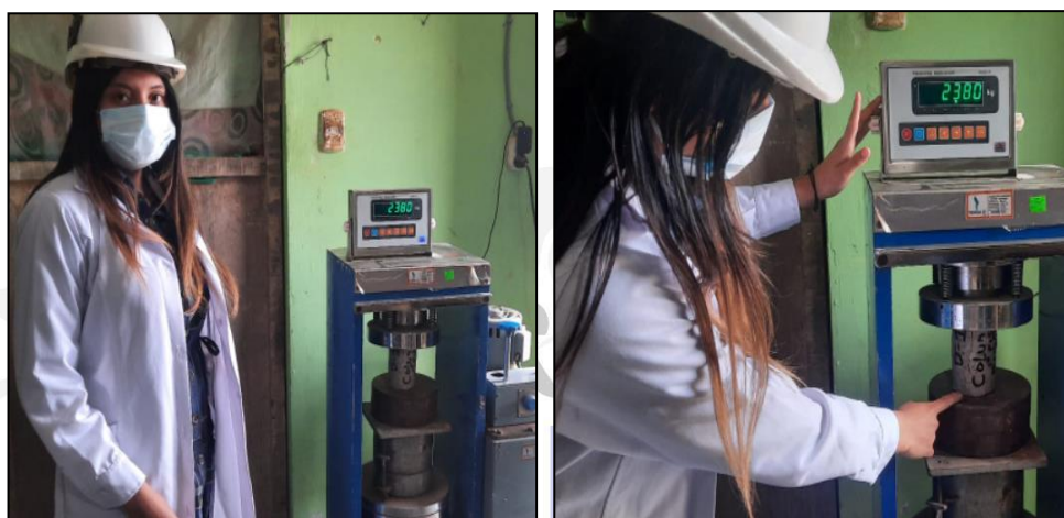
Figura 17: Ensayo de compresión de la muestra D-1 - Bloque A
