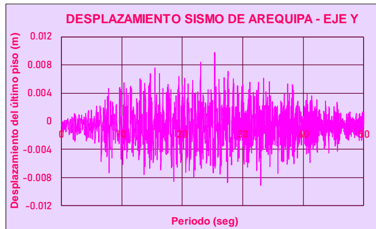
Figura 118: Desplazamiento vs tiempo del sismo de Arequipa en la dirección Y – bloque B
