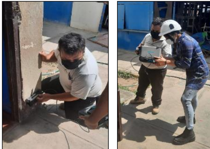
Figura 6: Escaneo del acero de la columna (C1)
