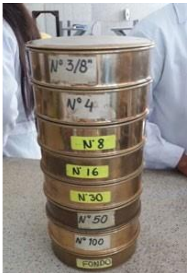
Figura 4: Tamices para Agregado Fino (Falta N°200).
