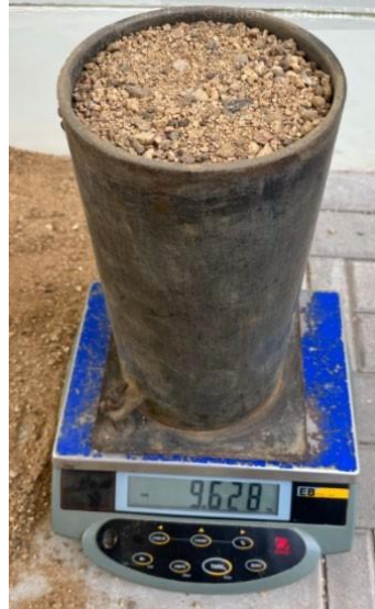
Figura 35: Peso Unitario Compactado Húmedo 2 de Agregado Fino.
