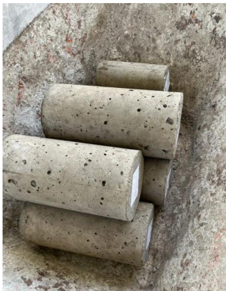
Figura 118. Probetas con poros.
