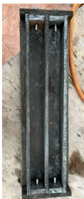
Figura 93. Moldes de viguetas.
