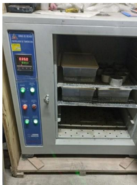
Figura 109. Curado de viguetas en horno a 35°C.
