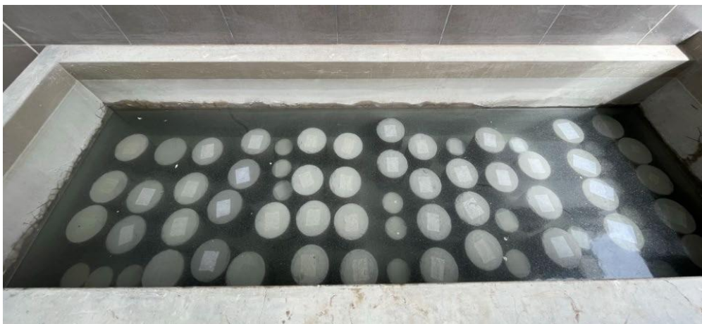
Figura 69: Curado de probetas en fosa externa.
