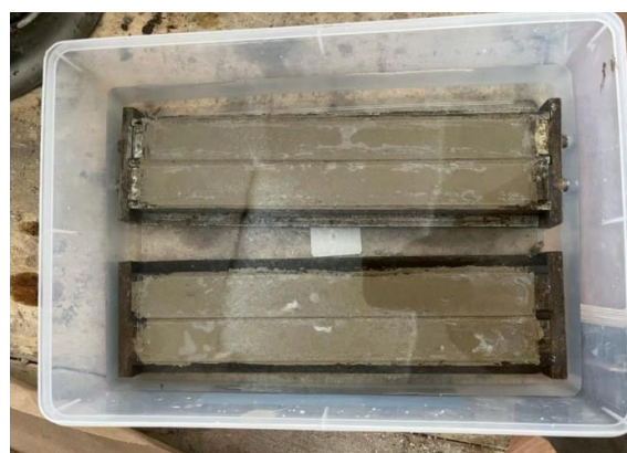
Figura 107. Viguetas con placas de vidrio y sumergidas.
