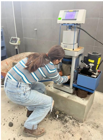
Figura 72: Retiro de probeta rota.
