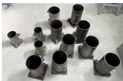
Figura 58: Moldes de 15 cm de diámetro y 30 cm de altura y de 10 cm de diámetro y 20 cm de altura.
