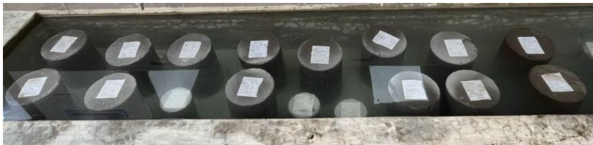
Figura 70: Curado de probetas en fosa interna.
