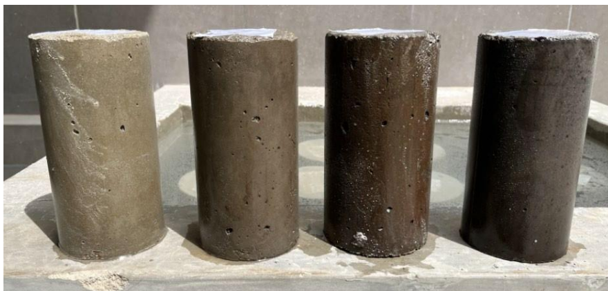
Figura 85. Comparación de probetas de 10 cm de diámetro con 20 cm de altura ( f'c 175 – E.A. 0%, 10%, 20% y 30%).
