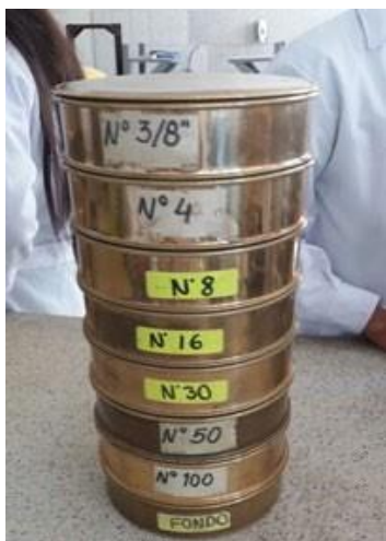
Figura 4: Tamices para Agregado Fino (Falta N°200).
