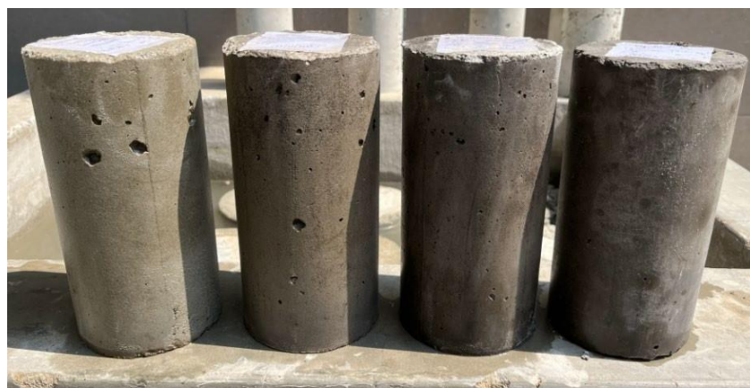
Figura 86. Comparación de probetas de 10 cm de diámetro con 20 cm de altura ( f'c 210 – E.A. 0%, 10%, 20% y 30%).
