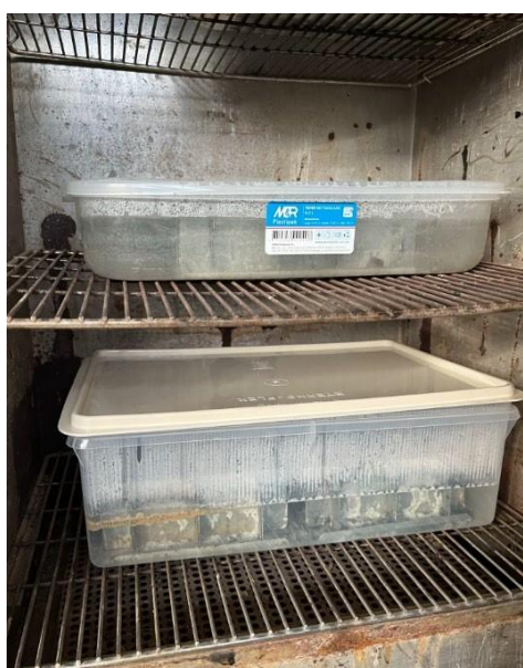
Figura 104. Curado de cubos en horno a 35 °C.
