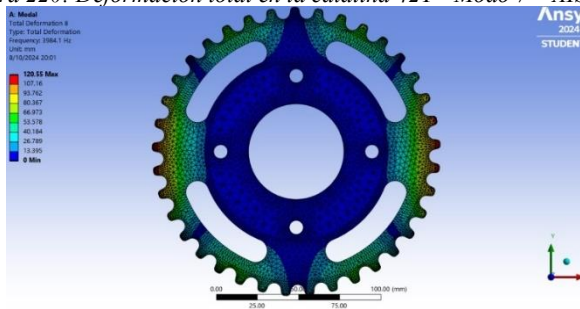
Figura 220: Deformación total en la catalina 42T - Modo 7 – AISI 1045
