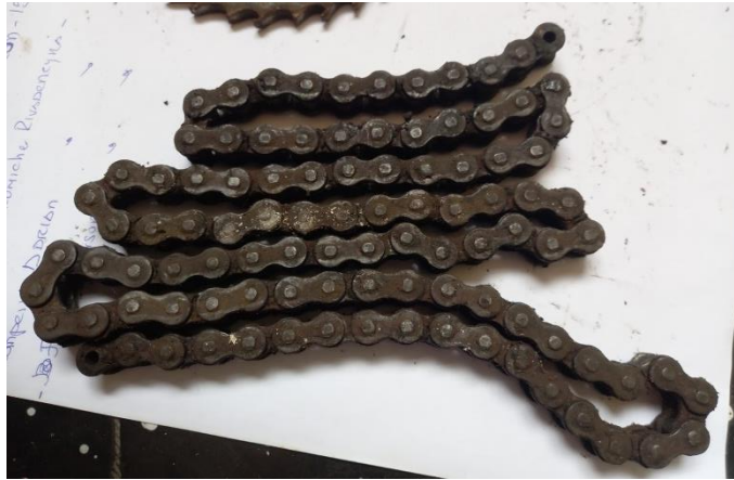
Figura 111: Cadena de rodillos 428H, parte no doblada
