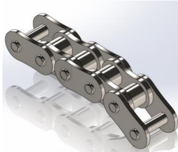
Figura 133: Cadena 428H en SolidWorks con características de tabla 28
