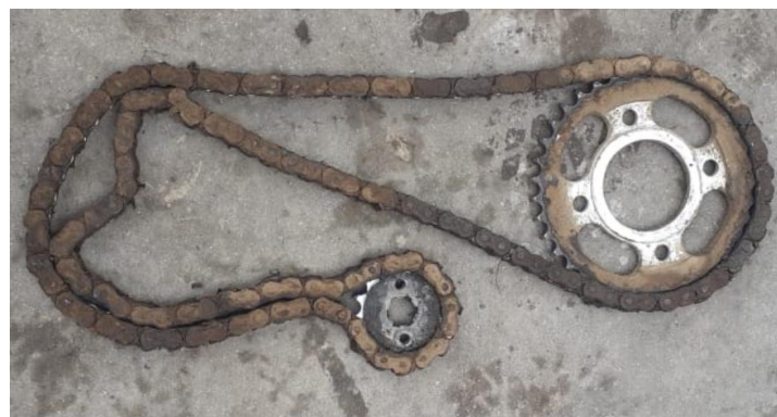
Figura 17: Sistema de transmisión al final de su vida útil (Catalina 37 T – Piñón 15 – Cadena 428H)
