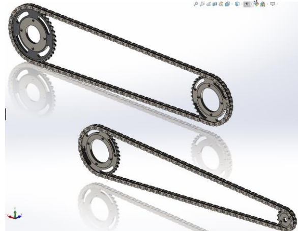
Figura 41: Sistema de arrastre del mototaxi WX 150 en el software SolidWorks
