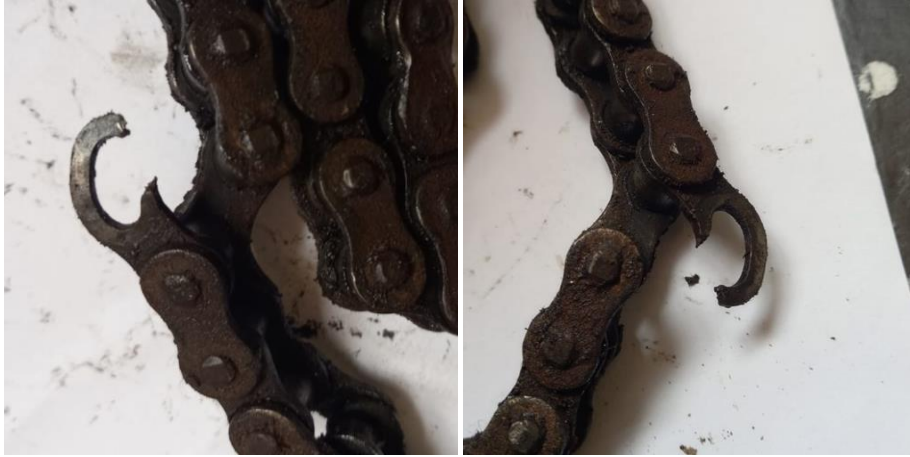
Figura 110: Roller link plate fracturado de la cadena 428H (Eslabón 3)
