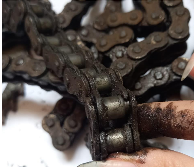
Figura 108: Roller link plate fracturado de la cadena 428H (Eslabón 1)
