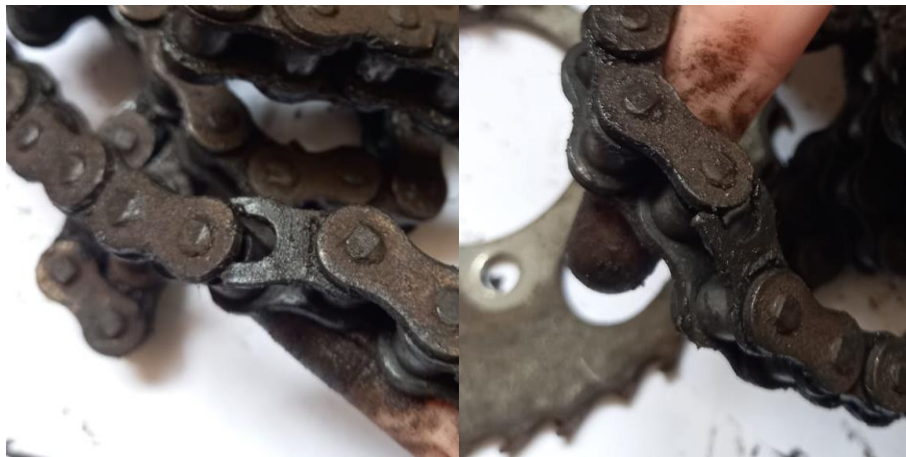
Figura 109: Roller link plate fracturado de la cadena 428H (Eslabón 2)
