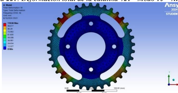
Figura 221: Deformación total de la catalina 42T - Modo 15 – AISI 1045
