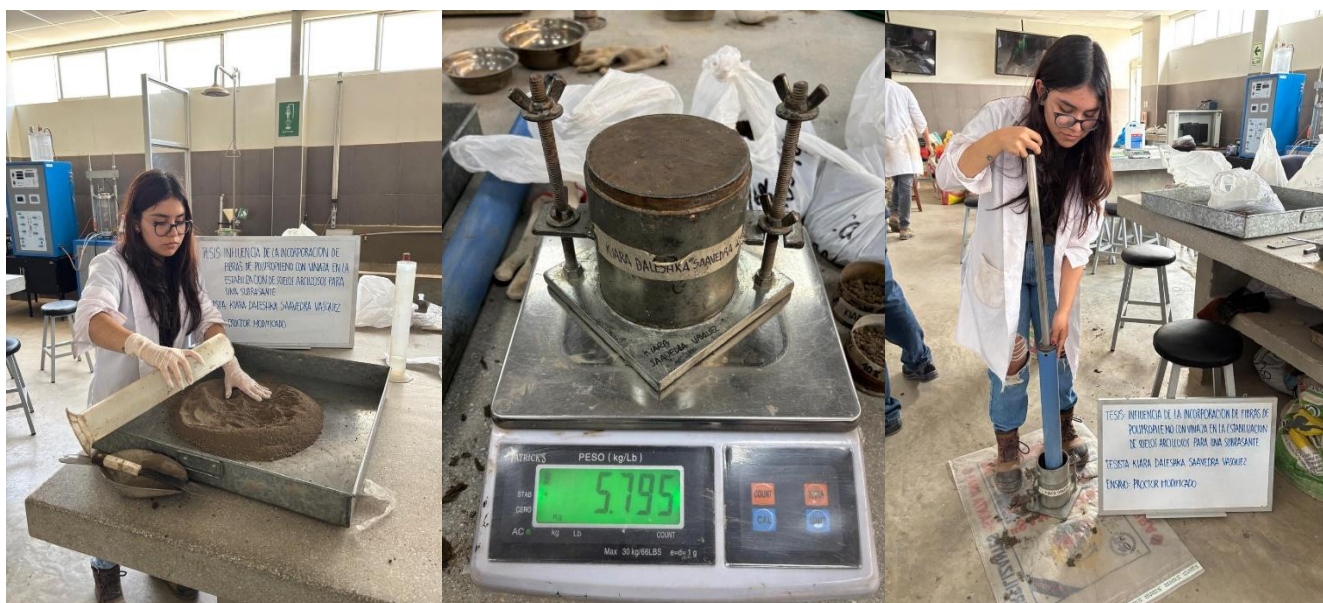
Fig. 44. Mezclado, enrasado y compactación para ensayo de Proctor Modificado
