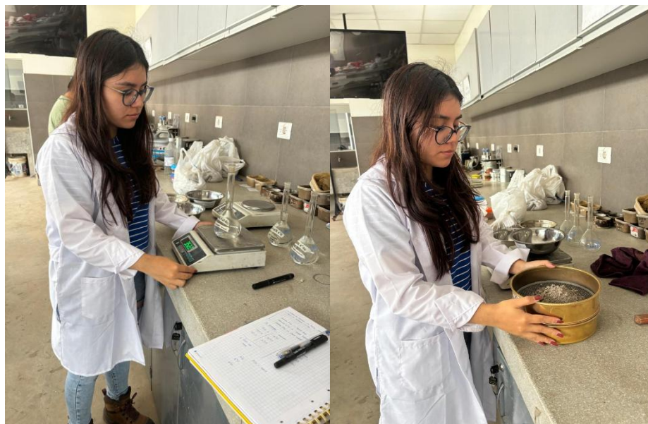
Fig. 35. Se pesa el picnómetro y pasa por el tamiz N°04
