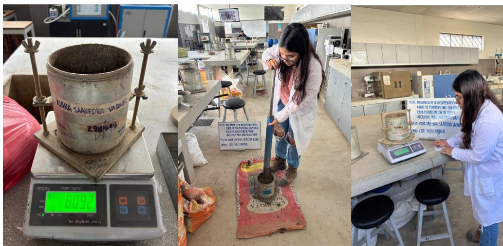
Fig. 45. Pesaje de molde, compactación y peso de muestra compactada
