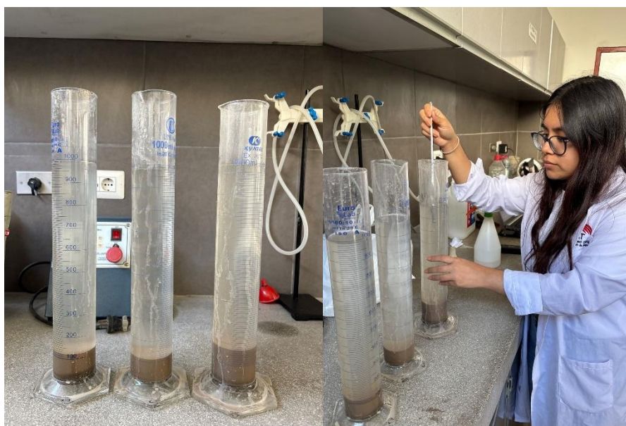
Fig. 34. Medición de la temperatura con el hidrómetro
