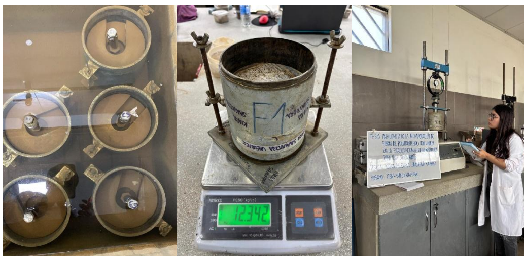
Fig. 46. Inmersión del espécimen, peso de muestra saturada y penetración de CBR
