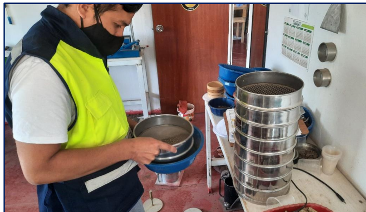
Figura 06 Análisis granulométrico por tamizado
