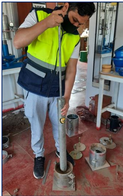
Figura 08 Compactación de la muestra de suelo
