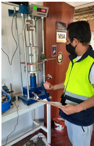
Figura 09 Penetración del espécimen de prueba
