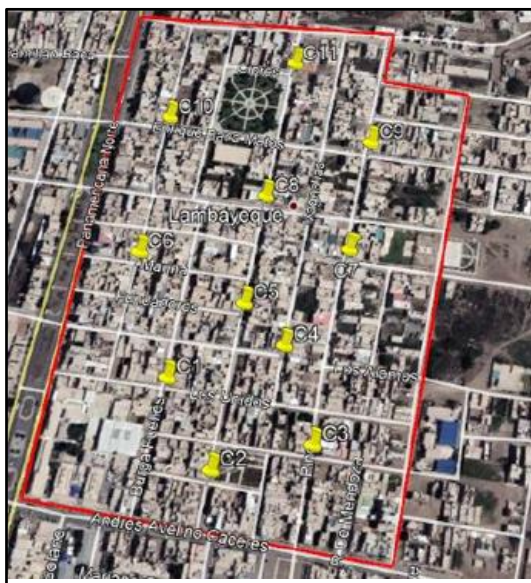
Figura 01 Ubicación de calicatas para extracción de muestras de suelo
