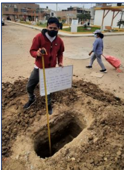
Figura 05 Identificación de la calicata 04, para extracción de muestra
