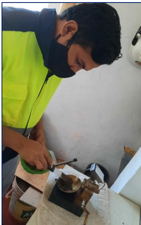
Figura 07 Ensayo de límite líquido en la Copa Casagrande
