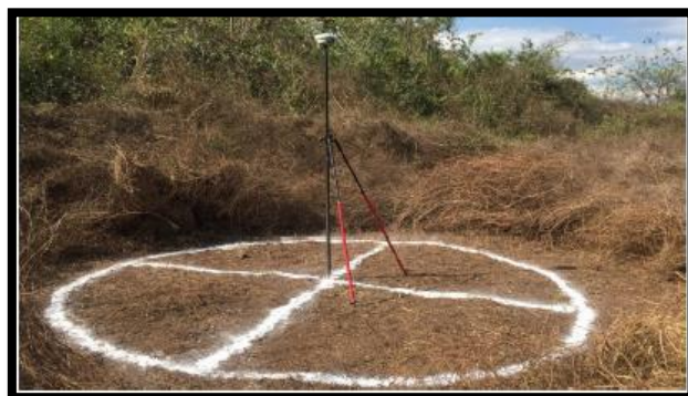
Ilustración 13. Forma de marcar un punto de control
