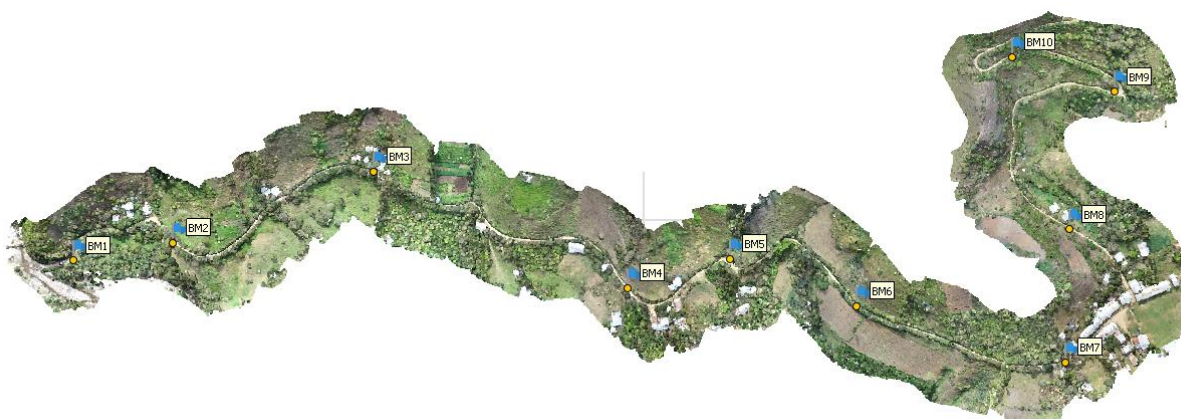
Ilustración 20. Nube de puntos densa en calidad alta, procesadas
