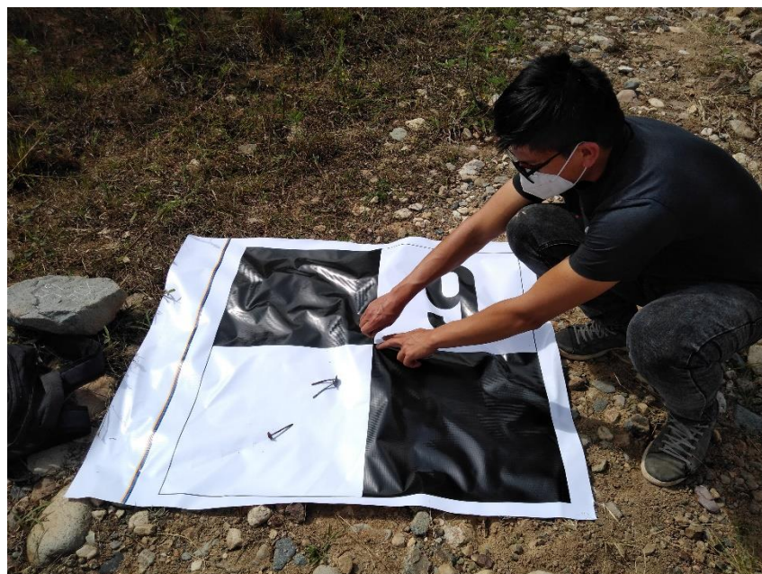
FOTOGRAFIA N°7.8. Puntos de control 1mx1m
