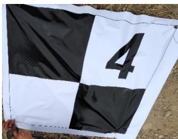
Ilustración 18. Punto de control en campo para el Drone (100cmx100cm)
