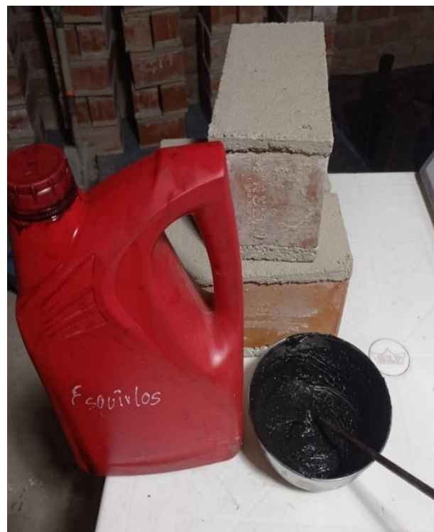
Anexo 14: Mezcla con el aceite 80W-90 con esquirlas
