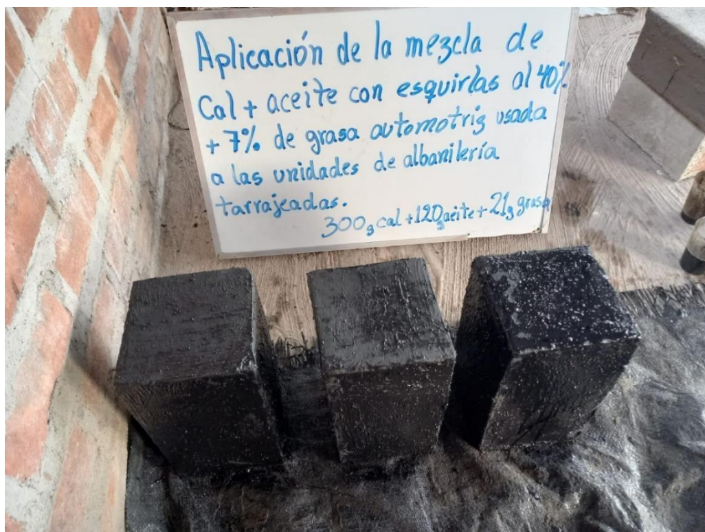
Anexo 17: Aplicación de la mezcla del aceite 80W-90 con esquirilas sobre las unidades tarrajeadas
