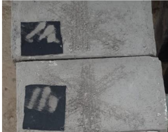
Imagen 5. Muestra con el revestimiento de cal+ aceite 25W-50 (40%)
