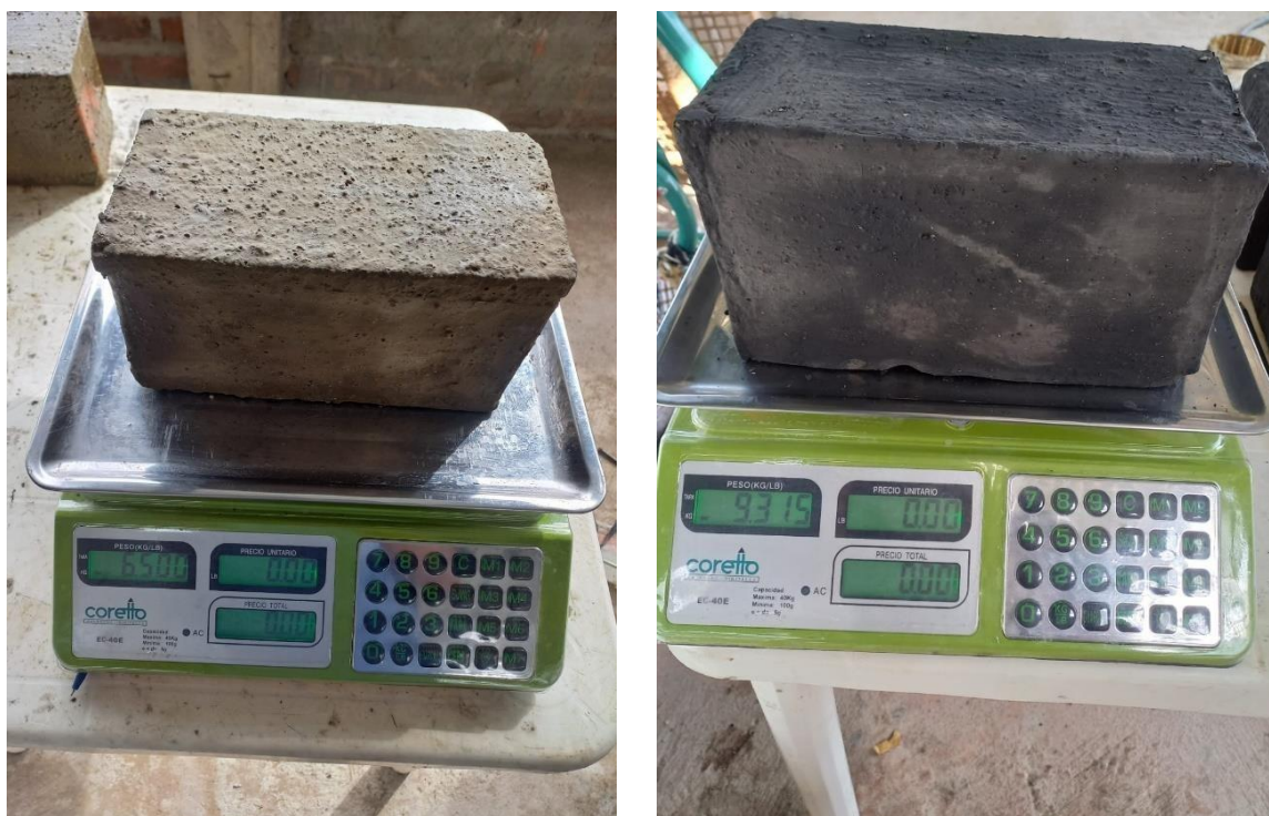
Anexo 18: Pesaje de las muestras con el revestimiento de GRA al 5% + 15W-40 y 20W-50 respectivamente
