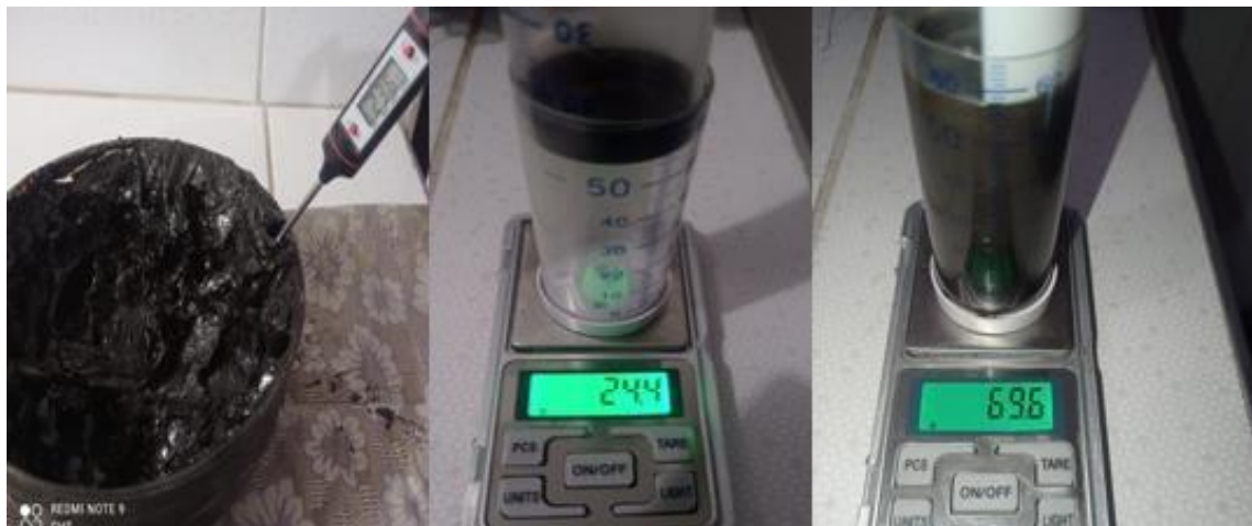
Imagen 2. Ensayo de densidad de la grasa residual automotriz (GRA)
