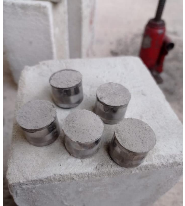
Anexo 20: Taqués con el revestimiento del aceite 20W-50 al 40%
