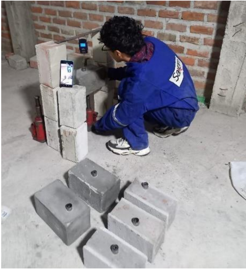
Imagen 6. Ensayo empírico referente a la norma ASTM D-4541
