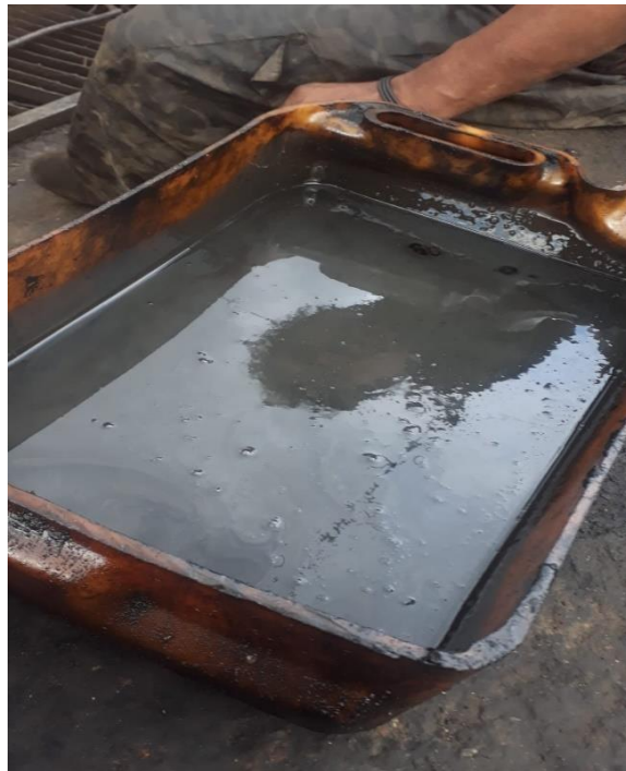
Anexo 8: Aceite de caja con desgaste en sus componentes Fuente: Elaboración propia
