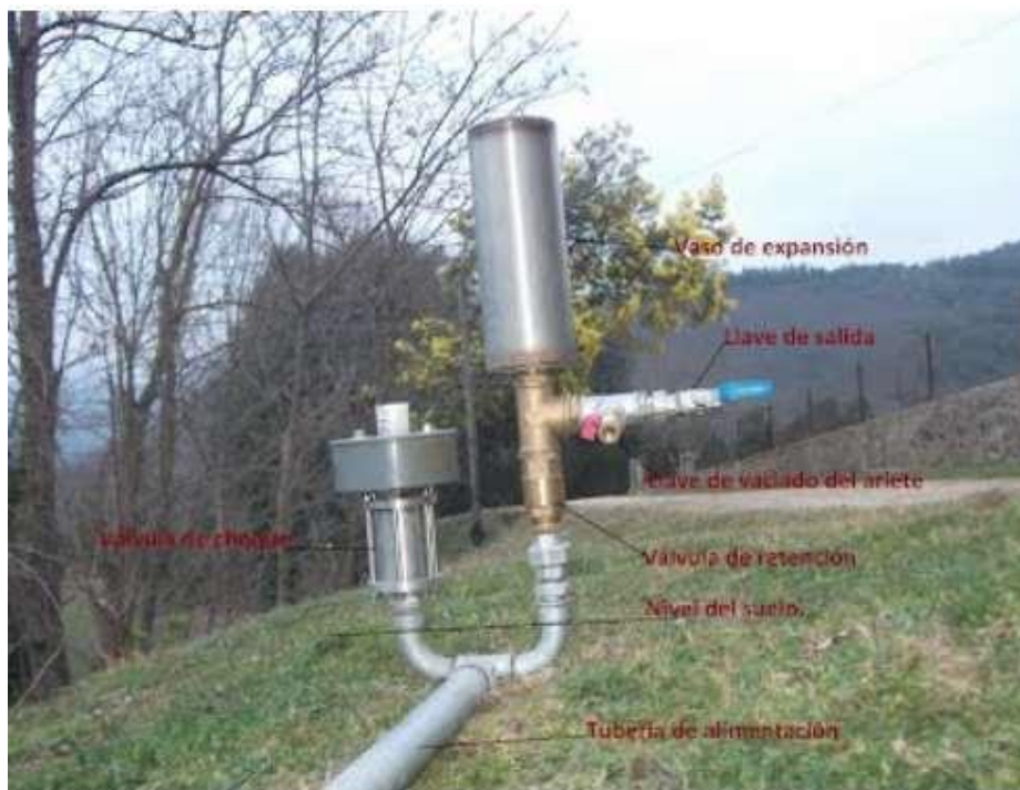
Figura 19 Ariete hidráulico básico empotrable
