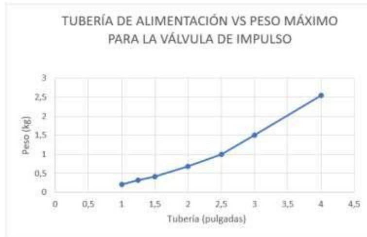
Figura 29 peso máximo para la válvula de impulso vs tamaño de la bomba de ariete
