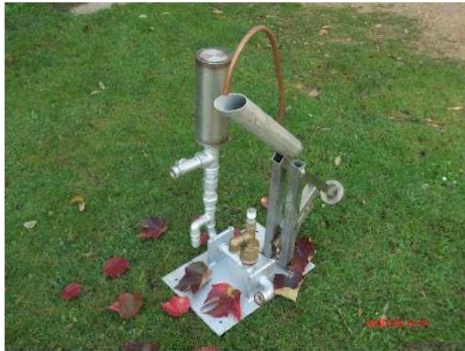
Figura 16 Ariete hidráulico de caudal variable y arranque automático
