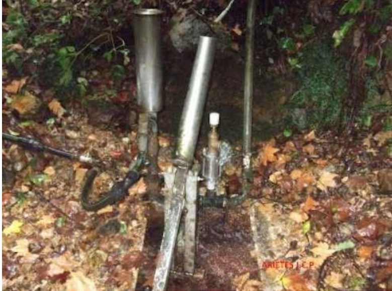
Figura 15 Ariete hidráulico de caudal variable y arranque automático
