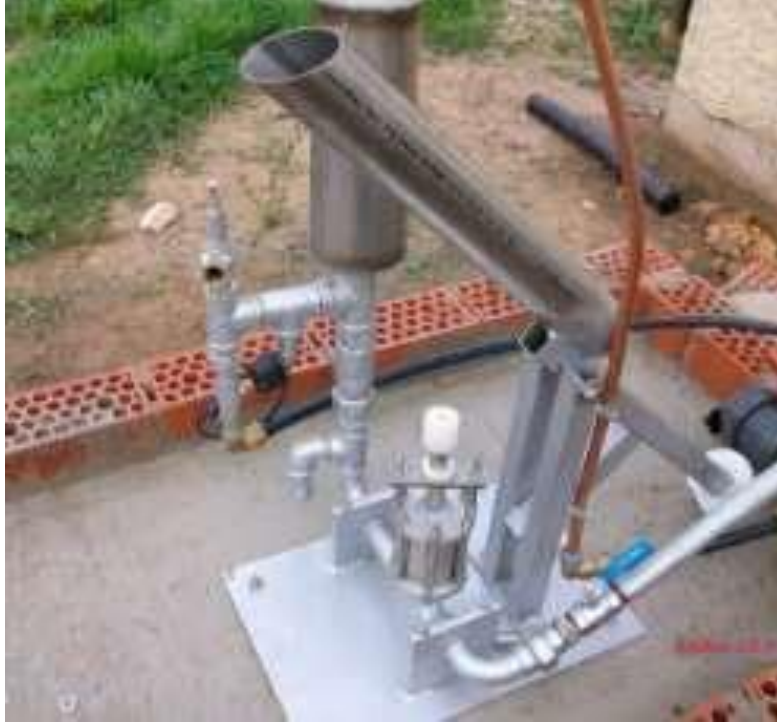
Figura 14 Ariete hidráulico de caudal fijo y arranque automático
