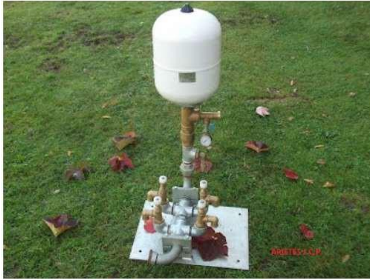
Figura 17 Ariete hidráulico multiválvulas de caudal variable y arranque automático
