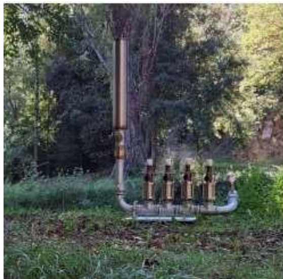
Figura 18 Ariete hidráulico multiválvulas de caudal variable
