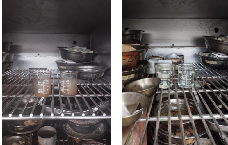
Ilustración 30 Ensayo de Sales Solubles Totales.
