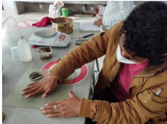
Ilustración 27 Ensayo de límites de Atterberg-Límite Plástico
