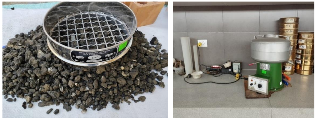
Ilustración 33 Procedimiento para la extracción cuantitativa de asfalto
