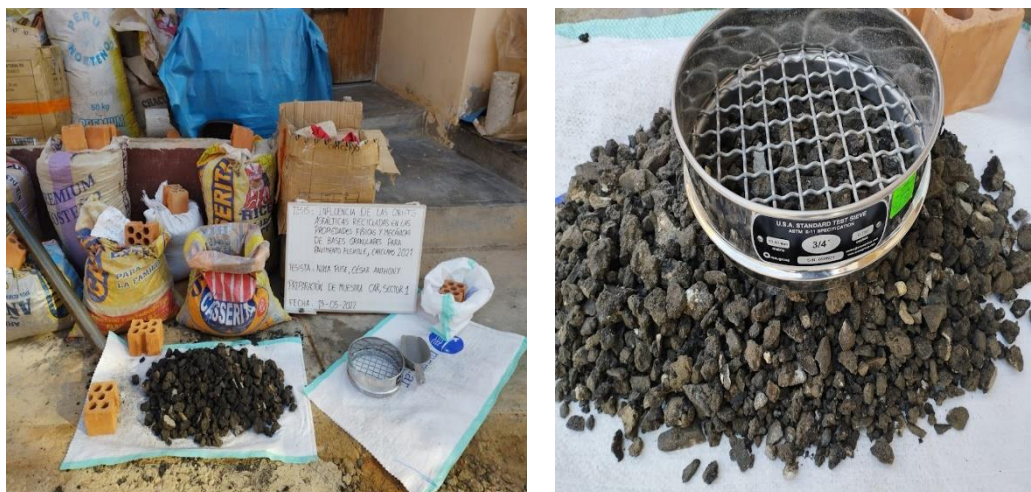
Ilustración 23 Proceso de trituración y tamizado de CAR de los 4 sectores
