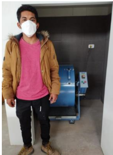
Ilustración 28 Ensayo de abrasión de los ángeles.
