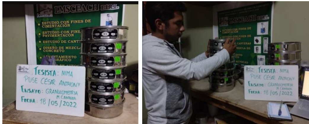
Ilustración 24 Ensayo de análisis granulométrico por tamizado
