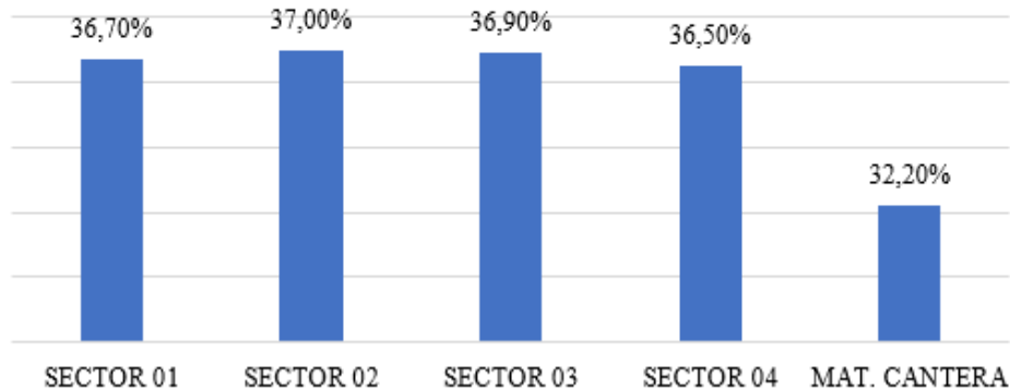
Gráfico 7 Abrasión de los ángeles muestras con 5% de CAR y 95% de material de cantera.
