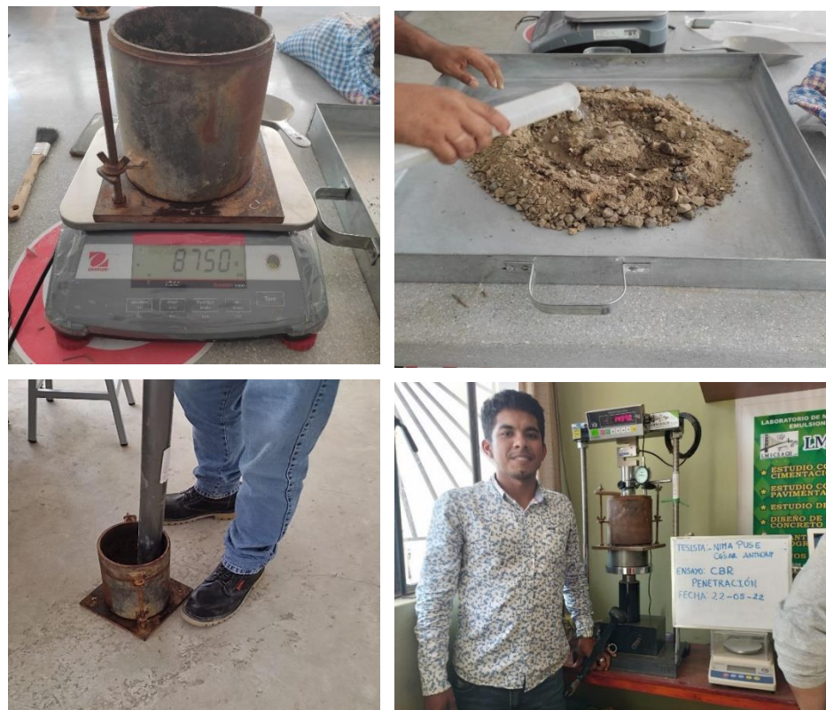
Ilustración 31 Procedimiento para ensayo de CBR
