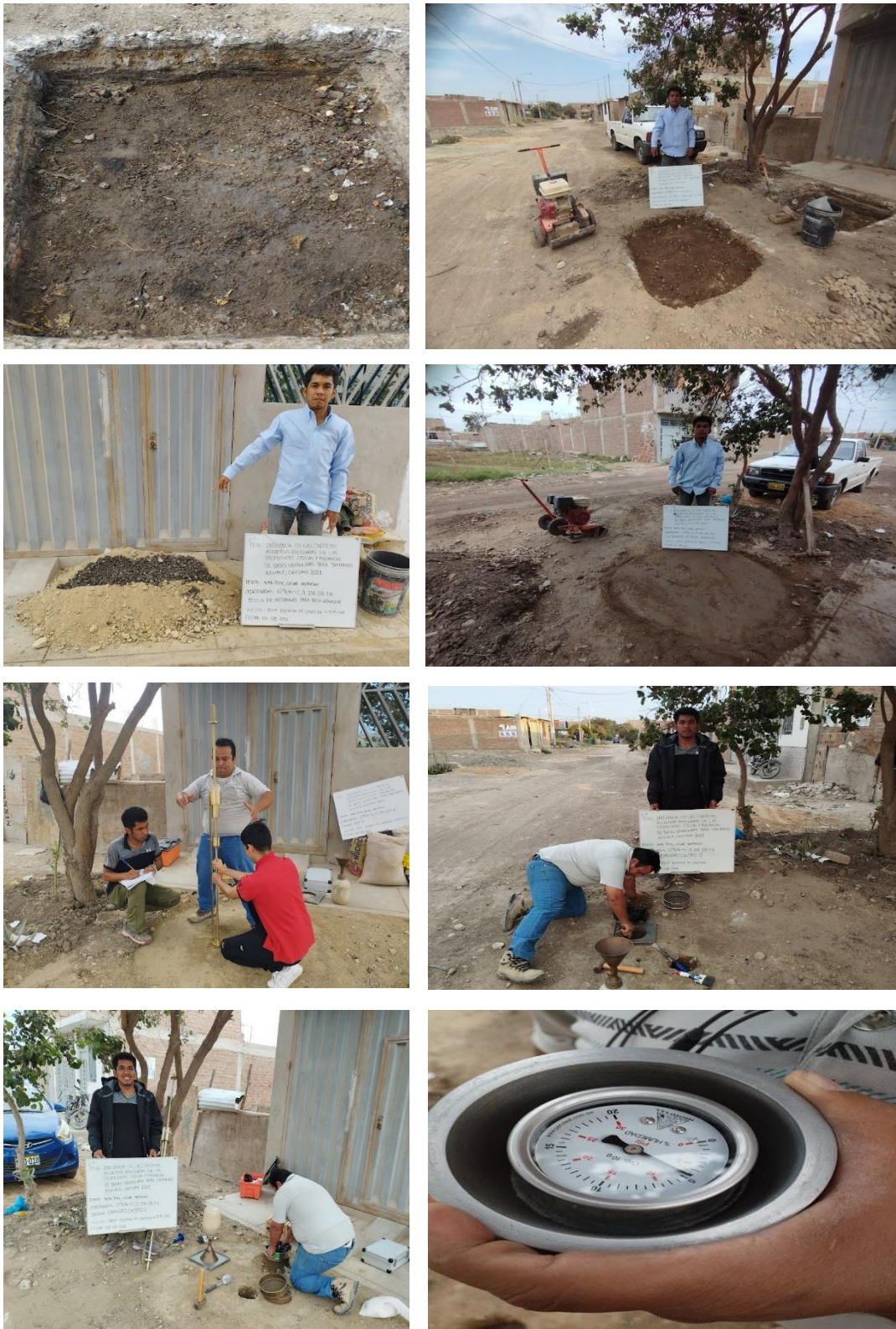
Ilustración 32 Procedimiento para ensayo de Penetrómetro de Cono Dinámico o DCP
