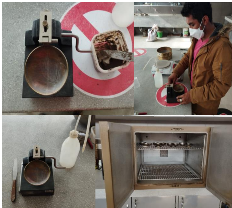
Ilustración 26 Ensayo de límites de Atterberg-Límite Líquido
