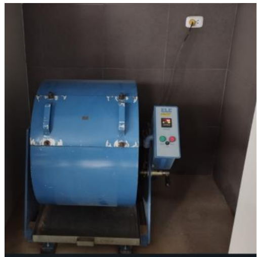
Ilustración 28 Ensayo de abrasión de los ángeles.
