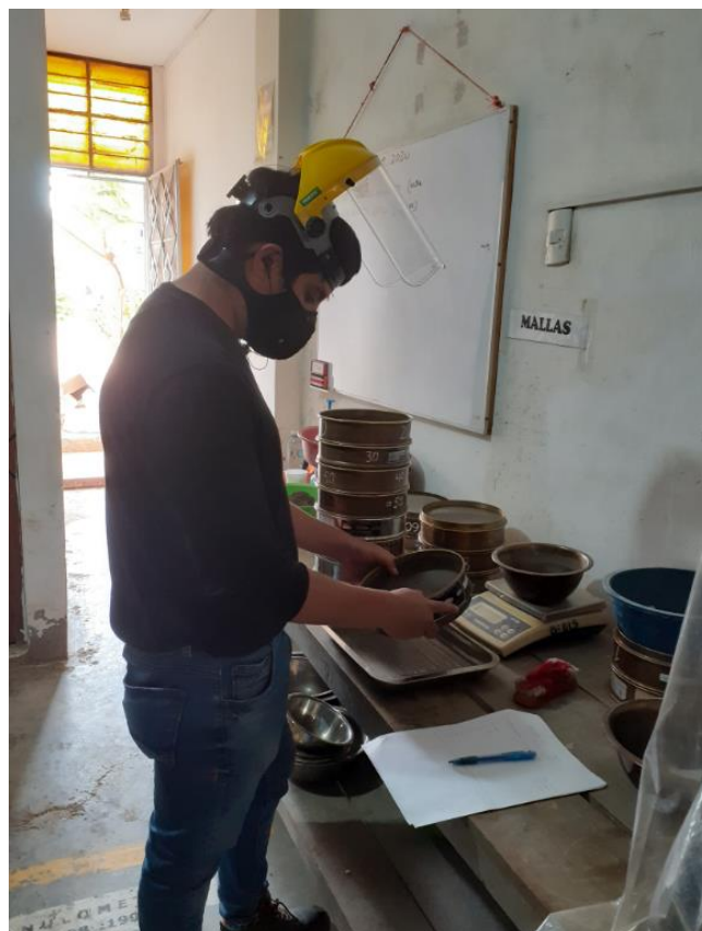
Figura 3.12 Análisis granulométrico con muestra seca
