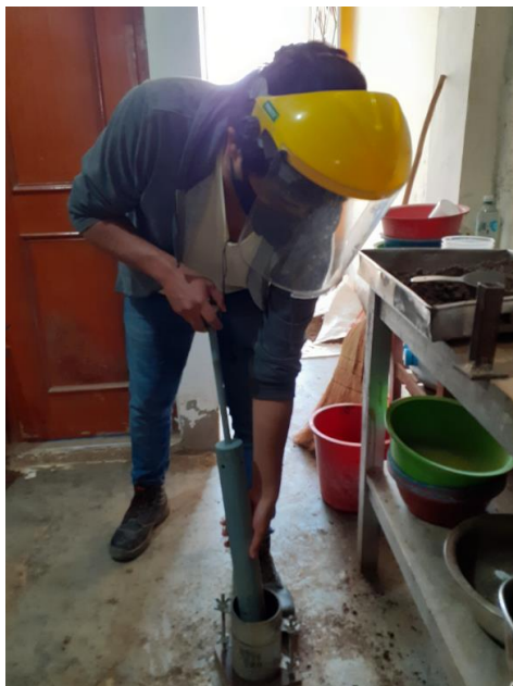
Figura 3.23 Compactación de la muestra de suelo, calicata 04
