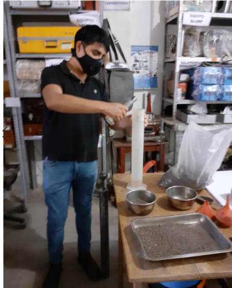
Figura 3.40 Preparación de la solución agua-aditivo ConAid
