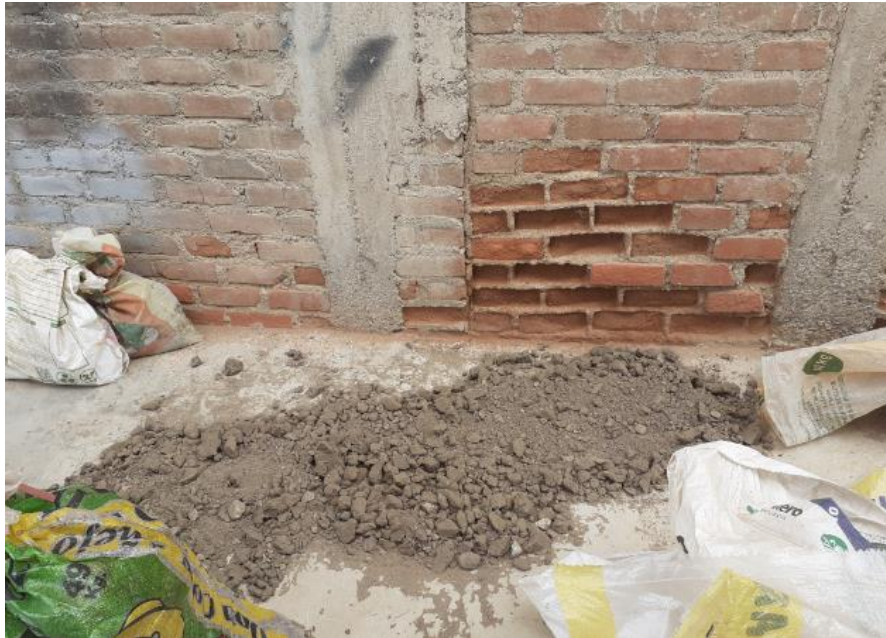
Figura 3.10 Secado de muestras con exposición al sol sobre una superficie limpia
