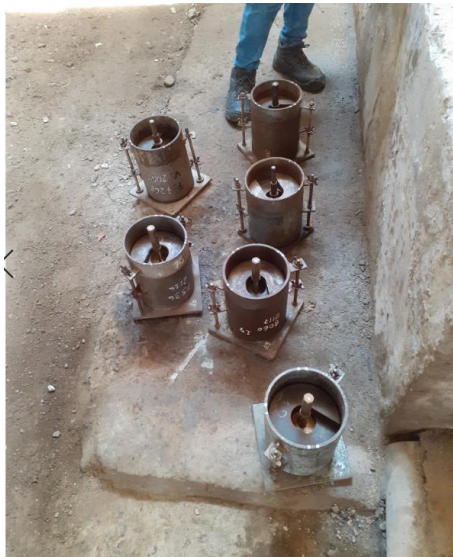
Figura 3.44 Moldes con muestra más aditivo ConAid para sumergir en poza
