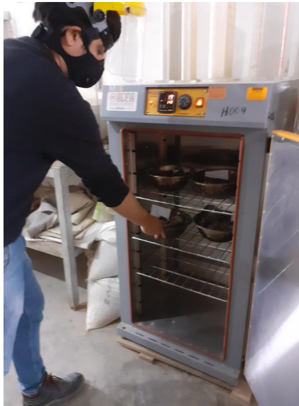
Figura 3.8 Muestras de cada calicata, llevadas al horno de secado
