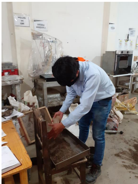
Figura 3.33 Preparación de la muestra con dosificación de aditivo 0.9 L
