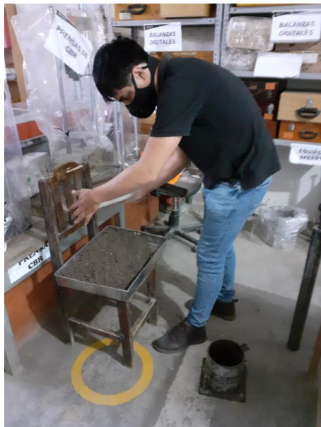
Figura 3.41 Preparación de las muestras más aditivo iónico ConAid
