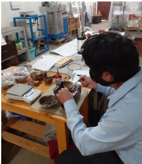
Figura 3.35 Ensayo de Límite líquido con muestra más aditivo Perma Zyme 30x Con 20 gramos de la muestra del límite líquido, se hace el ensayo de limite plástico, el procedimiento a seguir es el mismo según el manual de ensayo de materiales del MTC.
