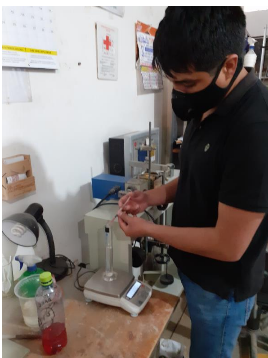
Figura 3.39 Determinación de la muestra equivalente a 2.5 cm 3 de aditivo ConAid
