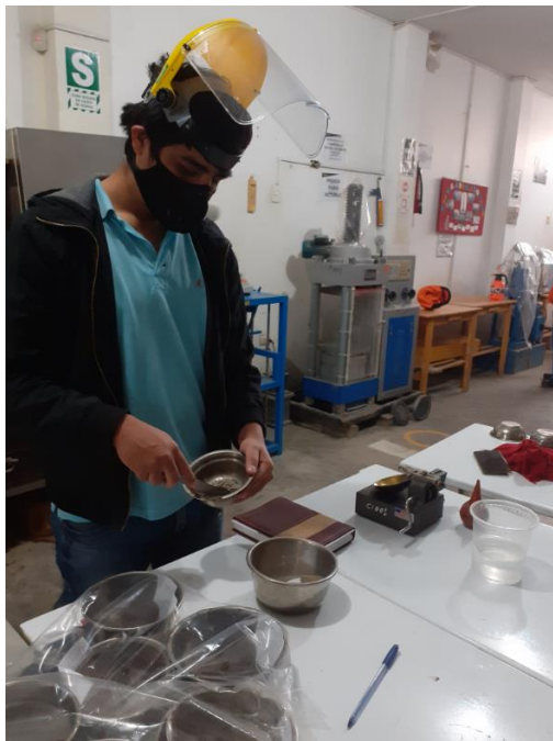
Figura 3.13 Preparación de la mezcla suelo más agua
