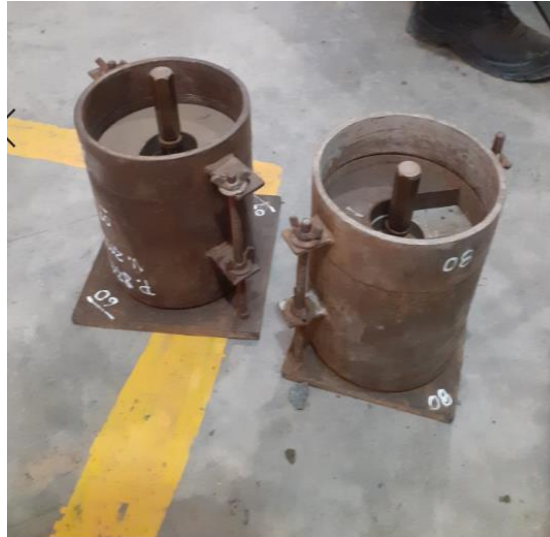
Figura 3.26 Moldes con placa perforada más sobrecarga anular y saturada
