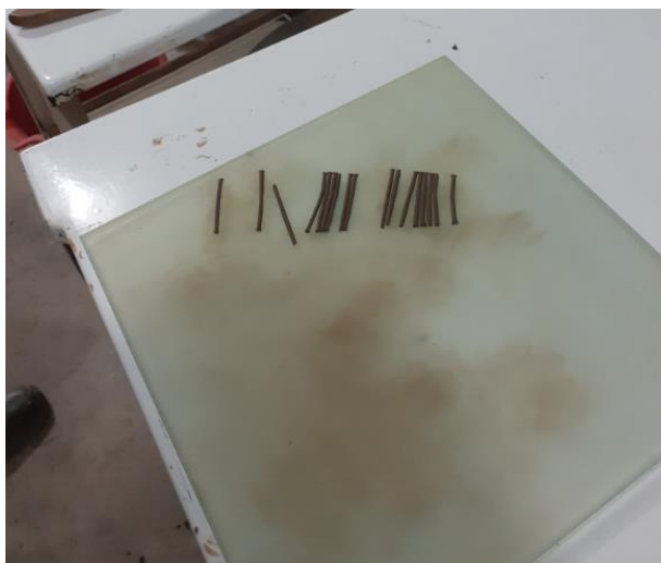
Figura 3.16 Cilindros o barritas de suelo con diámetro 3.2 mm
