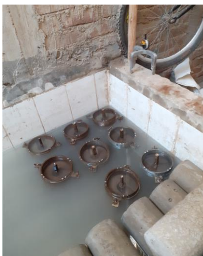
Figura 3.38 Moldes de CBR, sumergidas en una poza con agua
