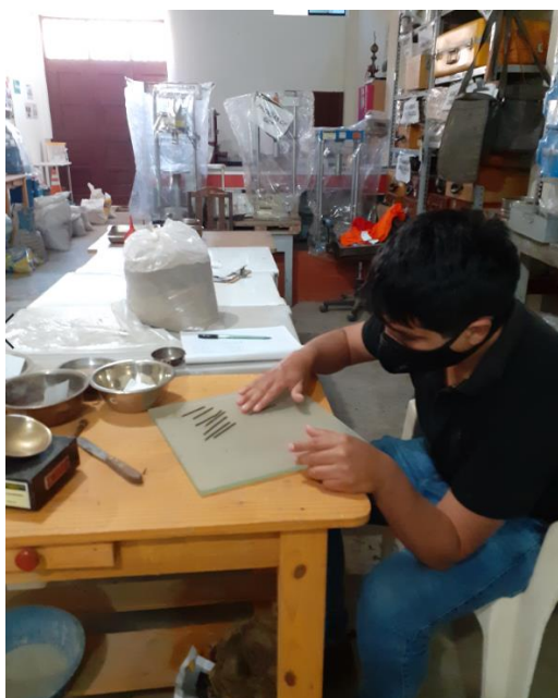
Figura 3.43 Ensayo de límite plástico de muestra más aditivo iónico ConAid
