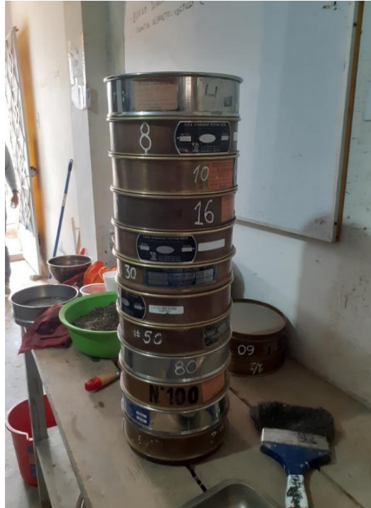
Figura 3.11 Conjunto de mallas para el análisis granulométrico
