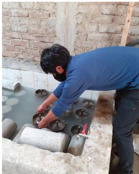
Figura 3.28 Inmersión de los moldes de ensayo en la poza con agua
