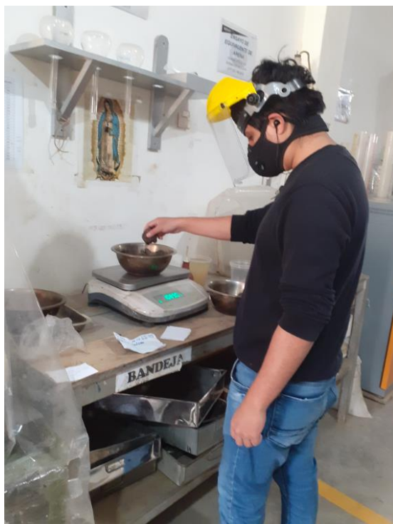
Figura 3.6 Determinación del peso la muestra de la calicata 01
