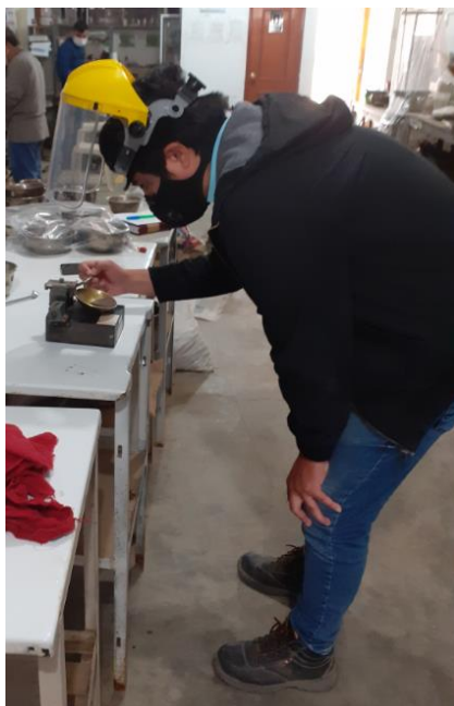
Figura 3.15 Ensayo de límite líquido en la copa Casagrande
