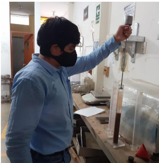
Figura 3.21 Registro de lectura de arcilla sobre la probeta graduada
