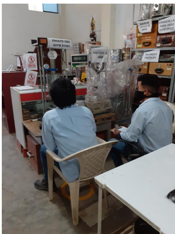
Figura 3.29 Penetración del espécimen de prueba
