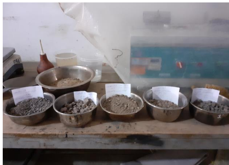
Figura 3.9 Muestras secadas al horno para luego ser pesadas en balanza digital
