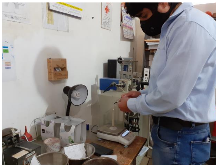
Figura 3.32 Determinación en peso de la cantidad de aditivo Perma Zyme 30x
