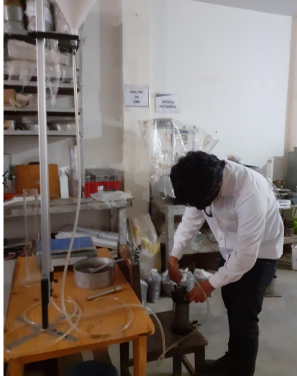
Figura 3.31 Abertura de válvulas de entrada y salida del espécimen de prueba
