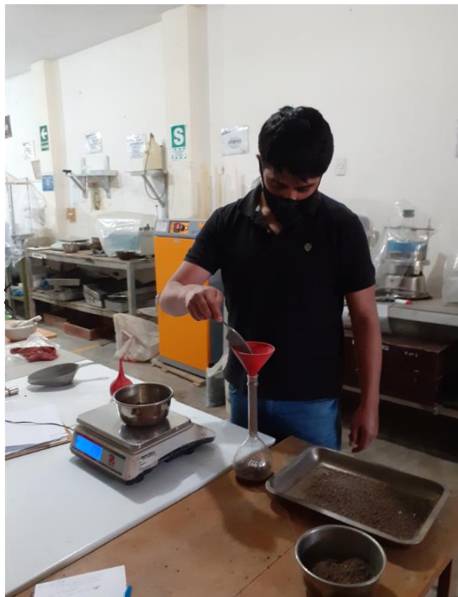
Figura 3.17 Muestra de suelo vertido en el matraz
