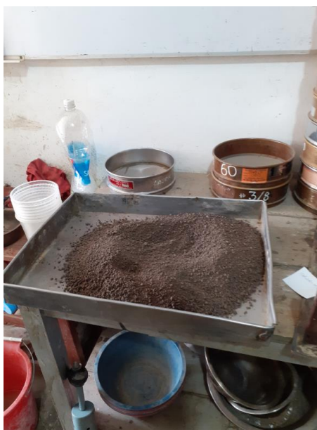
Figura 3. 22 Preparación de la muestra total para el ensayo Proctor modificado
