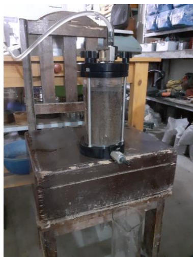
Figura 3.30 Muestra saturada previo al ensayo de permeabilidad
