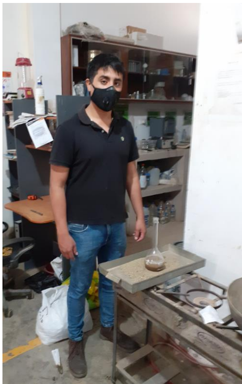
Figura 3.18 Calentamiento del matraz a temperatura de 80 °C
