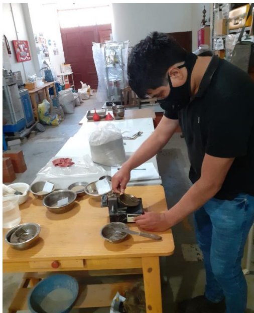
Figura 3.42 Ensayo de límite líquido con muestra más aditivo ConAid
