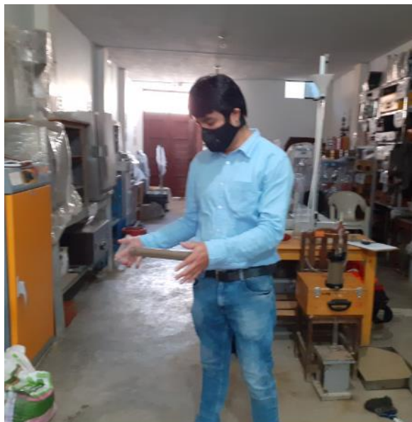
Figura 3.20 Movimiento horizontal de la probeta durante 90 ciclos
