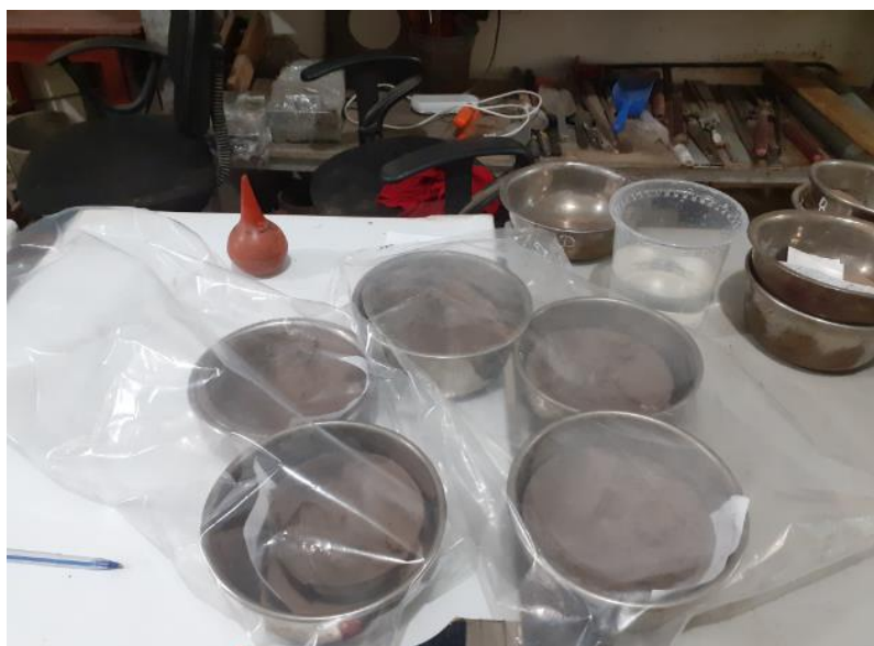
Figura 3.14 Preparación de las muestras curadas en 24 horas
