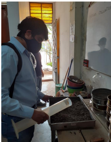
Figura 3.24 Preparación de los especímenes de prueba para ensayo CBR
