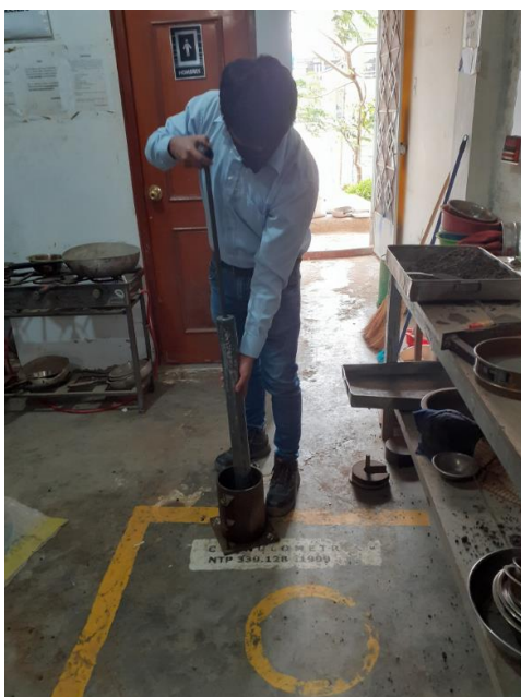
Figura 3.25 Compactación con una energía de 56 golpes
