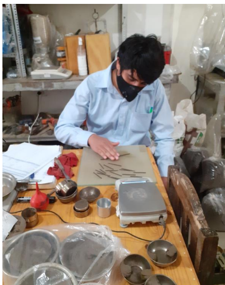
Figura 3.36 Ensayo de límite plástico con muestra más aditivo Perma Zyme 30x Este ensayo se hace para cada una de las dosificaciones que se han establecido.
