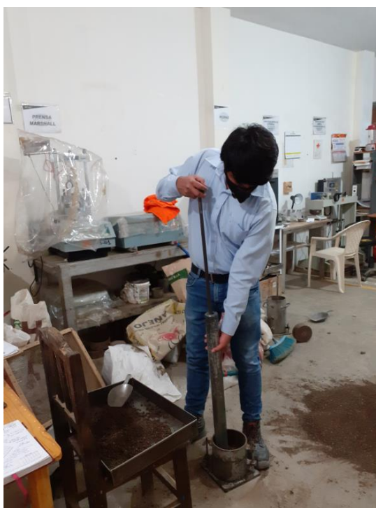
Figura 3.34 Compactación de muestra con aditivo equivalente a 0.9L
