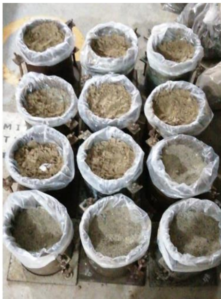
Figura 3.37 Curado de los moldes para el ensayo de CBR
