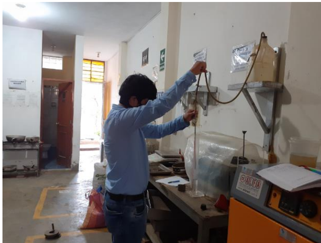
Figura 3.19 Llenado de la probeta graduada hasta una altura de 4''
