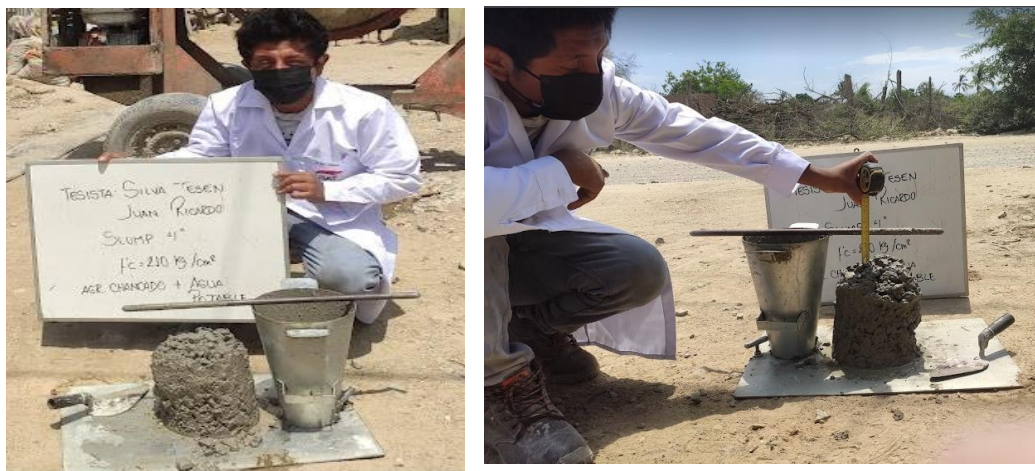
Figura 18: Ensayo de Trabajabilidad mediante "Cono de Abrams" - Medición del Slump de la mezcla preparada "A. C+A. P"
