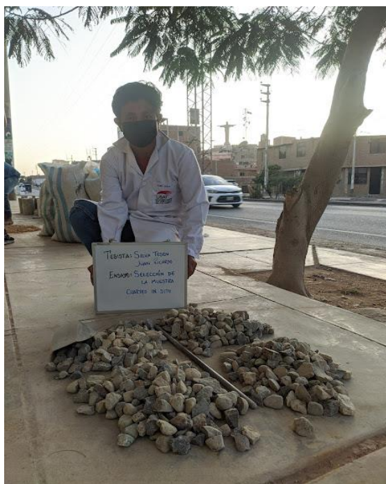
Figura 2: Cuarteo del Agregado Grueso In situ
