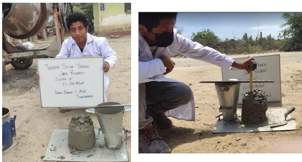
Figura 21: Ensayo de Trabajabilidad mediante "Cono de Abrams" - Medición del Slump de la mezcla preparada "A. Z+A. S"
