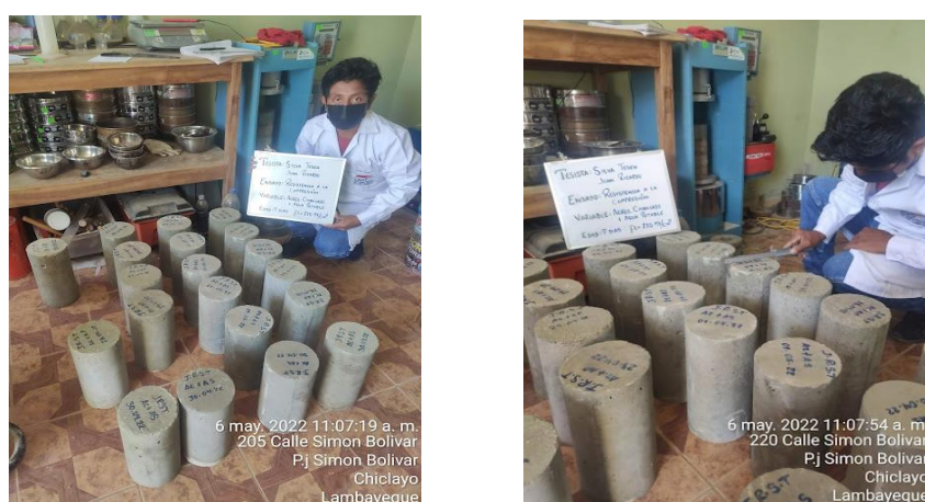
Figura 17: Ensayo de Resistencia a la Compresión de Probetas
