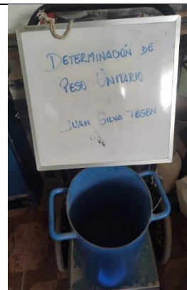
Pesado de molde para agregado grueso
