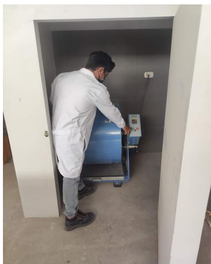
Figura 11: Ensayo de desgaste por abrasión en la máquina Los Angeles
