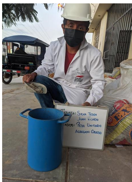
Figura 10: Realización del ensayo de peso unitario del agregado grueso chancado
