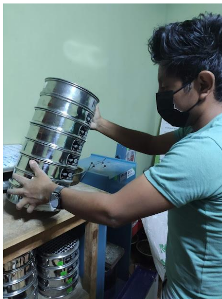
Figura 3: Realización en Laboratorio del ensayo de Análisis Granulométrico del Agregado Fino
