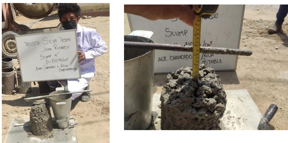
Figura 19: Ensayo de Trabajabilidad mediante "Cono de Abrams" - Medición del Slump de la mezcla preparada "A. C+A. S"
