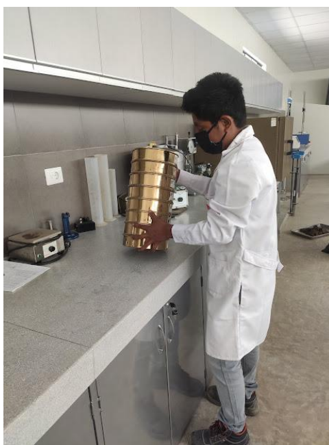
Figura 7: Realización en Laboratorio del ensayo de Análisis Granulométrico del Agregado Grueso Chancado
