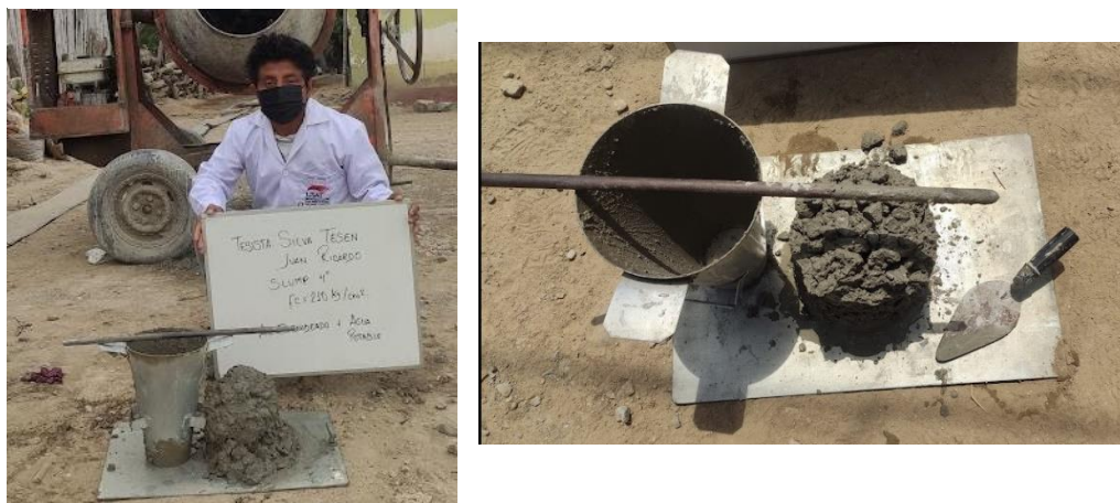
Figura 20: Ensayo de Trabajabilidad mediante "Cono de Abrams" - Medición del Slump de la mezcla preparada "A. Z+A. P"
