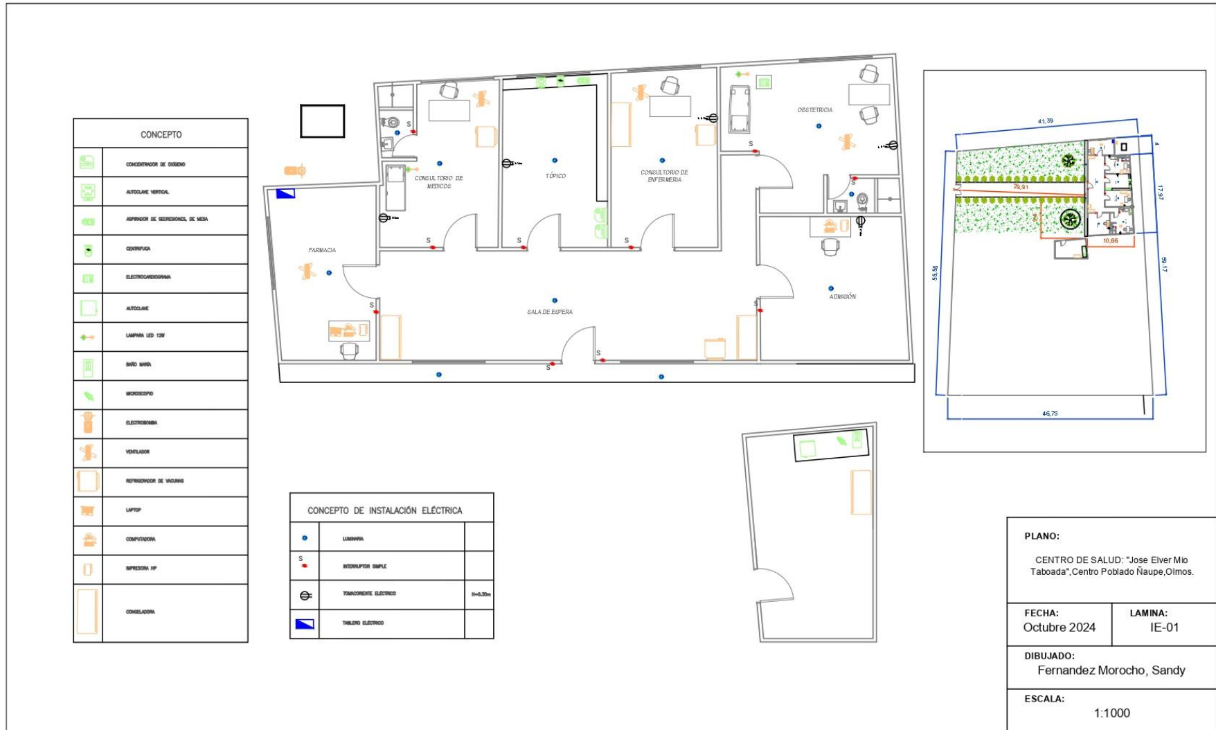
Figura 7. Plano de ubicación de la instalación eléctrica.
