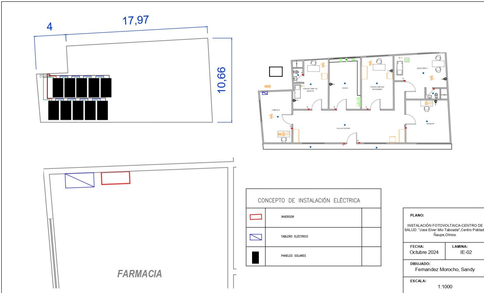
Figura 17. Ubicación de los 10 paneles solares.
