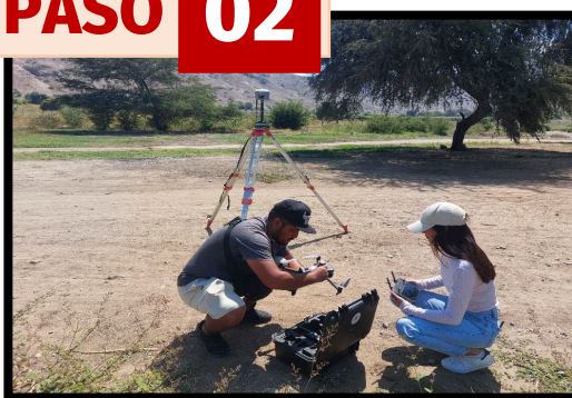
Ilustración 57.- Paso 02.- Armado del dron Mavic 3E con módulo RTK
