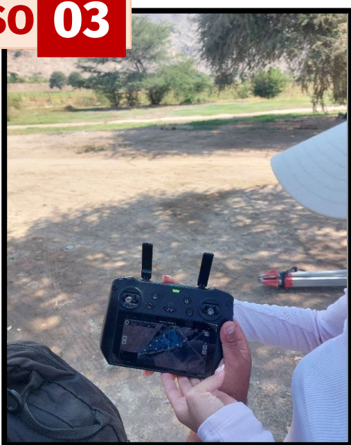
Ilustración 58.-Paso 03.- Planificación del vuelo fotogramétrico
