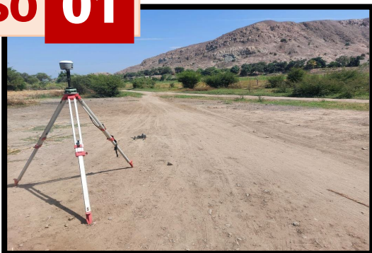
Ilustración 56.- Paso 01.- Instalación del GPS diferencial
