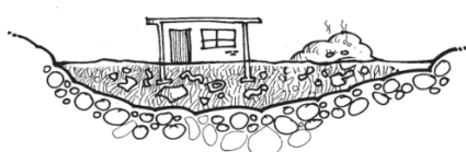
Sobre suelos de relleno sanitario o desmonte
