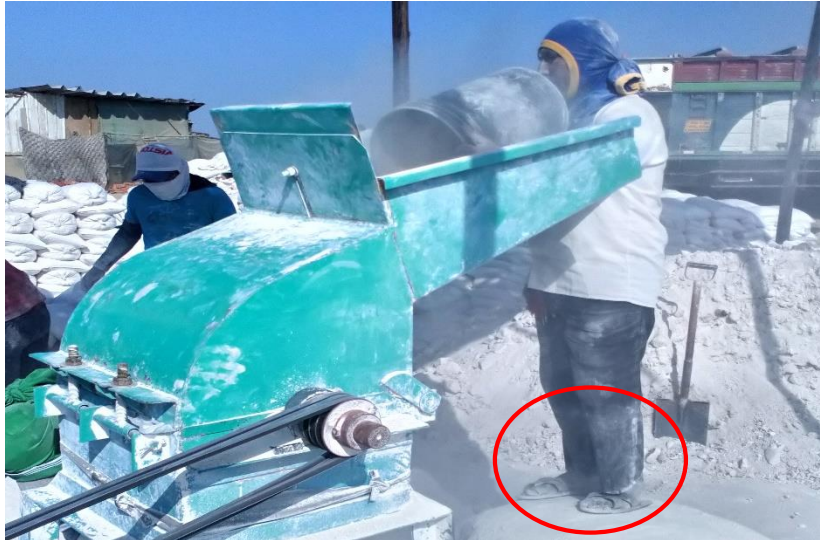
Figura 19. Descarga del yeso de construcción en el alimentador del molino
