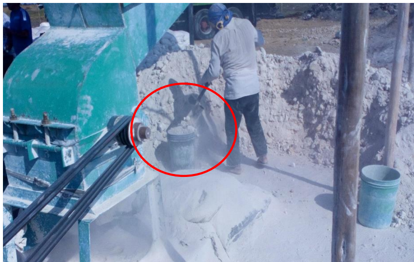
Figura 20. Carga de los baldes con el yeso de construcción
