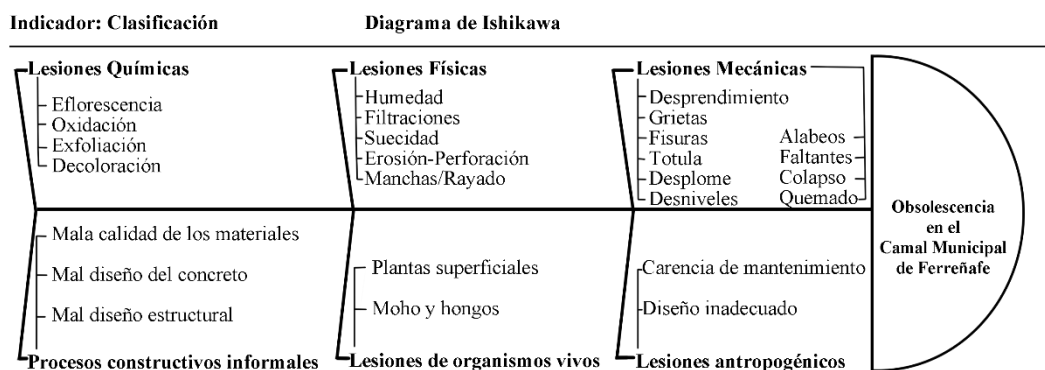
Figura 21 Esquema diagnóstico para identificar la obsolescencia en el Camal Municipal de Ferreñafe.
