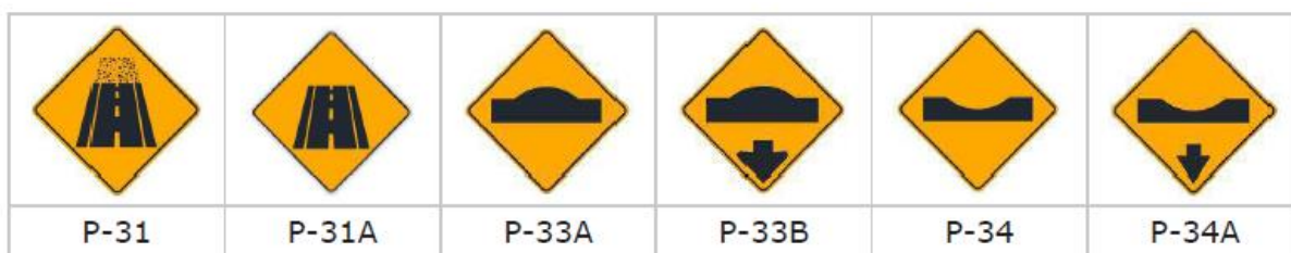
Ilustración 27: Señales preventivas por superficie de rodadura
