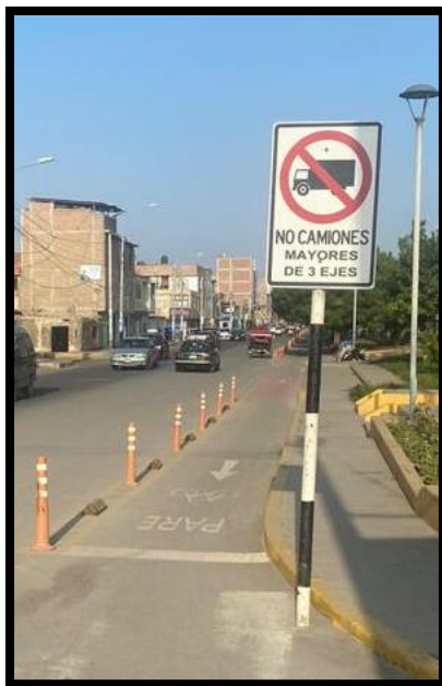
Ilustración 53: Señalización vertical (no camiones mayores de 3 ejes)
