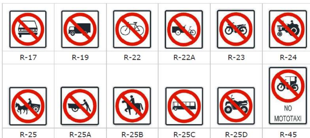
Ilustración 21: Señales de prohibición de paso por clase de vehículo
