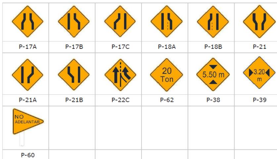
Ilustración 28: Señales preventivas por restricciones físicas de la vía
