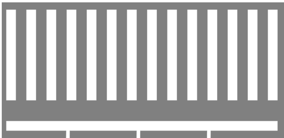
Ilustración 67: Señal horizontal, paso peatonal en intersección
