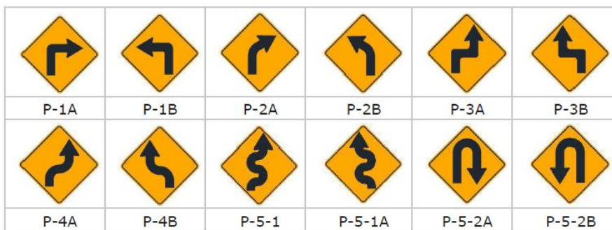
Ilustración 25: Señales preventivas, curvatura horizontal
