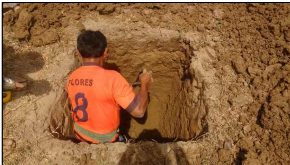
FOTOGRAFÍA N° 2.8: Excavación de la calicata 4
