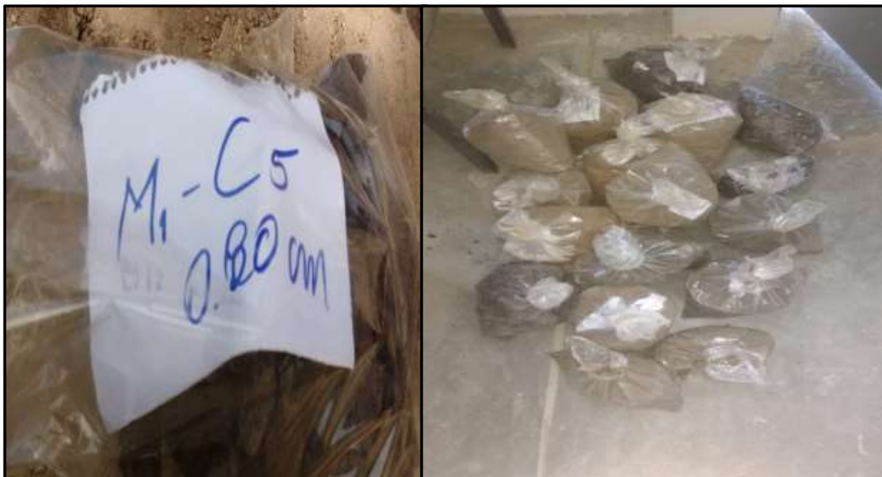
FOTOGRAFÍA N° 2.13: Obtención de muestras para ensayos de laboratorio
