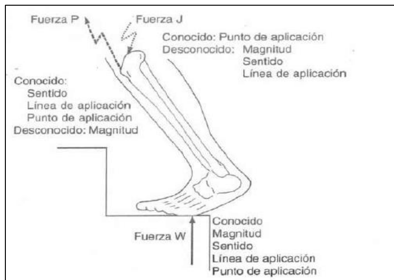
Figura 6: Diagrama de cuerpo libre de una pierna cuando sube un escalón
