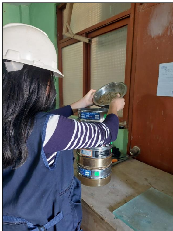
Figura 9. 6: Análisis granulométrico por tamizado
