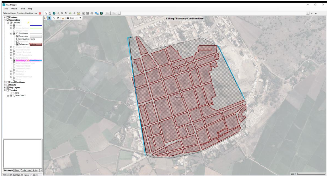
Figura 4. 9: Asignación de las condiciones de contorno en la geometría generada.
