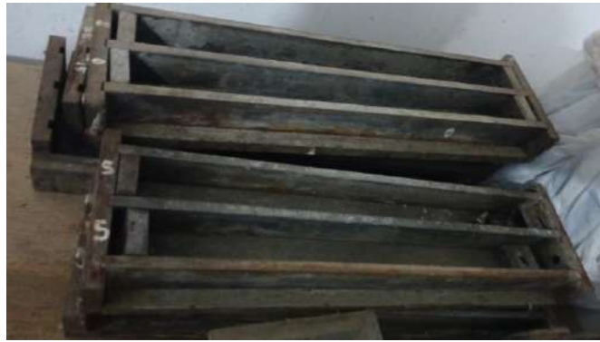
Fig. 72: Moldes para barras alcalí sílice. Fuente: Propia.
