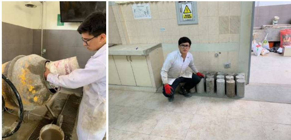
Fig. 55-56: Preparación de Muestras (Probetas de Concreto). Fuente: Propia.
