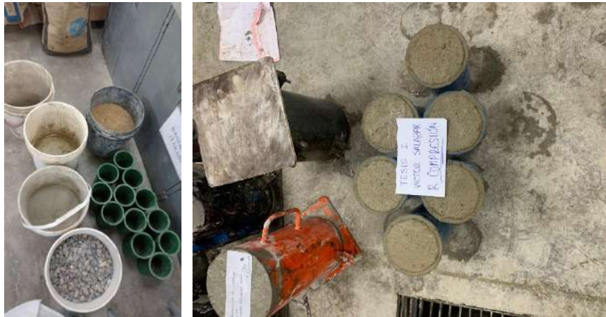
Fig. 54-55: Preparación de Muestras (Probetas de Concreto). Fuente: Propia.
