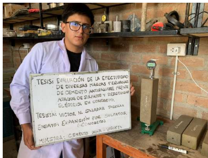
Fig. 65: Toma de medidas con el equipo comparador. Fuente: Propia.
