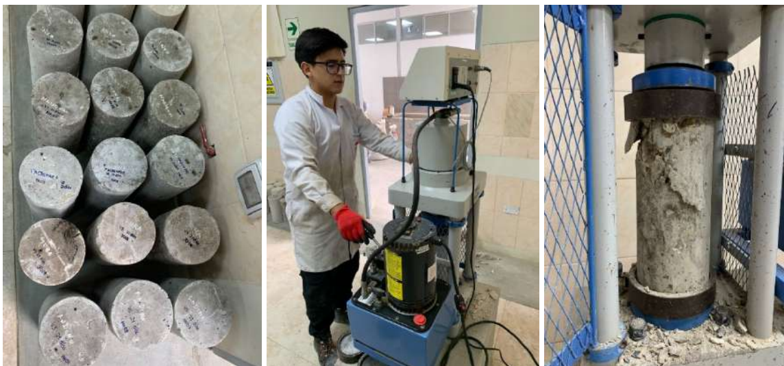
Fig. 57-59: Ensayo resistencia a la compresión. Fuente: Propia.
