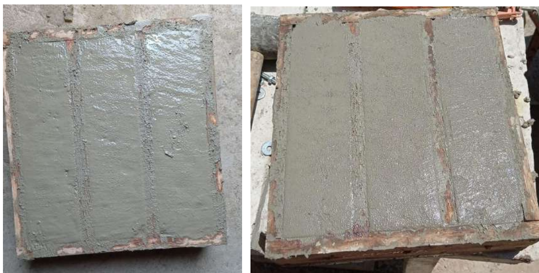
Fig. 62-63: Preparación de moldes y viguetas para ataque a sulfatos. Fuente: Propia.
