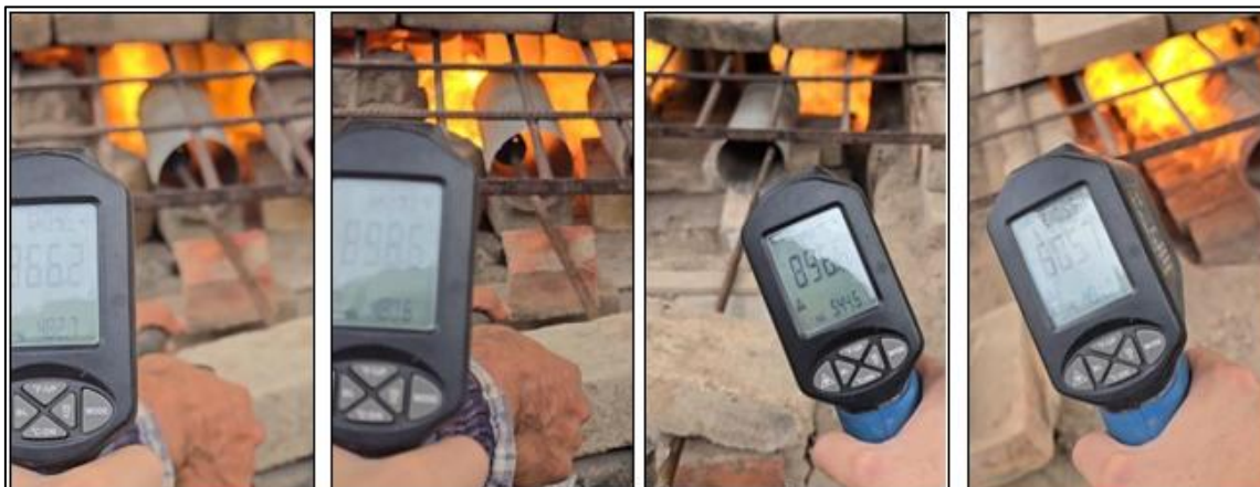
Fig. 45. Toma de temperatura con pirómetros
