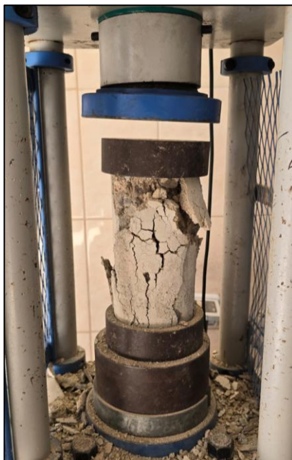
Fig. 77. Rotura a compresión.
