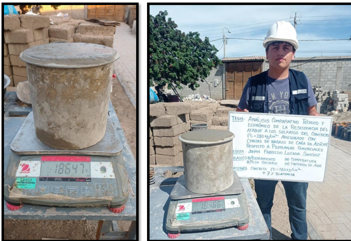
Figura N°38. Medición del Peso de la muestra de Concreto de CBCA
