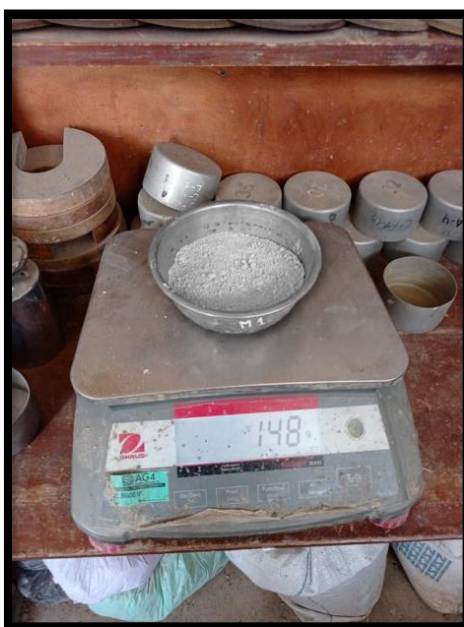
Figura N°24. Peso Humedo de Ceniza Volante
