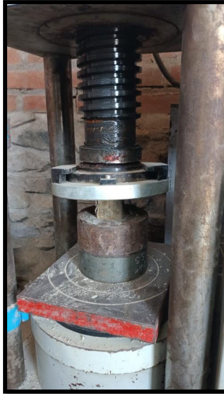
Figura N°46. Segundo ensayo a compresión de los cubos de control con un resultado de f'c=237.16 \text{ kg/cm}^2
