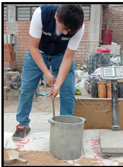
Figura N°36. Agregado Fino Peso Unitario Seco Compactado
