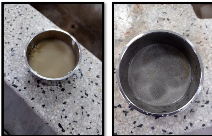
Figura N°14. Lavado de muestra restante Diatomita
