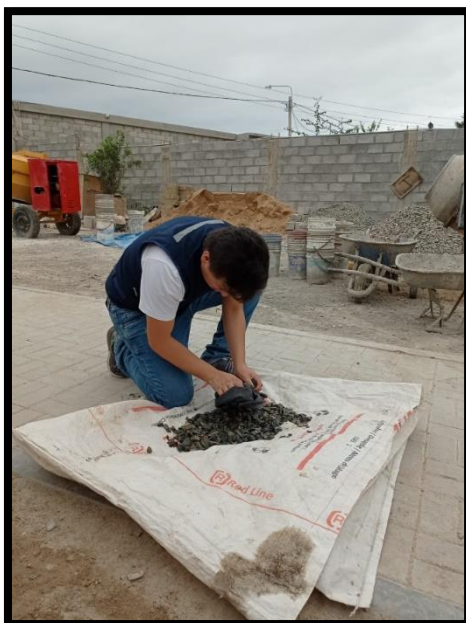
Figura N°26. Secado superficial del agregado grueso
