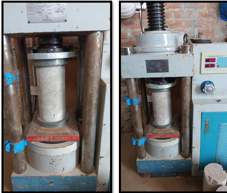
Figura N°42. Colocación de las probetas en compresora
