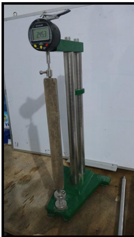
Figura N°48. Medición de la variación de longitud de la semana 2
