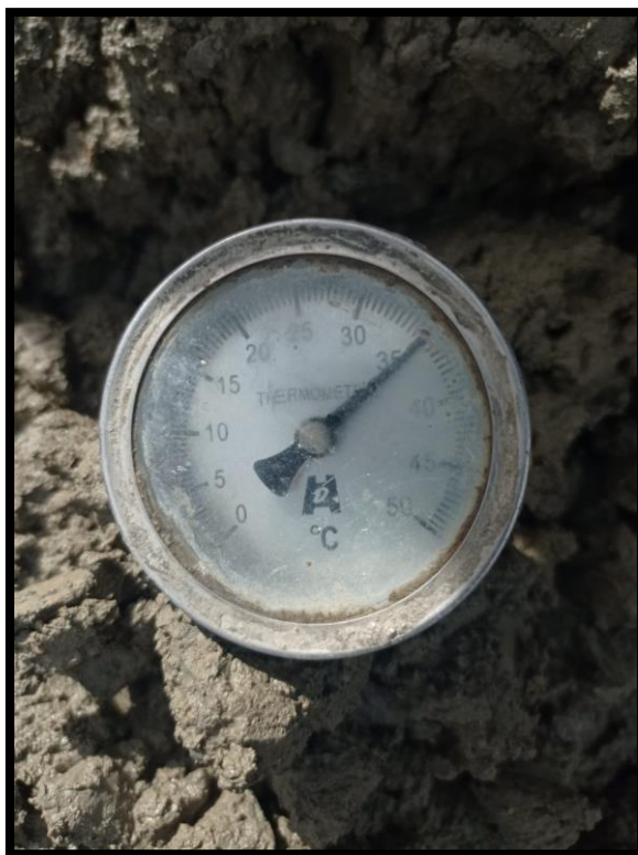
Figura N°39. Lectura de temperatura de muestra de concreto
