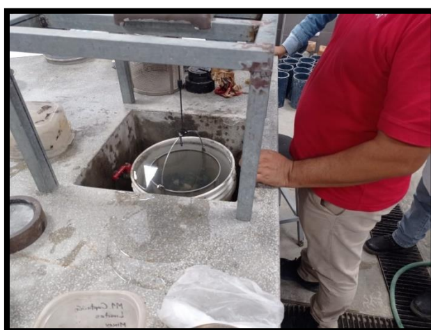
Figura N°27. Peso sumergido del agregado grueso
