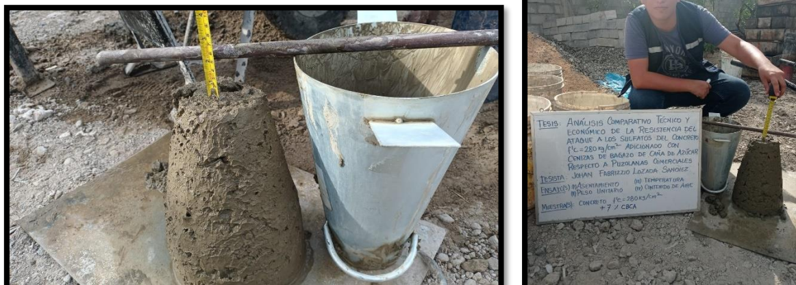
Figura N°37. Medida del Asentamiento de mezcla CBCA
