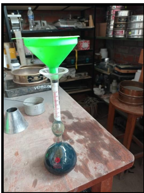
Figura N°8. Recipientes Preparados con Querosene y colocación de muestra CBCA
