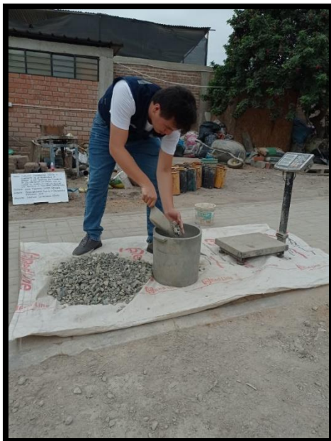
Figura N°29. Agregado Grueso Peso Unitario Seco Suelto
