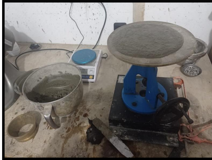
Figura N°43. Mesa de Flujo de mortero manual
