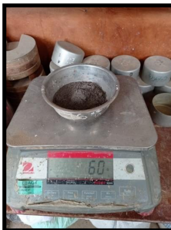
Figura N°10. Peso Humedo de CBCA
