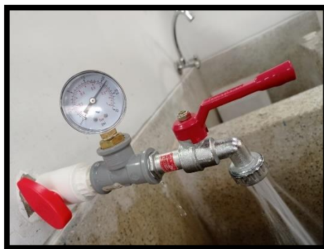
Figura N°20. Preparación del manómetro a 10 lb/in 2
