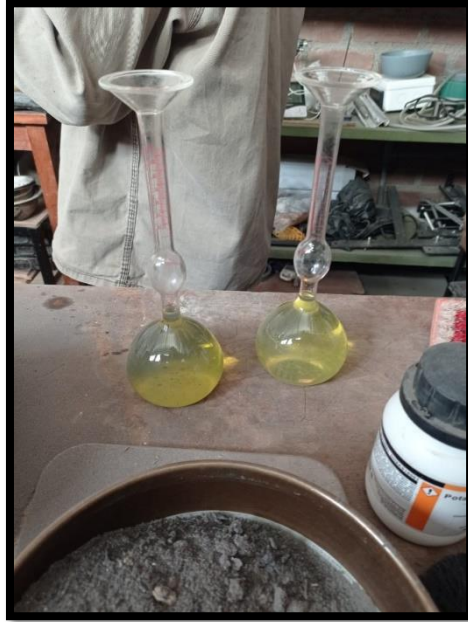
Figura N°15. Recipientes Preparados con Querosene y colocación de muestra Diatomita
