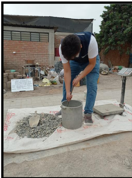
Figura N°30. Agregado Grueso Peso Unitario Seco Suelto
