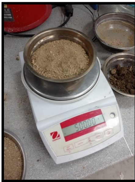
Figura N°32. Agregado Fino Superficialmente Seco
