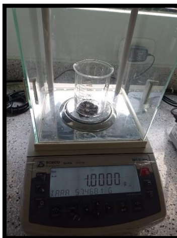
Figura N°5. Pesado de muestra con exactitud de 0.0005 g
