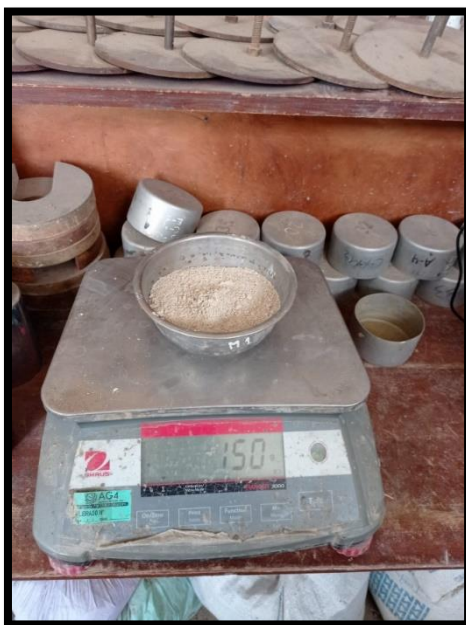
Figura N°17. Peso Humedo de Diatomita
