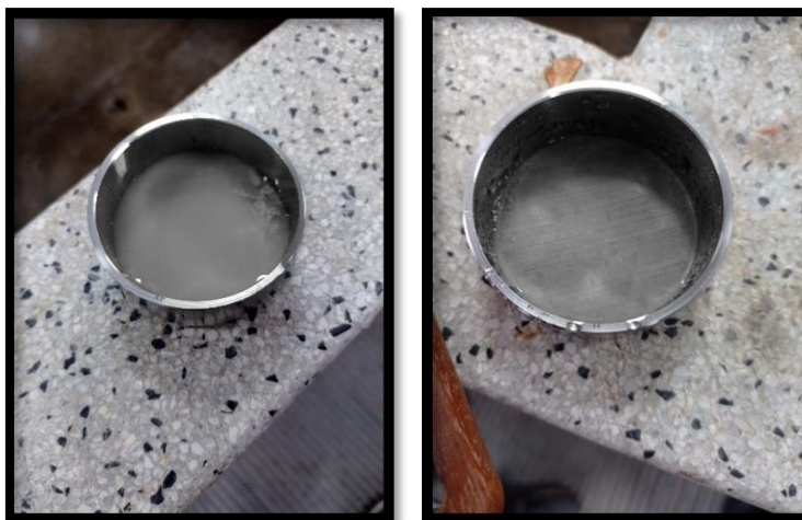
Figura N°21. Lavado de muestra restante Diatomita
