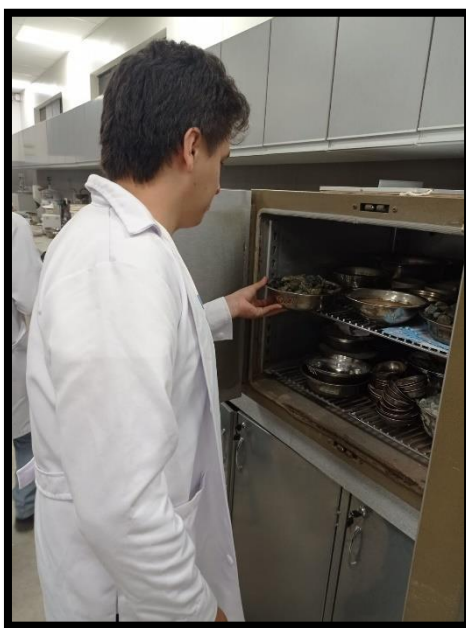
Figura N°28. Agregado Grueso Humedad
