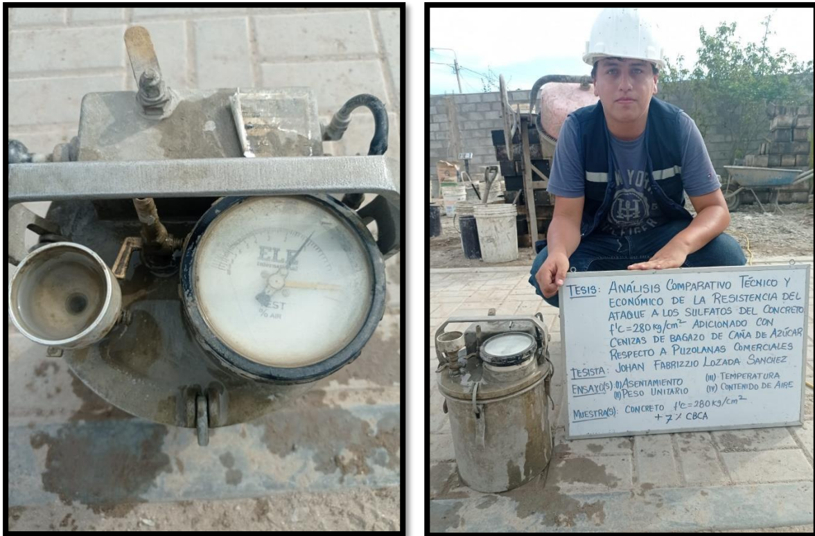
Figura N°40. Lectura del contenido de aire CBCA
