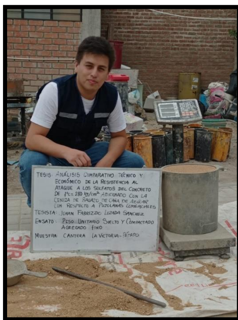
Figura N°35. Agregado Fino Peso Unitario Suelto Seco
