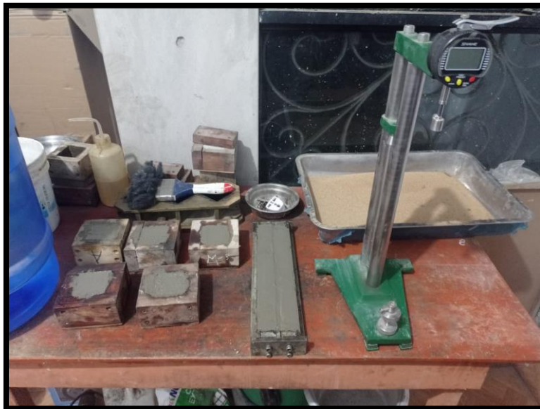
Figura N°44. Vaciado de las barras y cubos de control
