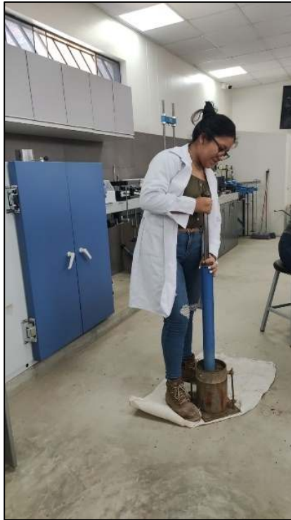
Ilustración 29: Compactando para CBR.
