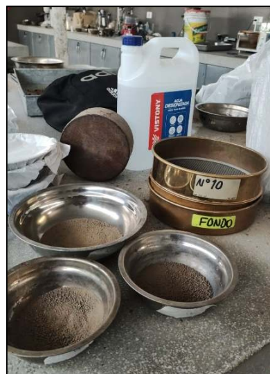
Ilustración 32: Pesamos 50gramos de la muestra natural.
