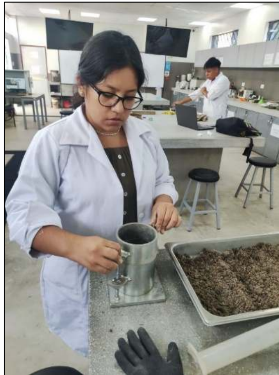
Ilustración 28: Compactando para el Ensayo de Proctor.
