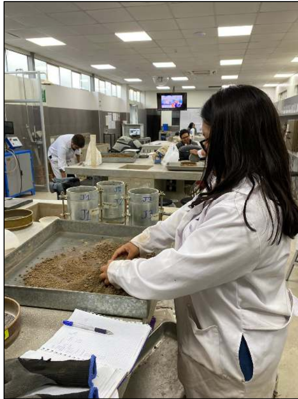
En proceso de la mezcla del suelo con el silicato de sodio.
