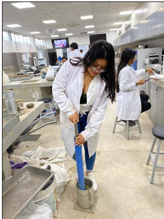
Ensayo de CBR.
