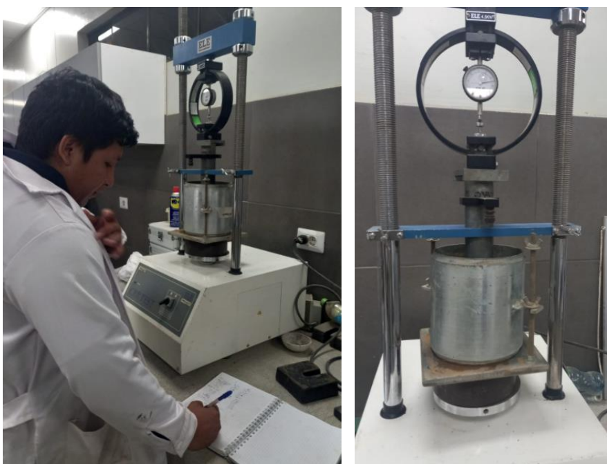
Ilustración 23: Ensayo de CBR y equipo de prensa de carga. Fuente: Elaboración Propia
