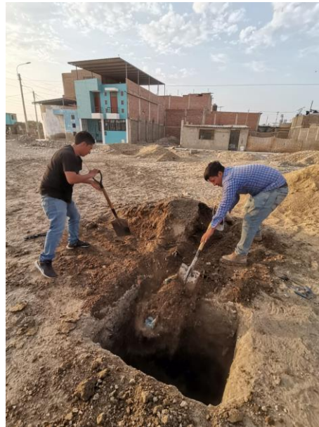
Anexo 1: Extracción de calicatas C-01, C-02 y C-03
