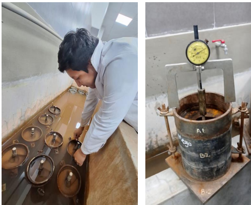
Ilustración 22: Ensayo de CBR y la fase inmersión Fuente: Elaboración Propia
