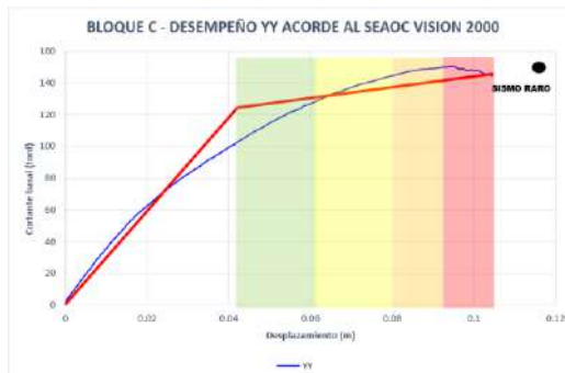
Ilustración 49. Nivel de desempeño YY del bloque C por SEAOC. Fuente: Propia
