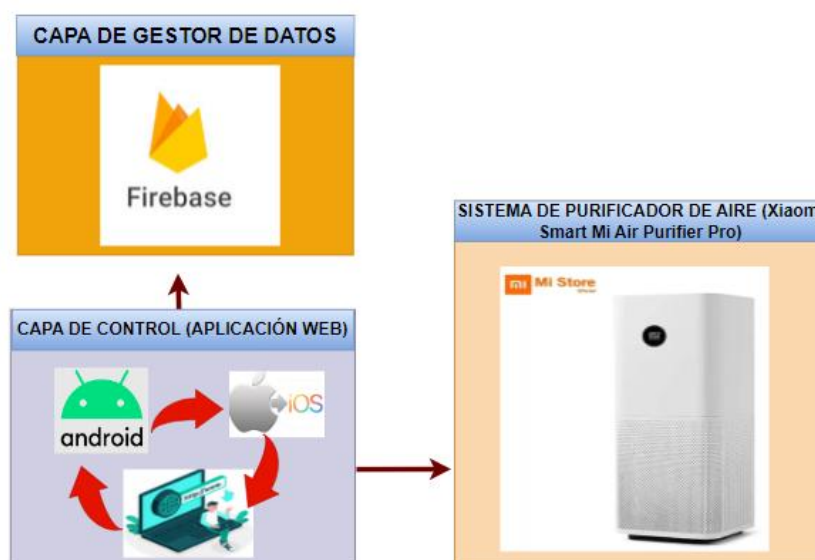
Figura 3: Arquitectura del sistema de purificación
