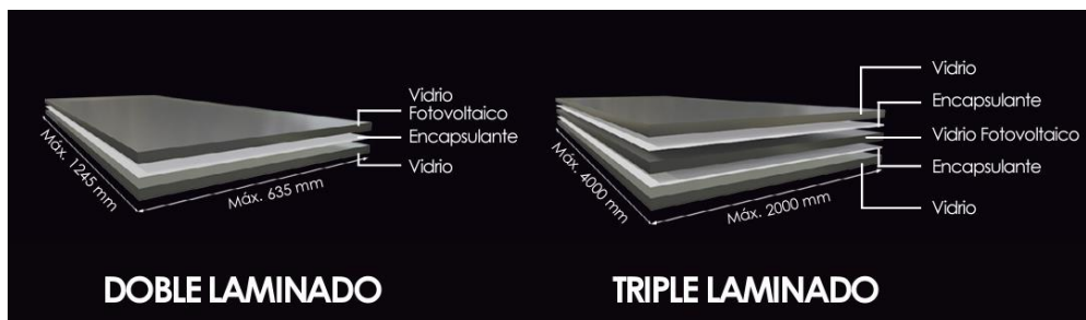
Figura 13. Tipo de laminado del Vidrio Solar Fotovoltaico [4].
