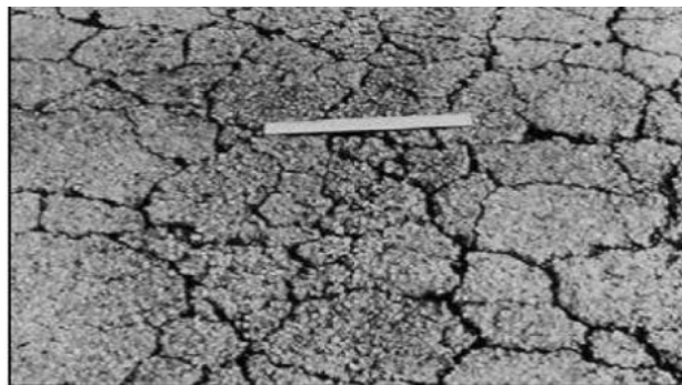
Ilustración 4. Piel de cocodrilo - Alta severidad.
