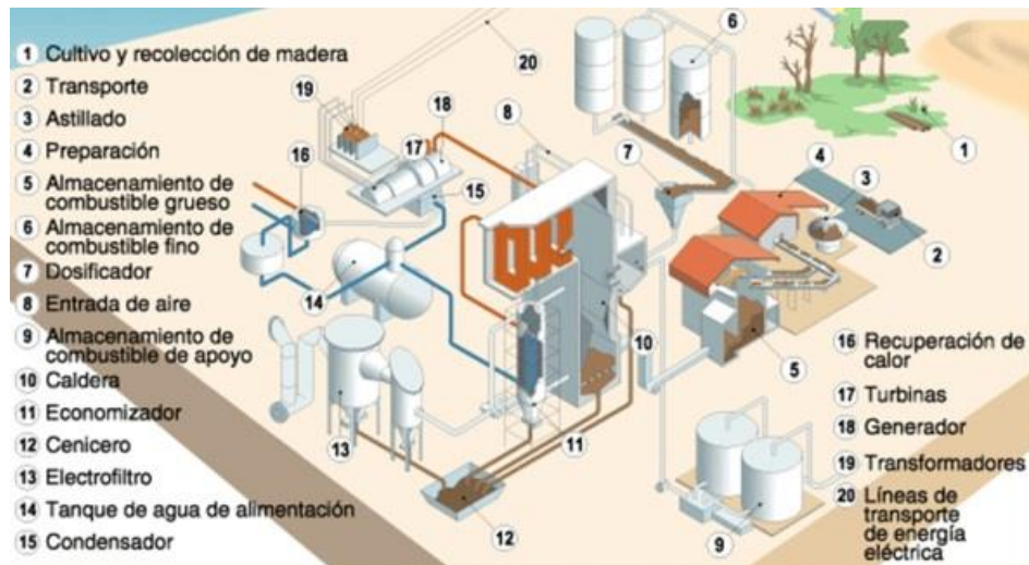
Figura 25 Central de biomasa.
