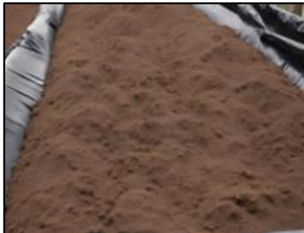
Ilustración 6: Secado de calicatas a temperatura ambiente.
