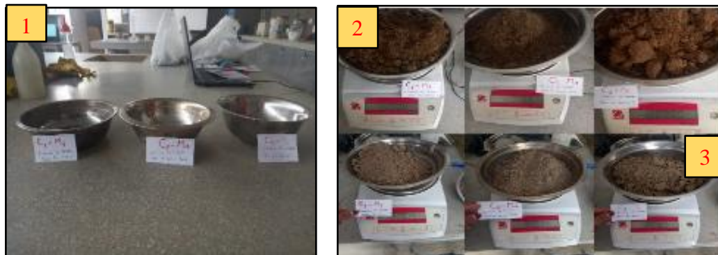
Ilustración 7: Ensayo de contenido de humedad
