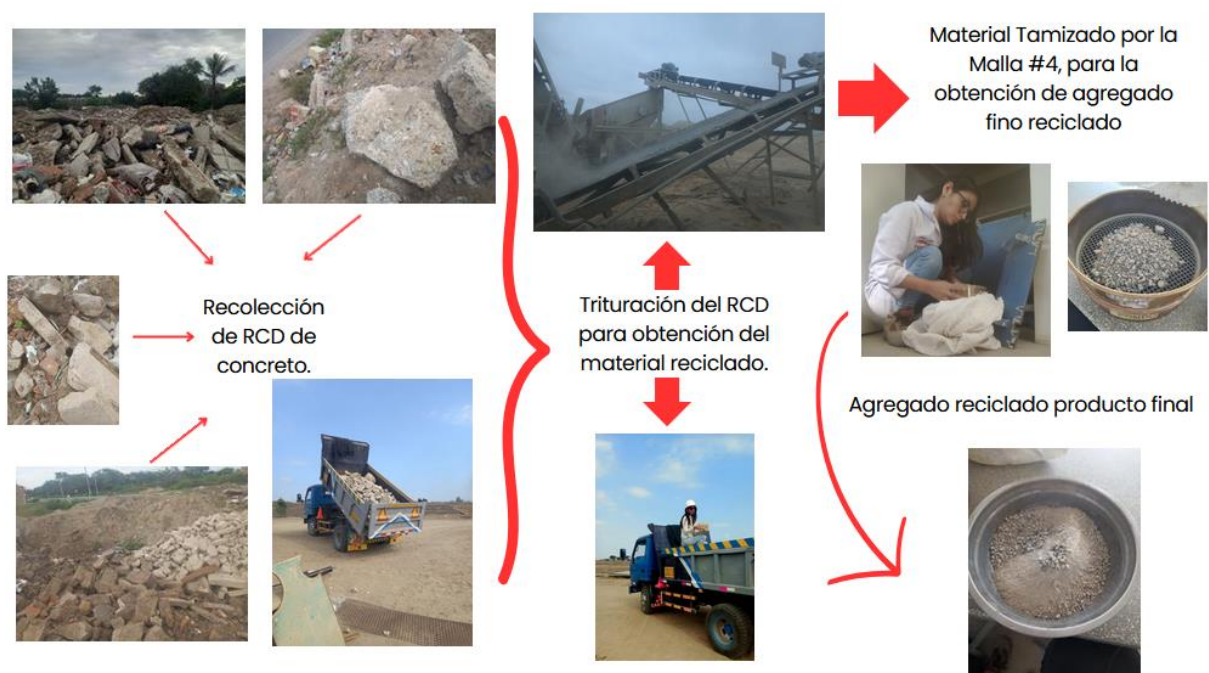
Ilustración 15: Proceso de trituración.
